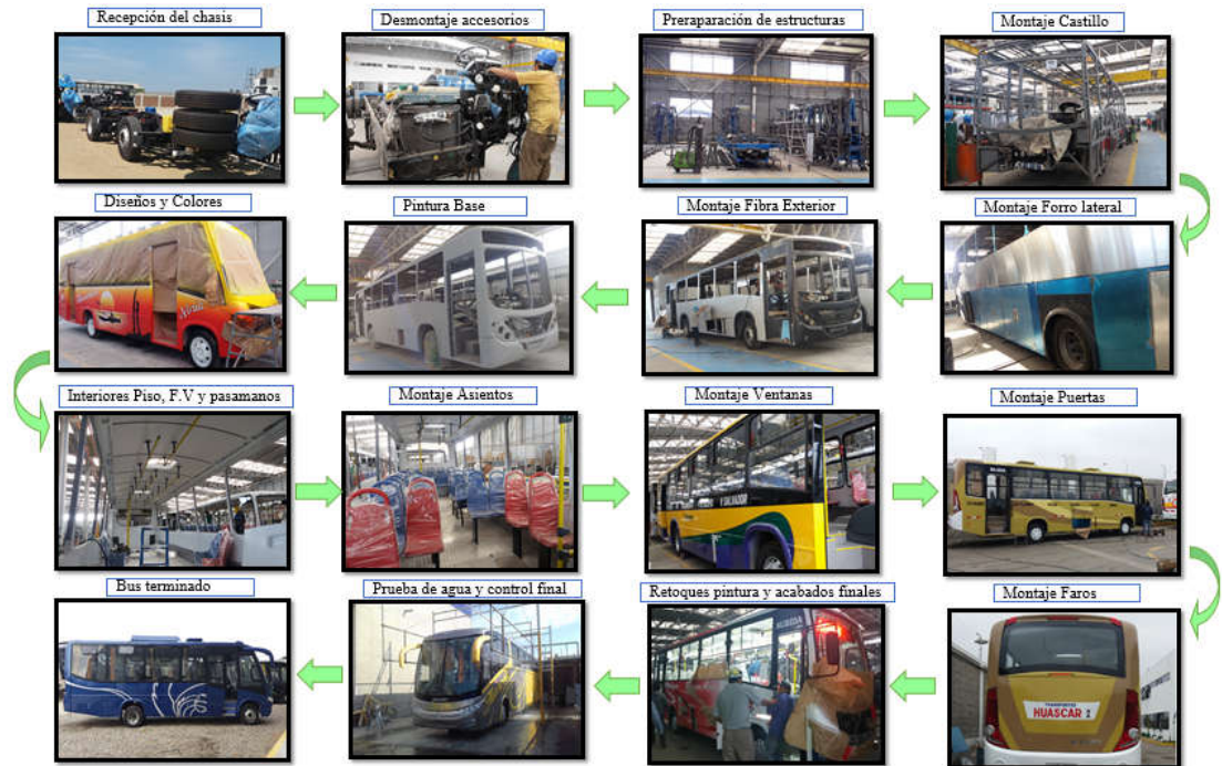
Diagrama N° 3: Proceso de fabricación de carrocerías Metalbus
