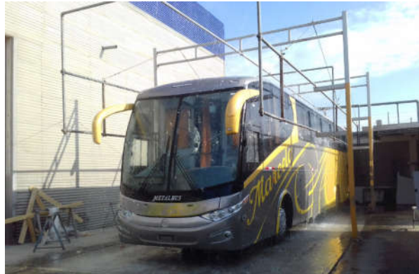
Imagen N° 17: Prueba de Agua
