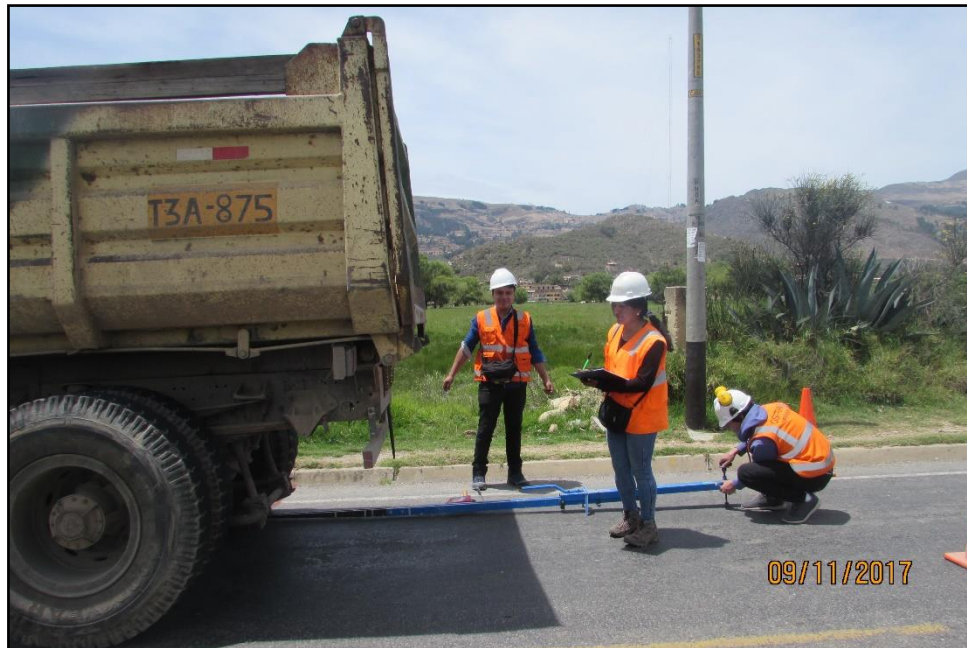
FIGURA N° 50: Se anotó la deflexión en la progresiva km 001 + 000 m.
