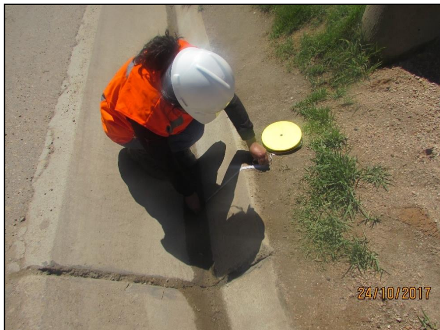
FIGURA N° 25: Toma de medidas de las dimensiones de cunetas.
