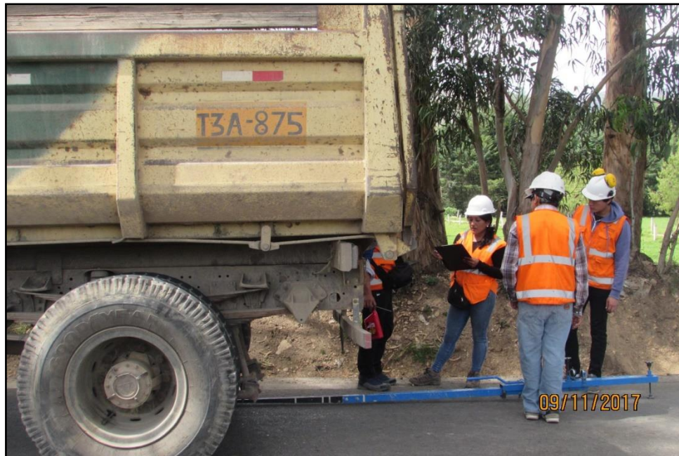
FIGURA N° 48: Se anotó la deflexión en la progresiva km 000 + 800 m.
