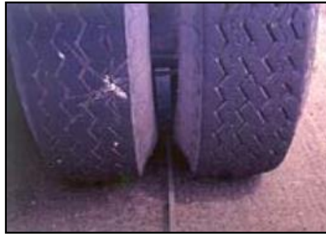
FIGURA N° 6: Colocación de la viga entre las llantas.
