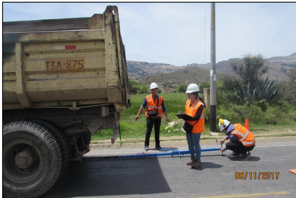
FIGURA N° 49: Se anotó la deflexión en la progresiva km 001 + 000 m.
