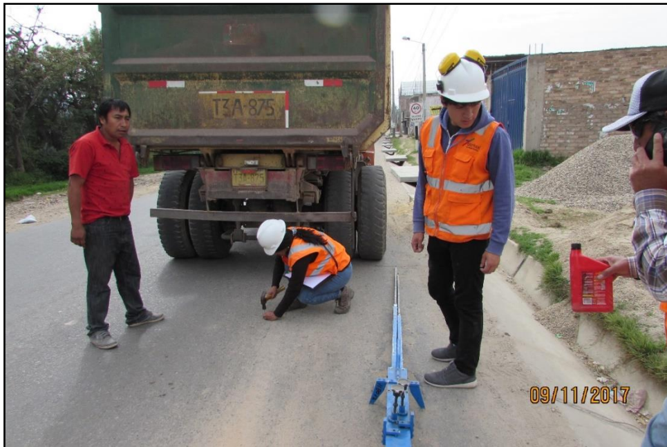
FIGURA N° 42: Agujero para medir la temperatura del pavimento.
