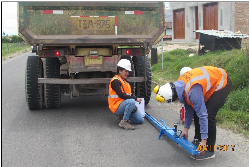
FIGURA N° 53: Se anotó la deflexión en la progresiva km 003 + 000 m.
