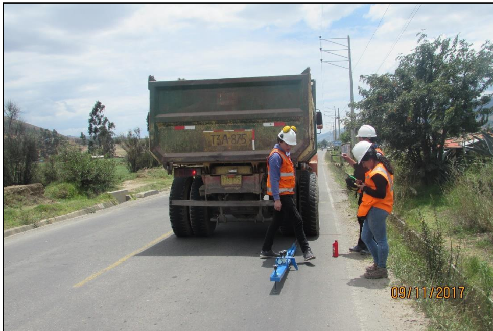
FIGURA N° 52: Se anotó la deflexión en la progresiva km 002 + 500 m.
