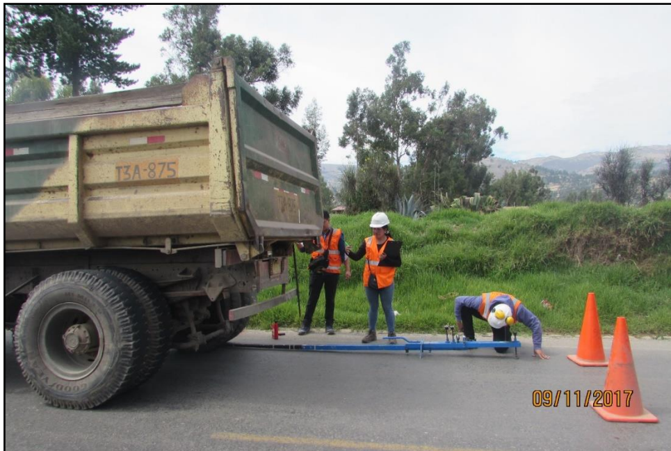
FIGURA N° 46: Se anotó la deflexión en la progresiva km 000 + 600 m.
