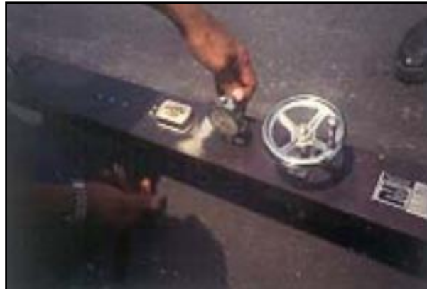
FIGURA N° 7: Nivelación de la viga Benkelman.
