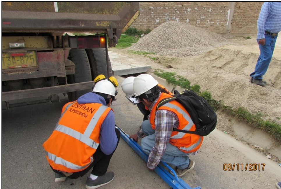
FIGURA N° 40: Colocando la viga en el eje del camión.
