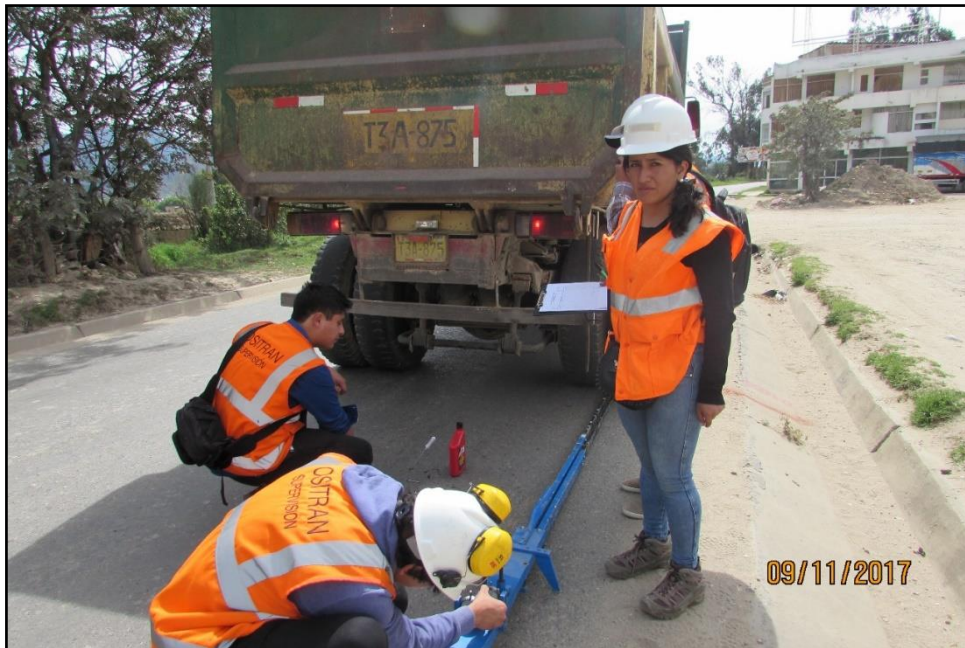
FIGURA N° 44: Se anotó la deflexión en la progresiva km 000 + 300 m.
