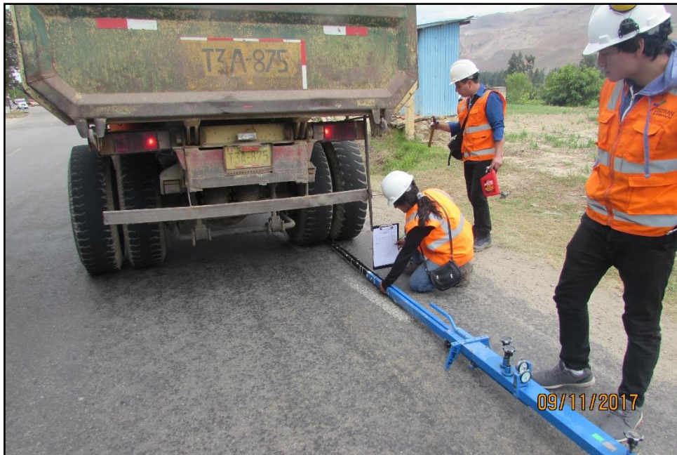
FIGURA N° 54: Se anotó la deflexión en la progresiva km 004 + 500 m.
