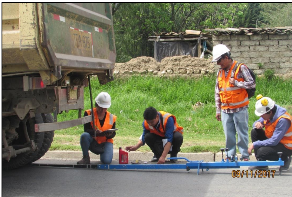
FIGURA N° 47: Se anotó la deflexión en la progresiva km 000 + 700 m.
