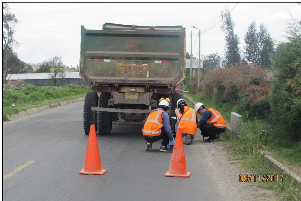
FIGURA N° 51: Se anotó la deflexión en la progresiva km 001 + 500 m.
