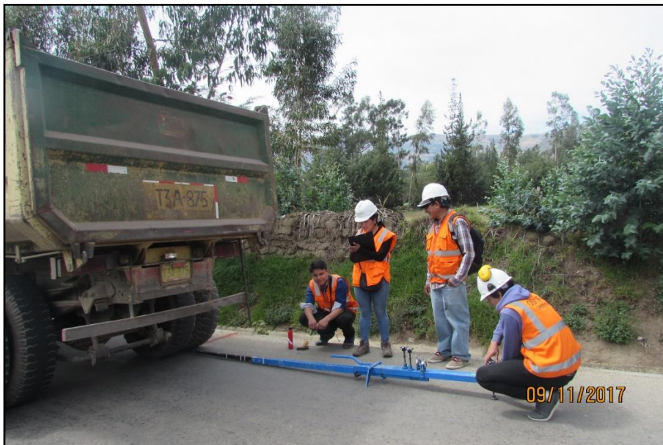
FIGURA N° 45: Se anotó la deflexión en la progresiva km 000 + 500 m.
