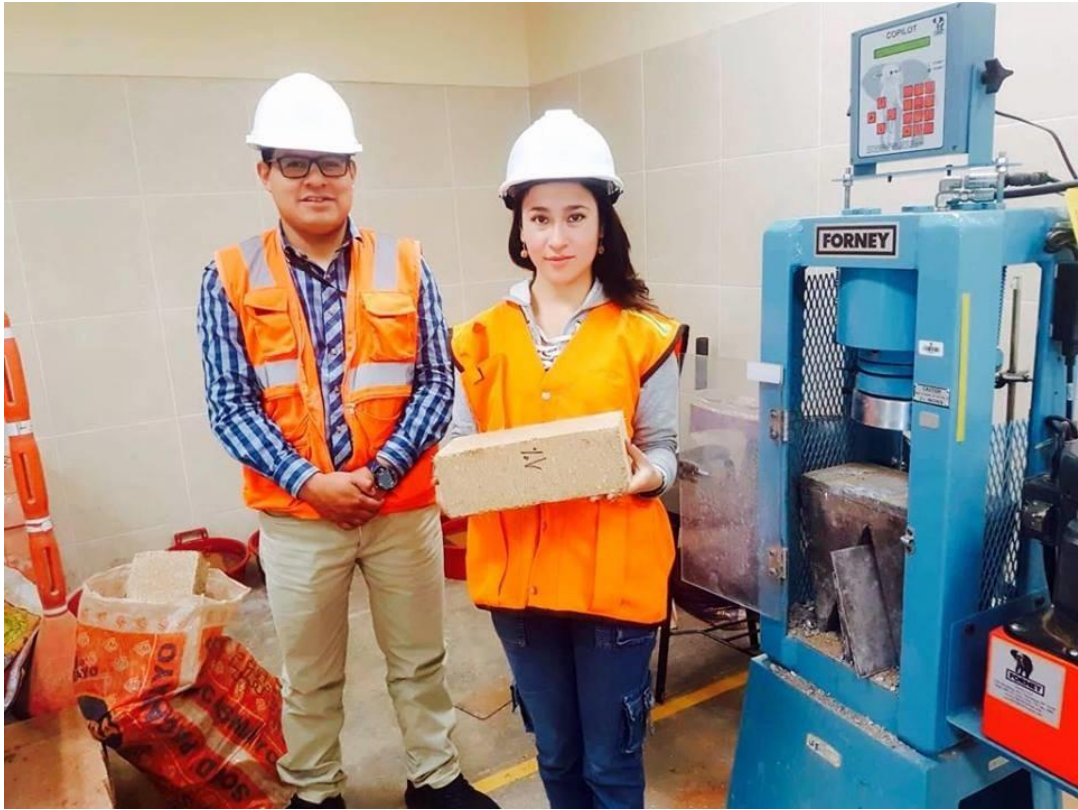
Imagen 42. Prueba de compresión de adobes compactados con fibra de maguey.
