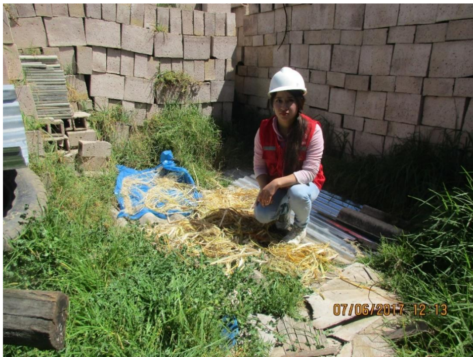
Imagen 33. Fibra de maguey lista para ser cortada e incorporada al adobe.
