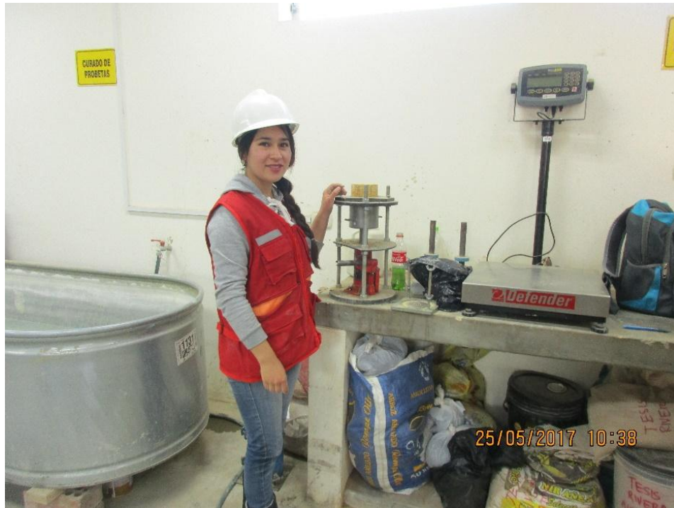
Imagen 27. Realización del ensayo de Proctor Modificado.
