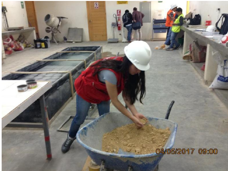
Imagen 11. Extracción de porción de material para la obtención de contenido de humedad.
