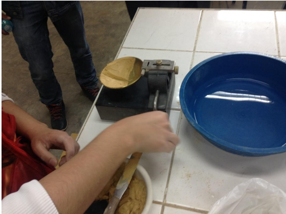
Imagen 17. Elaboración de ensayo de límite líquido.
