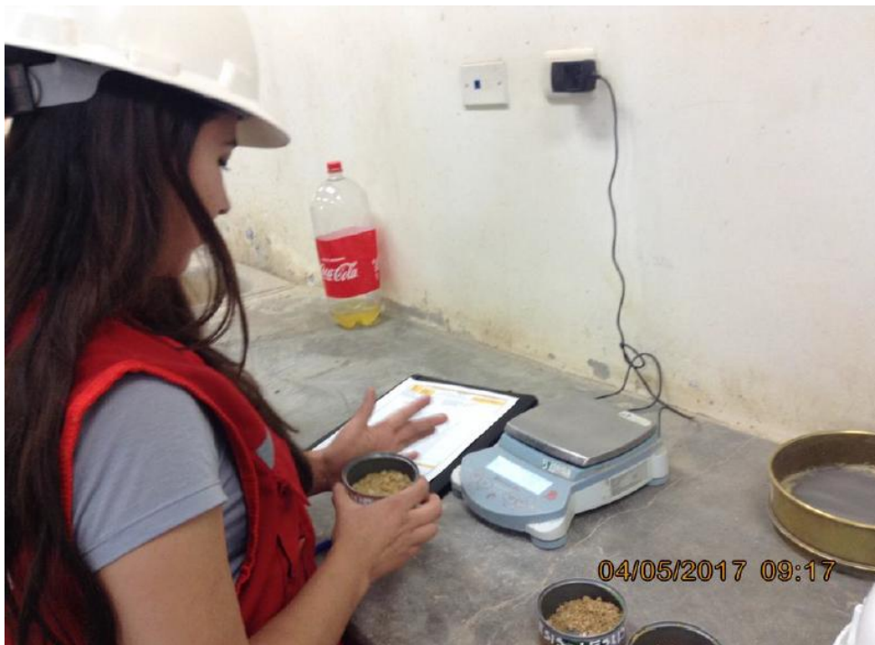
Imagen 12. Realización del ensayo de contenido de humedad.
