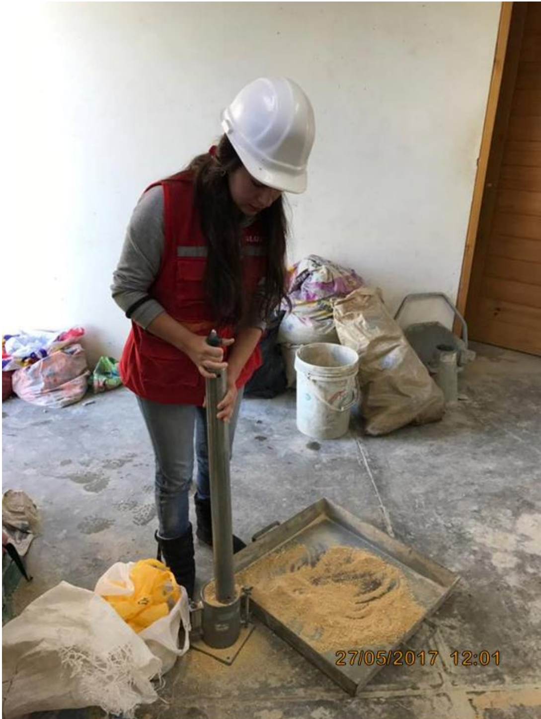
Imagen 30. Realización del ensayo de Proctor Modificado con adición de fibra.
