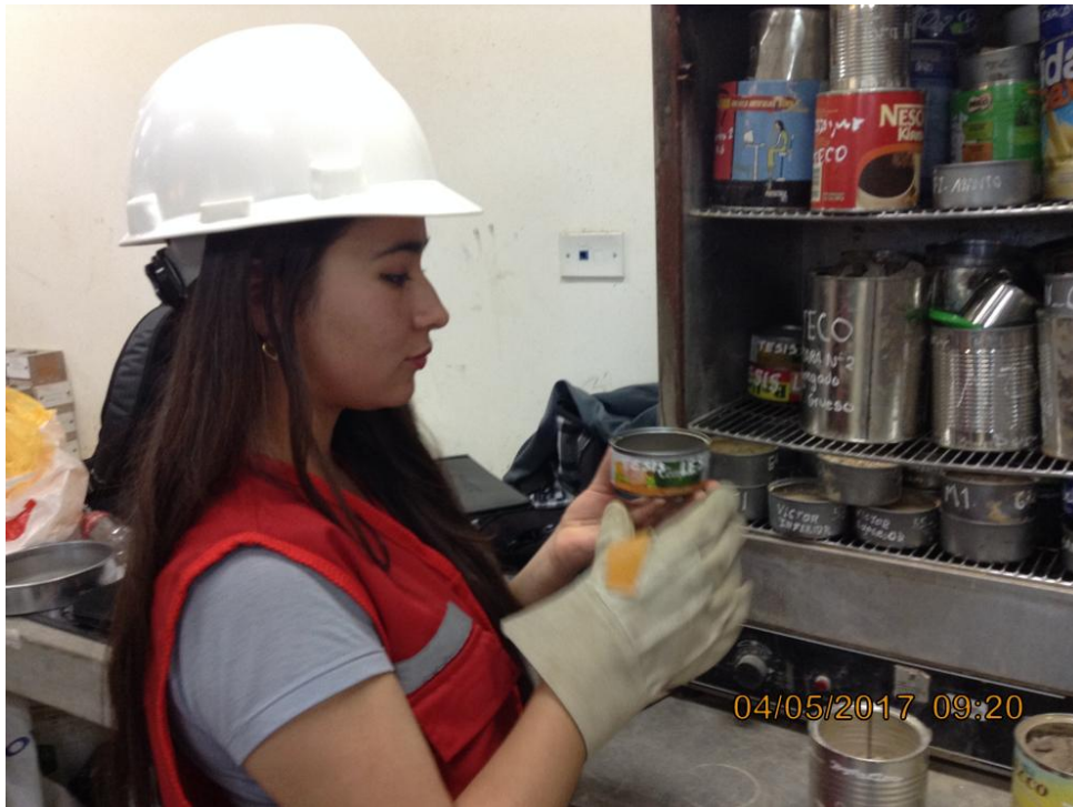
Imagen 13. Colocación de muestra húmeda en horno del laboratorio.
