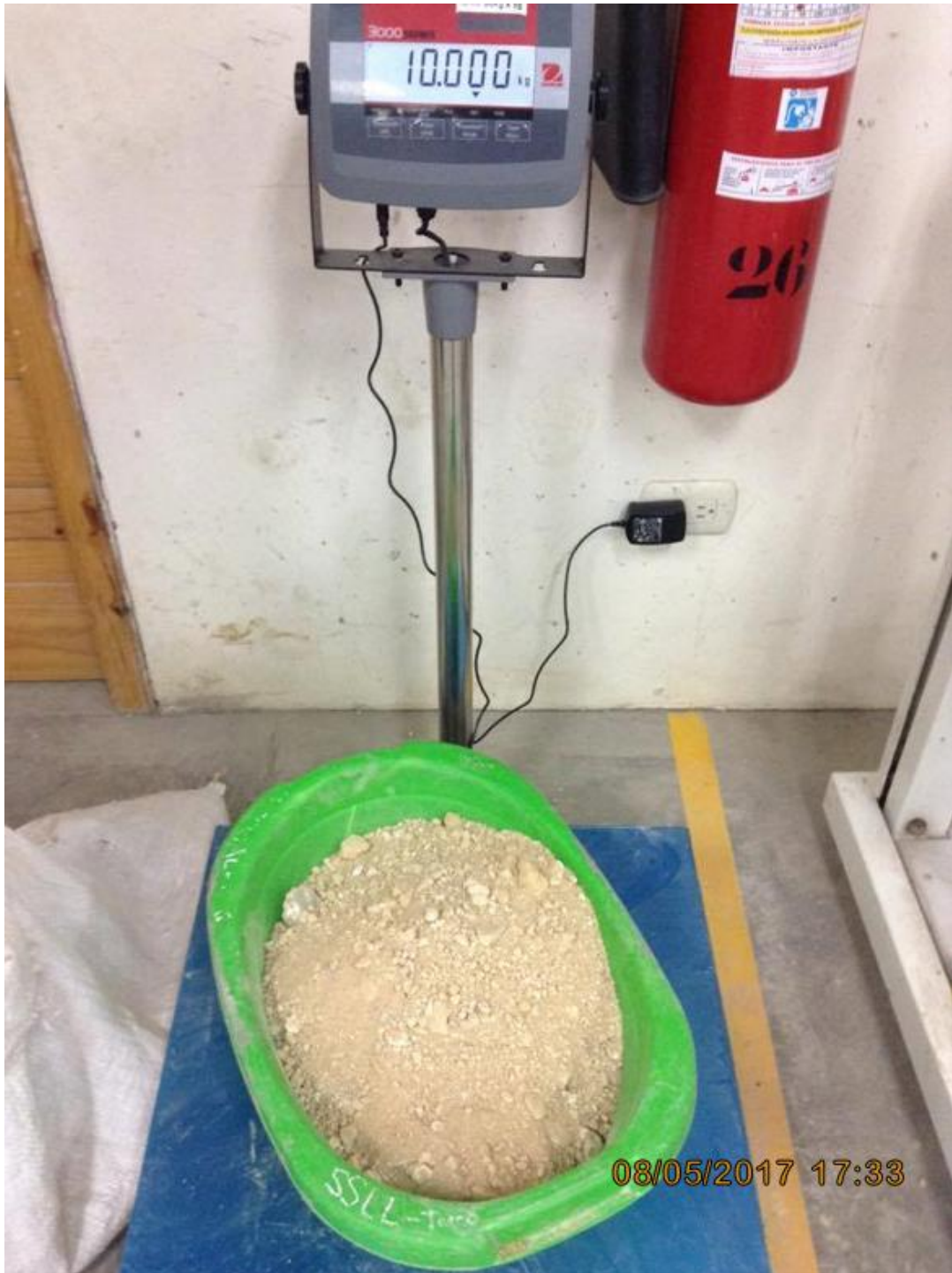
Imagen 21. Peso de material para la realización del ensayo de granulometría.
