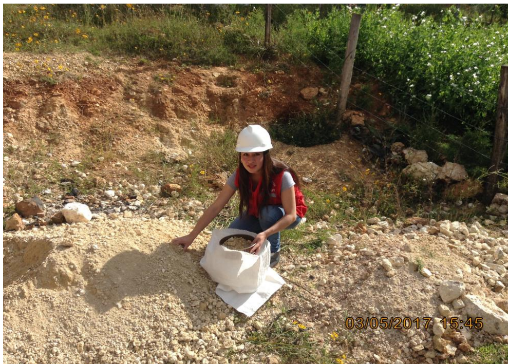
Imagen 8. Extracción de material de la calicata habilitada para cantera.
