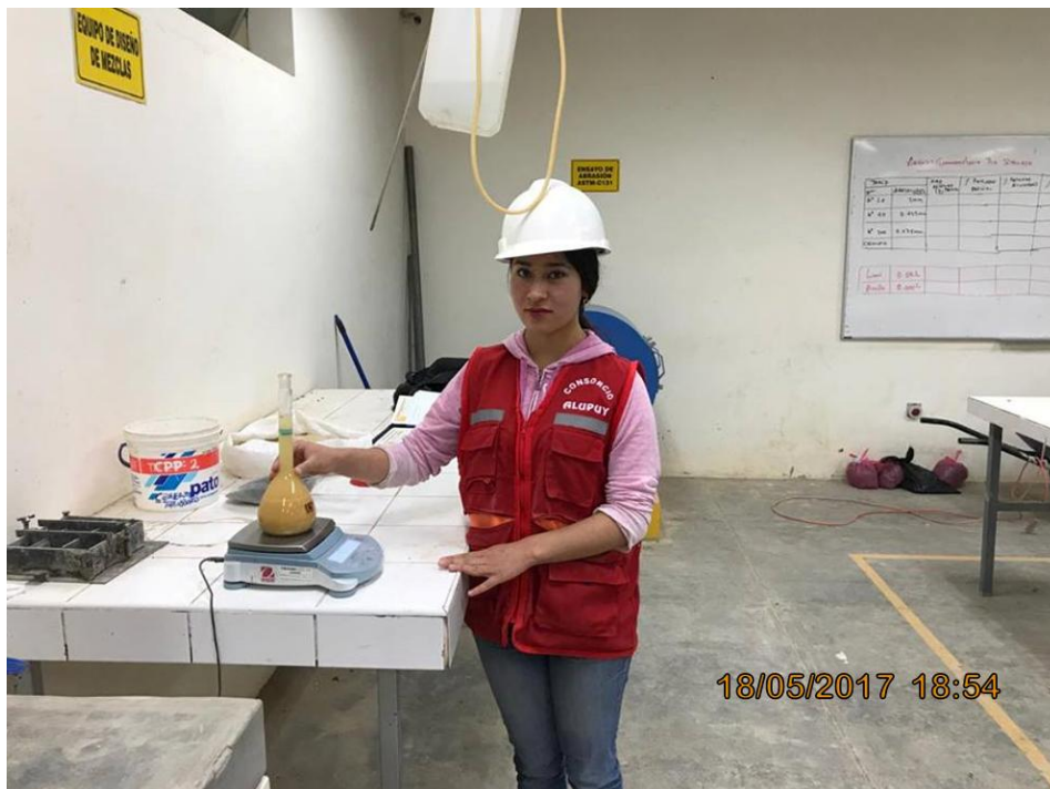
Imagen 23. Realización de ensayo de peso específico.
