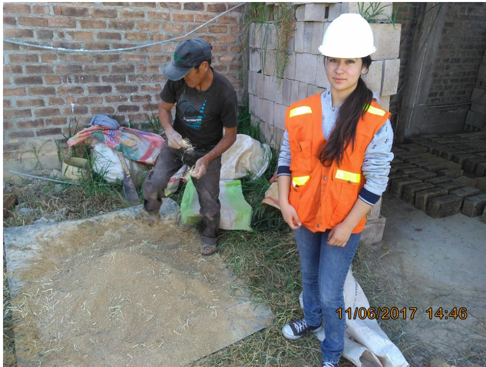
Imagen 36. Elaboración de adobes con adición de fibra de maguey.
