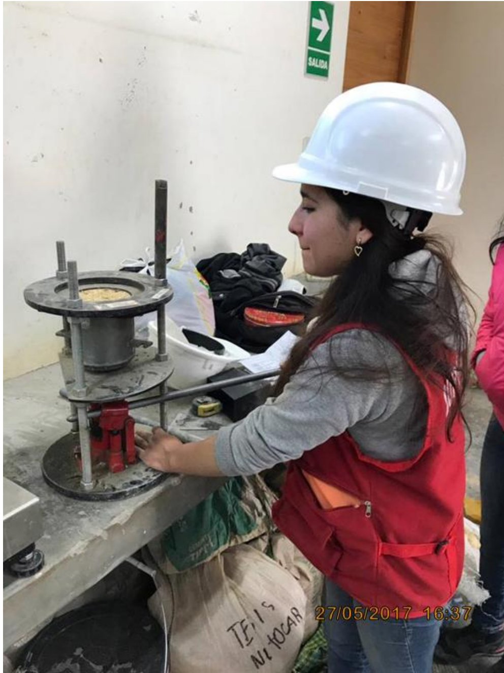
Imagen 31. Realización del ensayo de Proctor Modificado.
