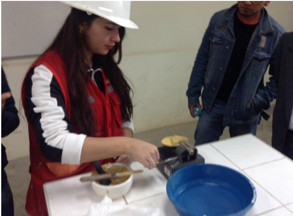
Imagen 16. Elaboración de ensayo de límite líquido.
