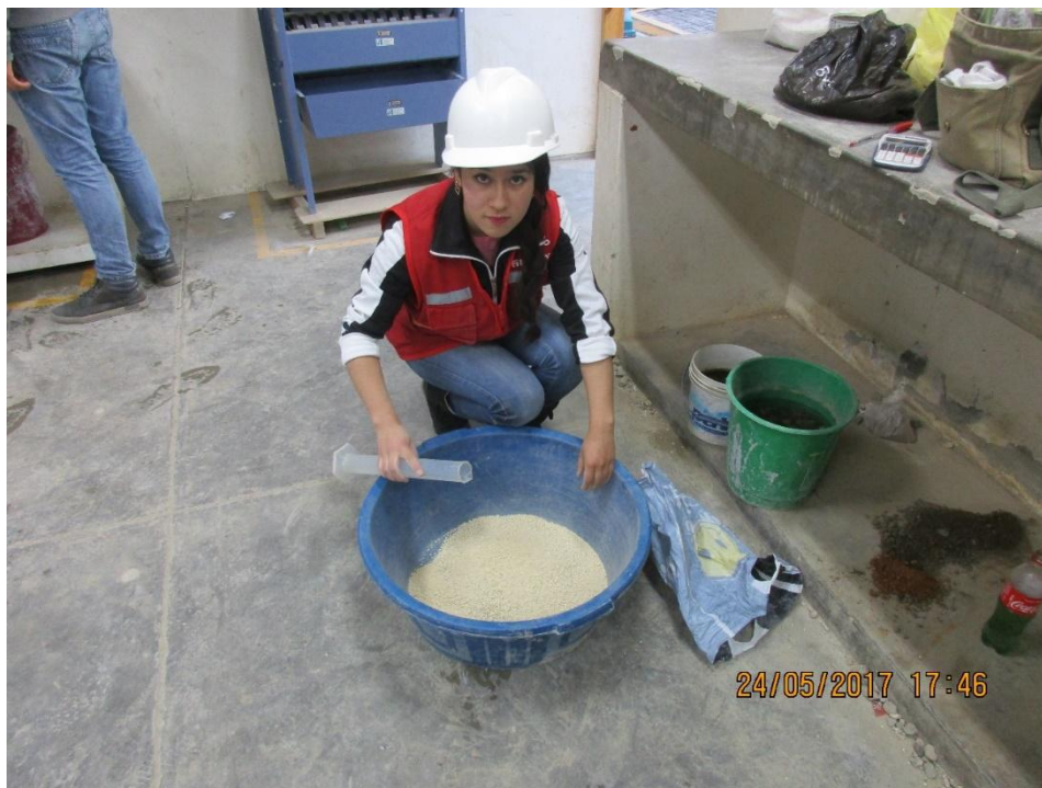
Imagen 26. Adición de agua al material para la elaboración del ensayo de Proctor Modificado.
