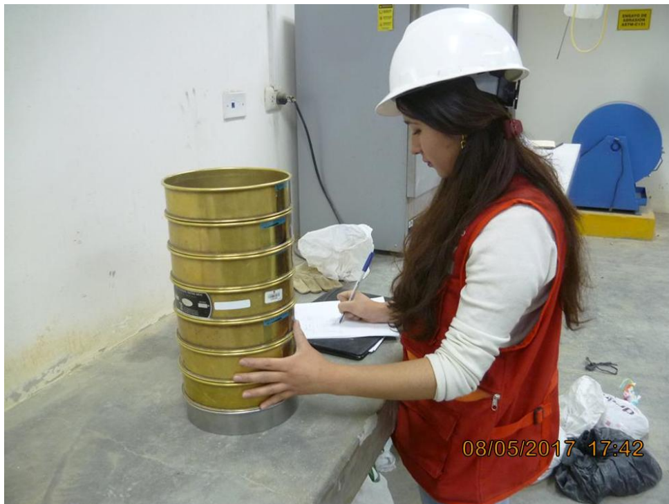
Imagen 20. Realización de ensayo de granulometría en seco.
