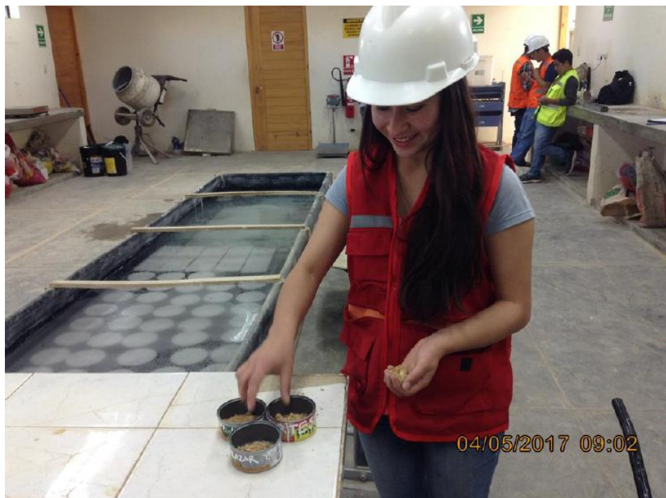
Imagen 10. Extracción de porción de material para la obtención de contenido de humedad.
