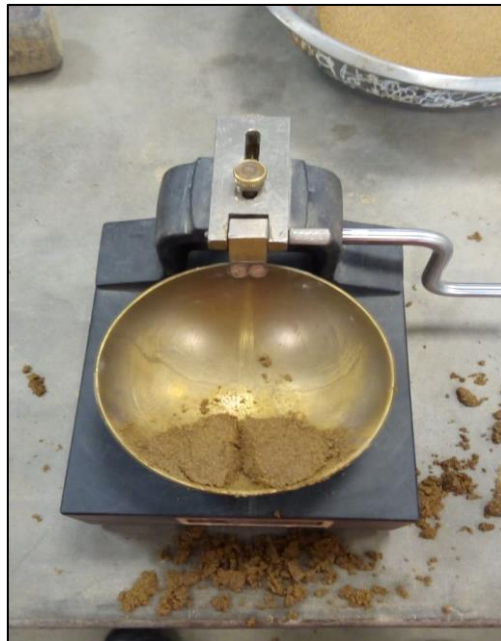
Figura N° 77. Ensayo de Limite líquido
