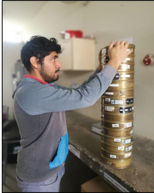
Figura N° 76. Ensayo de granulometría
