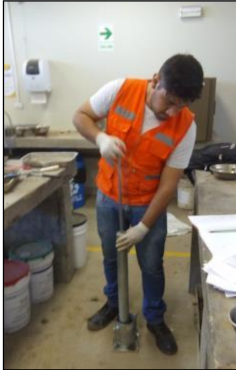
Figura N° 78. Compactación del Ensayo de Proctor modificado
