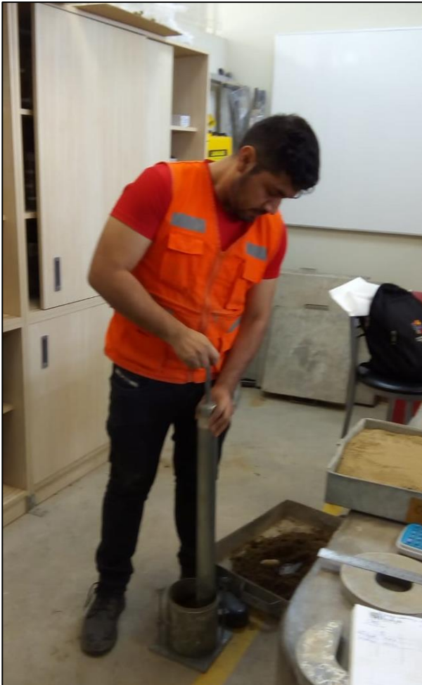
Figura N° 80. Compactación para el ensayo del CBR
