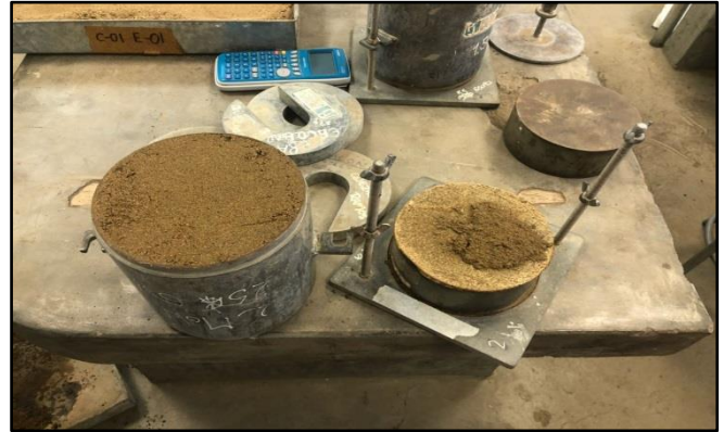
Figura N° 82. Enrasado luego de la compactación
