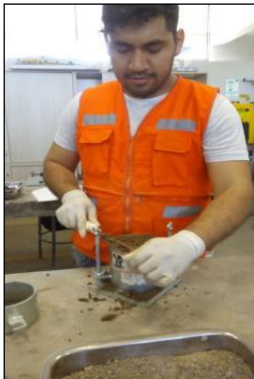
Figura N° 79. Enrase luego de la compactación del Ensayo de Proctor modificado
