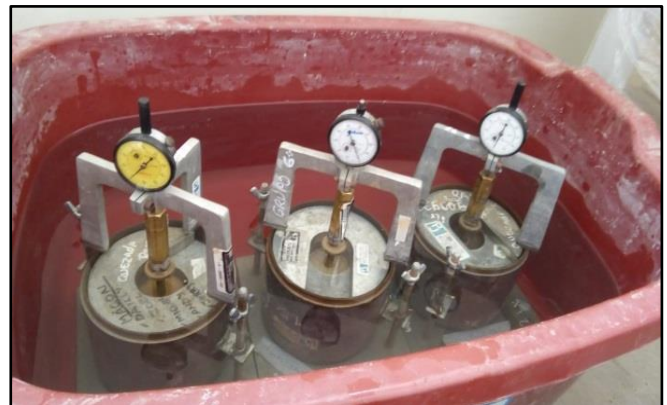
Figura N° 81. Medición del hinchamiento de las muestras sumergidas en una tina de agua durante 4 días
