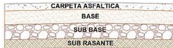
Figura N° 1. Estructura del pavimento flexible
