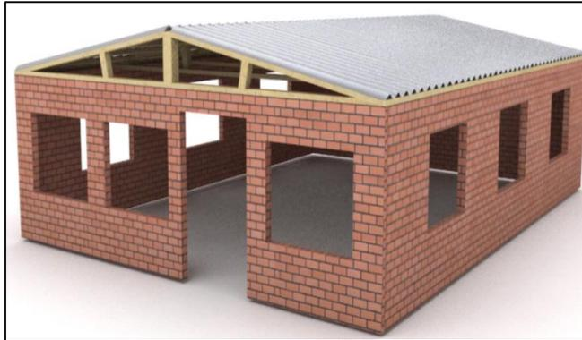
**Figura N° 13:** Cubierta correctamente instalada que garantiza un comportamiento de diafragma rígido.
