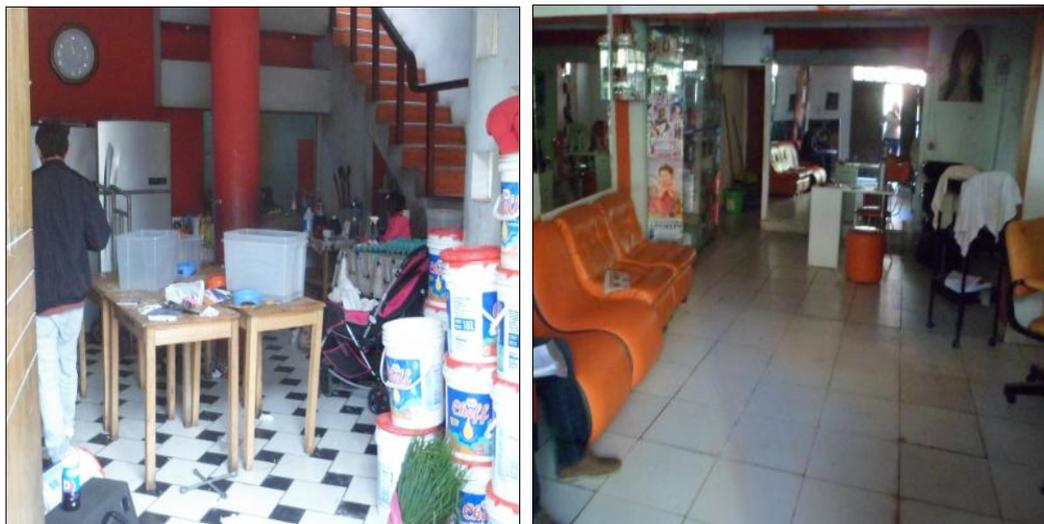
**Figura N° 29:** Viviendas utilizadas como negocio, retiran los muros transversales para conseguir espacio y le quitan densidad de muros portantes a la estructura.
