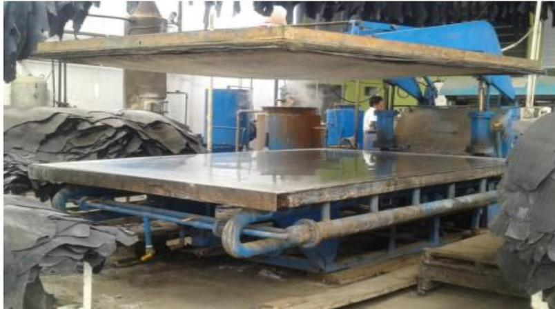
*Figura 20.* Máquina de Secado al Vacío.
