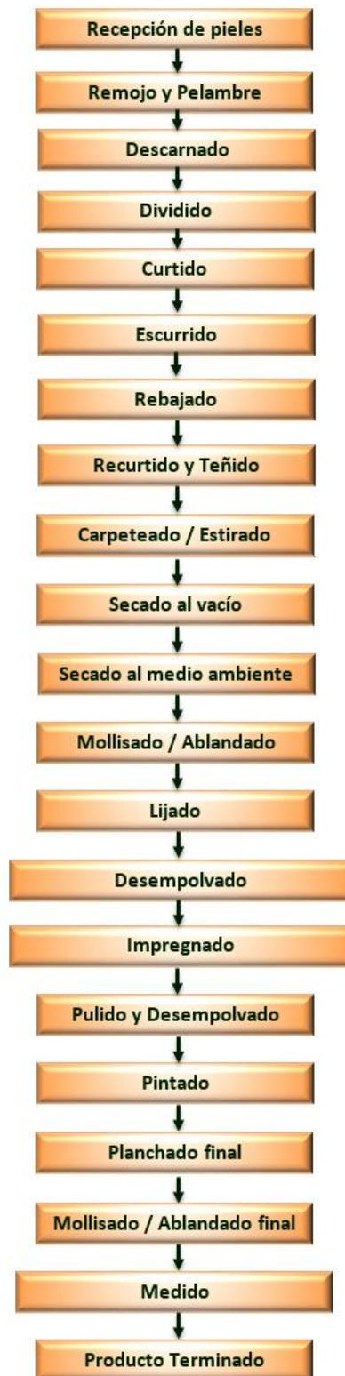
Figura 24. Diagrama de Bloques del Proceso de Producción.
