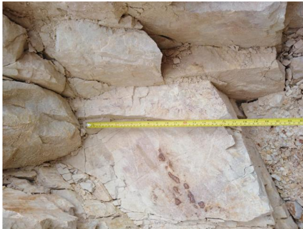
Fig. 13: Midiendo la Longitud de las discontinuidades, zona 2.
