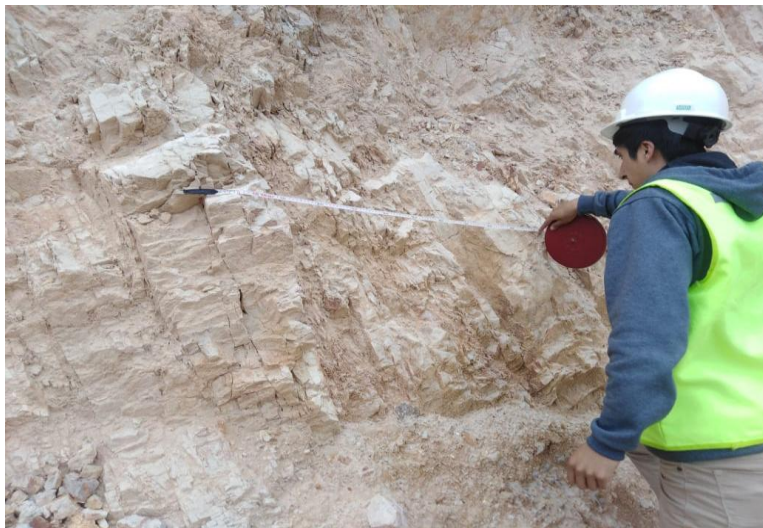
Fig. 10: Midiendo las distancias del espaciado discontinuidades, zona 2.
