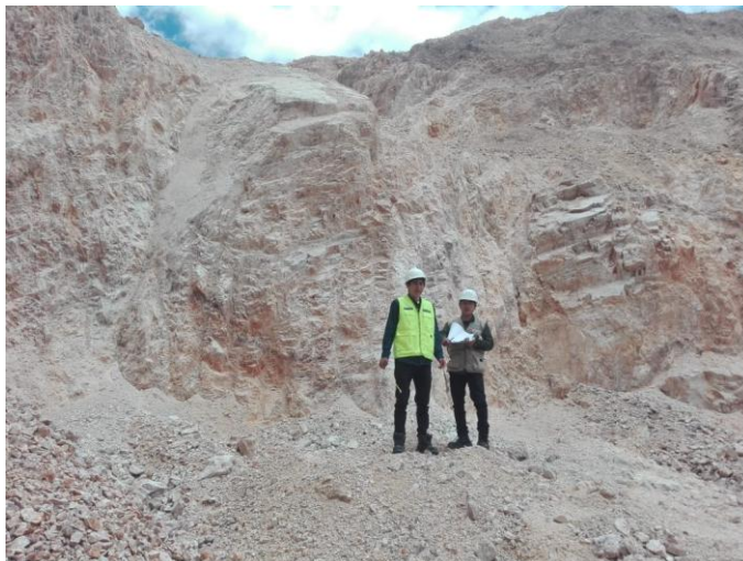
Fig. 31: El eje de la excavación es perpendicular a la dirección de los estratos, zona 1.
