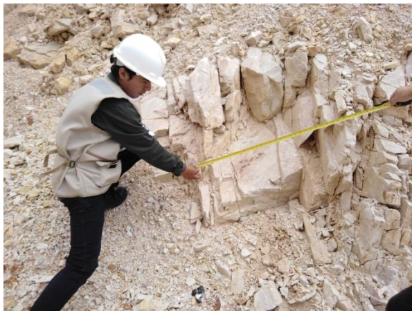
Fig. 12: Midiendo la Longitud de las discontinuidades, zona 1.
