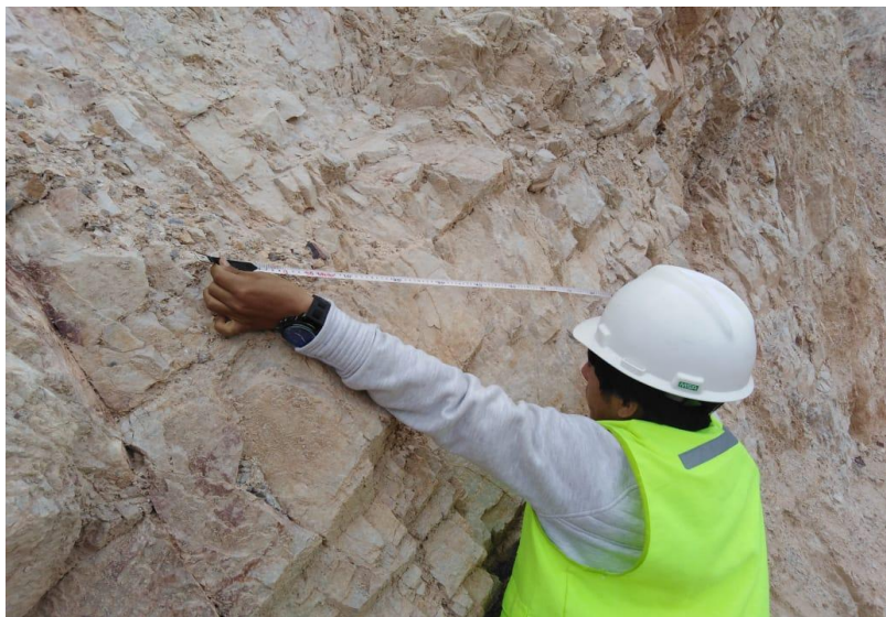
Fig. 9: Midiendo las distancias del espaciado discontinuidades, zona 1.
