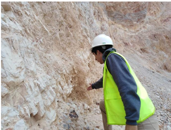
Fig. 27: Observando la humedad del macizo, zona 1.
