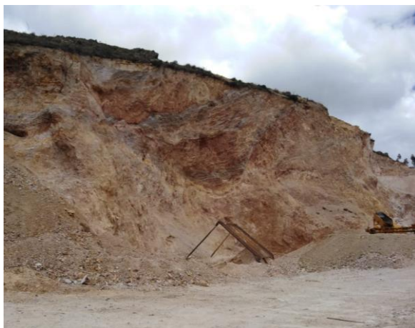
Fig. 32: El eje de la excavación es perpendicular a la dirección de los estratos, zona 2.
