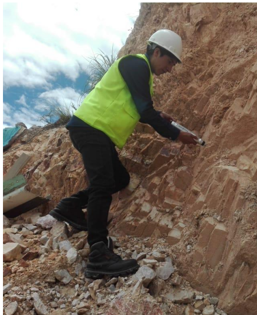
Fig. 5: Obtenido con Martillo Schmidt 16 Mpa., zona 3.
