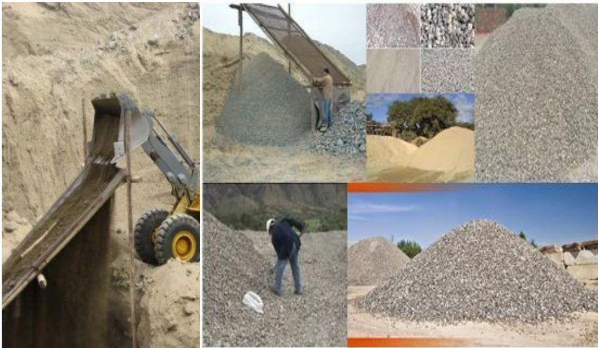
Fig. 50: Proceso de Cernidores de material en la Cantera Agocucho.
