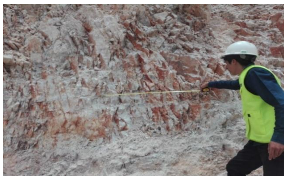
Fig. 6: Midiendo y sumando el largo de todos los trozos, zona 1.
