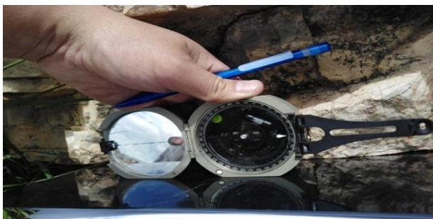
Fig. 30: Sacando el rumbo y buzamiento, zona 1.
