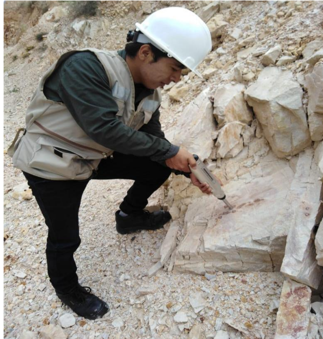
Fig. 4: Obtenido con Martillo de Schmidt 14 Mpa, zona 1
