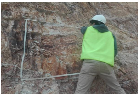
Fig. 8: Midiendo y sumando el largo de todos los trozos, zona 3.
