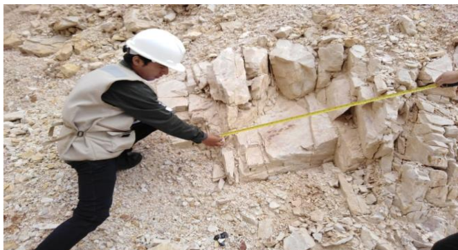
Fig. 7: Midiendo y sumando el largo de todos los trozos, zona 2.
