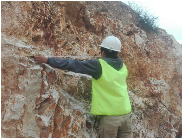
Fig. 11: Midiendo las distancias del espaciado discontinuidades, zona 3.
