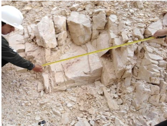
Fig. 14: Midiendo la Longitud de las discontinuidades, zona 3.
