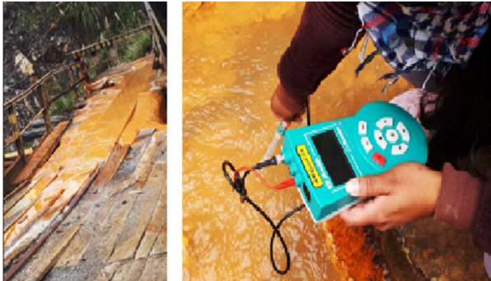
Foto 5 Tesistas midiendo el pH del DAM en la bocamina Fuente: Elaboración propia.
