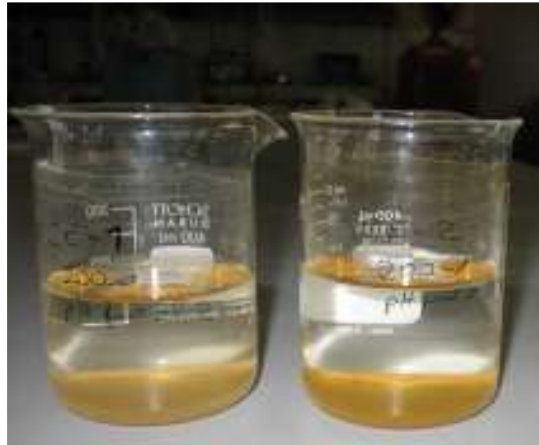
Foto 7 Muestras del agua neutralizadas por método químico con lechada de cal al 10% Fuente: Elaboración propia.
