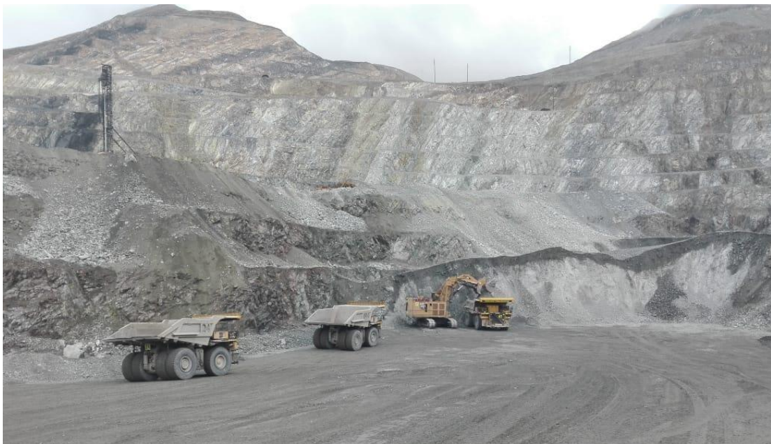
Muestra los camiones en cola y la aplicación del procedimiento alternativo (carguío por el lado derecho).
