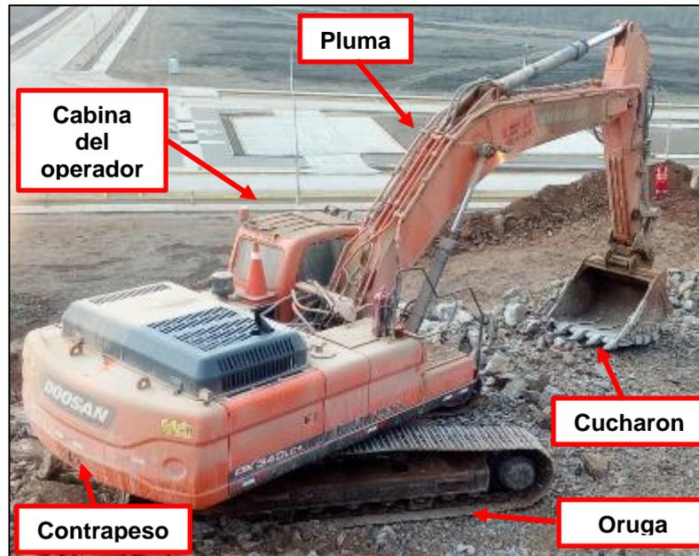
**Figura 5.** Partes básicas de una excavadora sobre oruga
