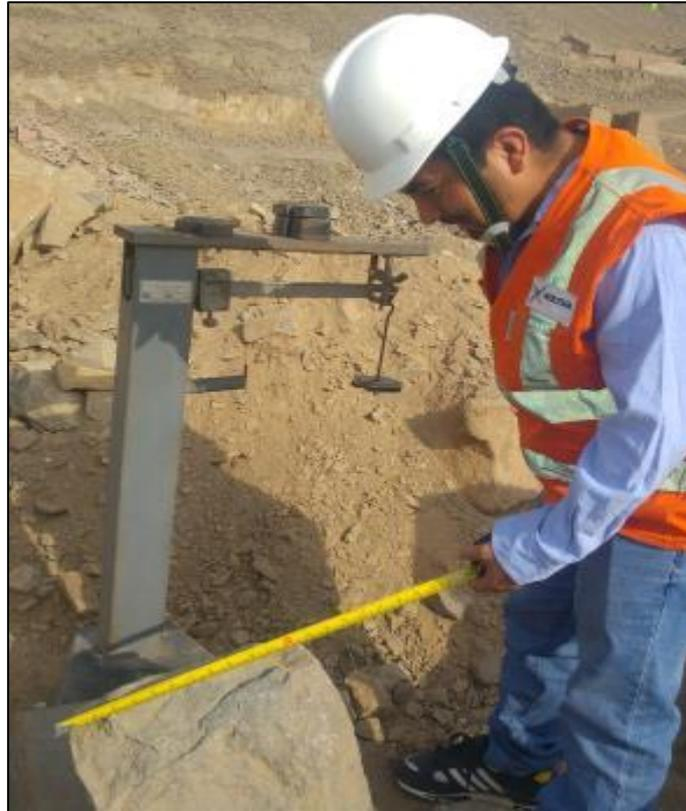
**Figura 24.** *Medición y pesaje de piedras que entran en un volquete.*
