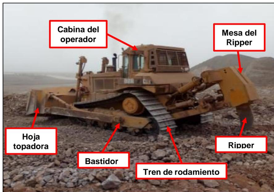
**Figura 14.** Partes básicas de un tractor sobre oruga
