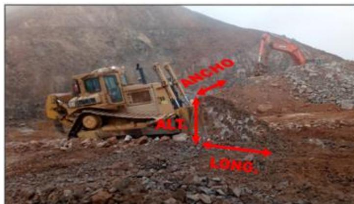
**Figura 27.** Medición del material acarreado por el tractor oruga
