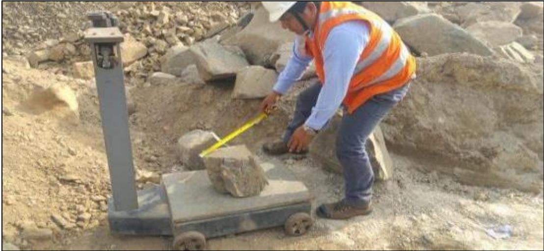
*Figura 20. Pesaje y medida de rocas que carga la excavadora para colmar un volquete.*
