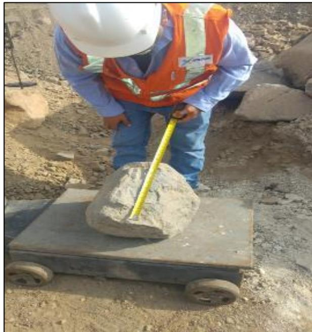
**Figura 21.** *Medición de rocas que entran en una excavadora.*
