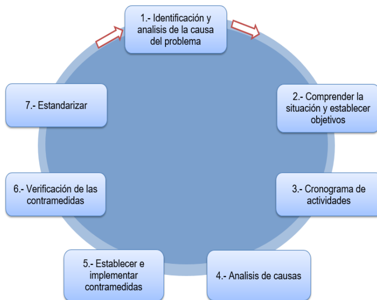
Figura II.6 Diagrama de los 7 pasos para la solución de problemas Elaboración propia
