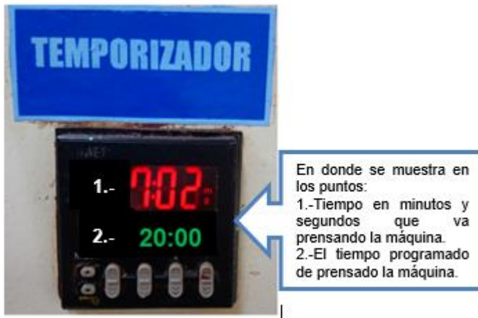
Figura III.34 Tiempos de prensado antes de la mejora Elaboración propia
