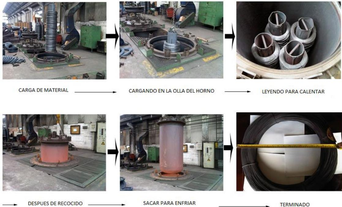
Figura 4 Proceso de recocido de láminas o alambres (*Fuente: Alibaba.com.*)
