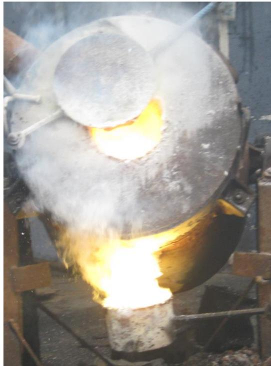
Figura 1. Horno de fundición (Fuente: Propia)
