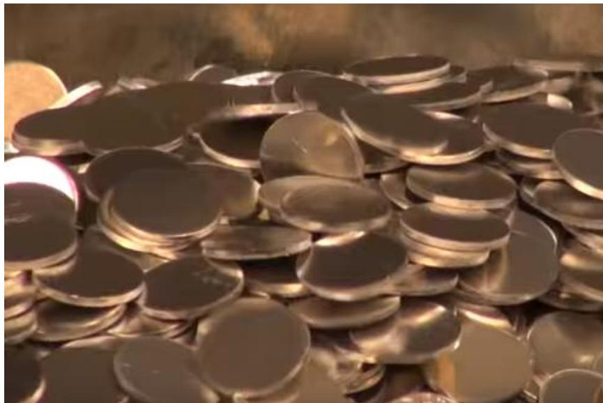
Figura 8. Discos troquelados (Fuente: CNM del Perú)
