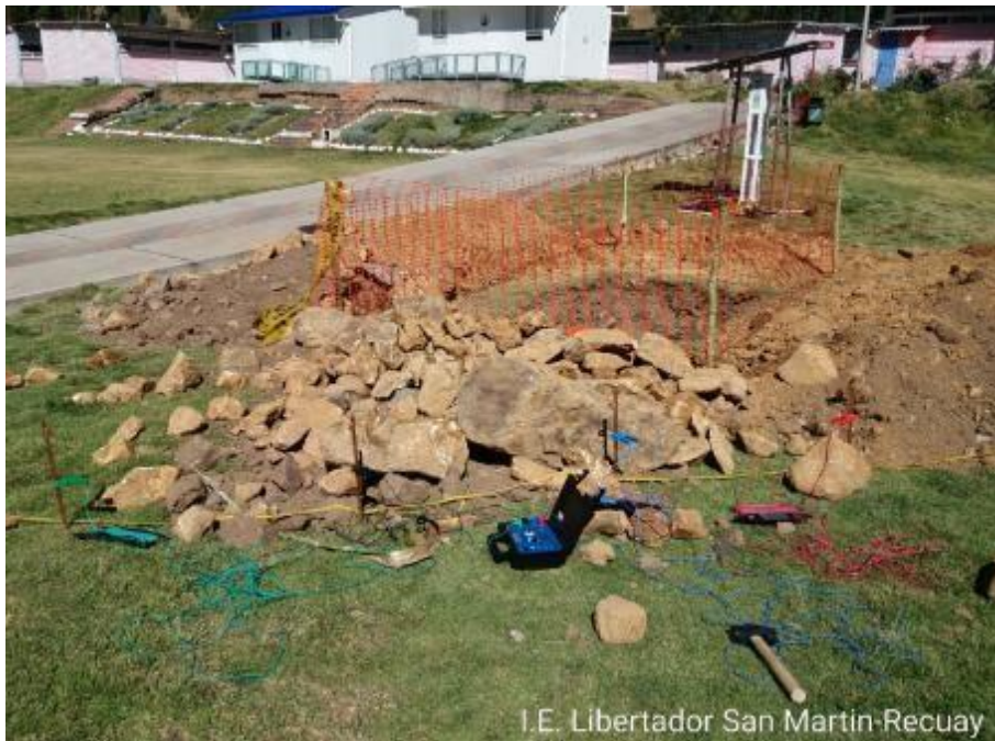
SEV7 por el método de resistividad eléctrica Wenner
