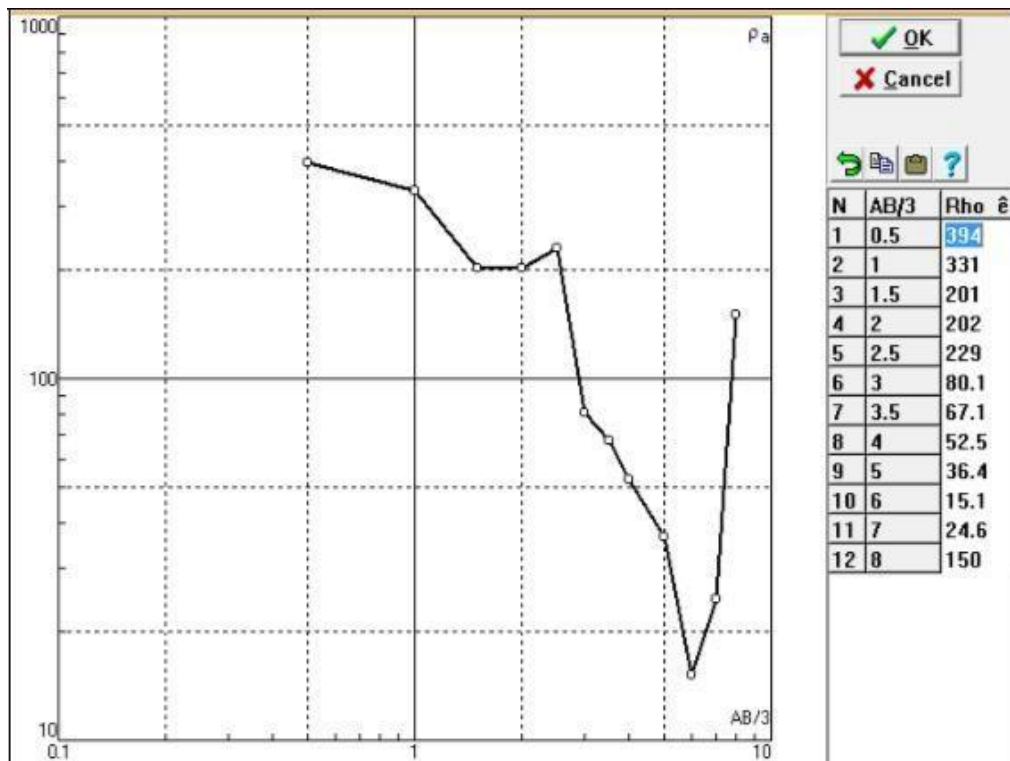
Figura 45. Curva de resistividades aparentes y lecturas obtenidas de campo para SEV1
