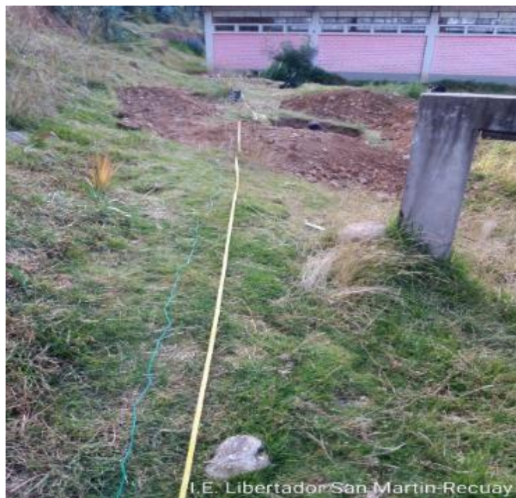
SEV4 por el método de resistividad eléctrica Wenner
