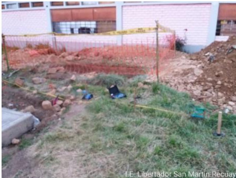
SEV9 por el método de resistividad eléctrica Wenner
