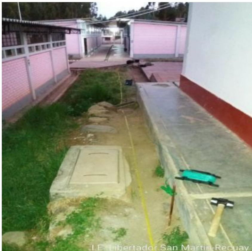
SEV2 por el método de resistividad eléctrica Wenner
