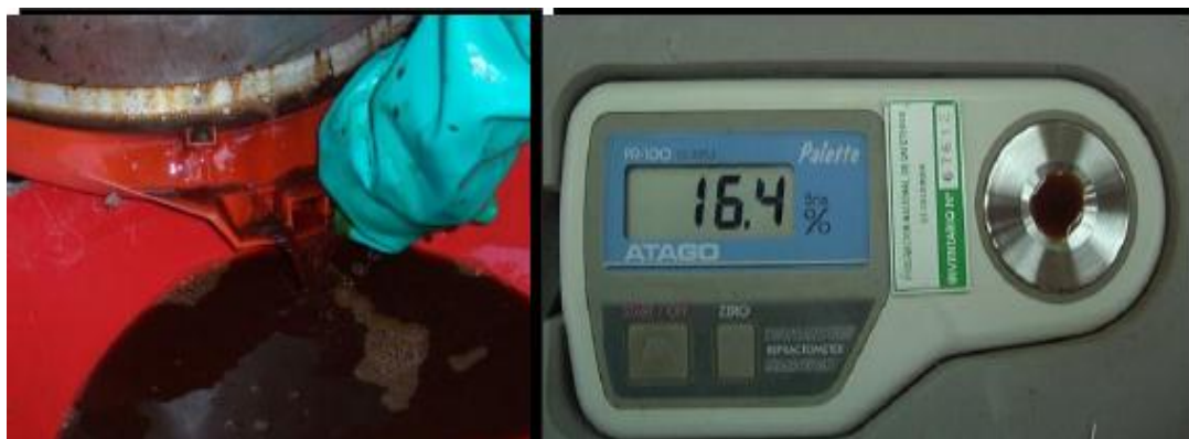
Figura 64 Subproductos del café: Jugo de pulpa con relación a °Brix. Fuente: CENICAFE (2009)
