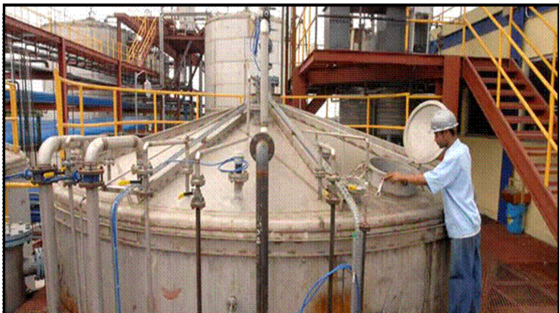
Figura 69 Inoculación y reproducción de la levadura en la planta Fuente: Maple (2010).
