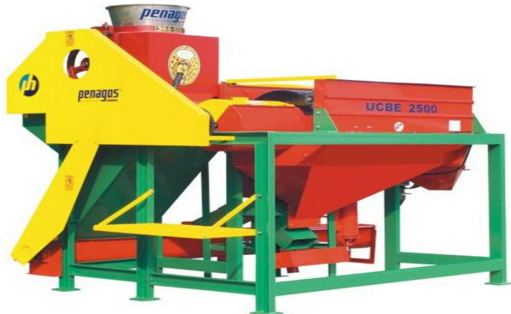
Figura 62 Unidad Compacta de Beneficio Ecológico (UCBE 2500) Fuente: Penagos Hnos.
