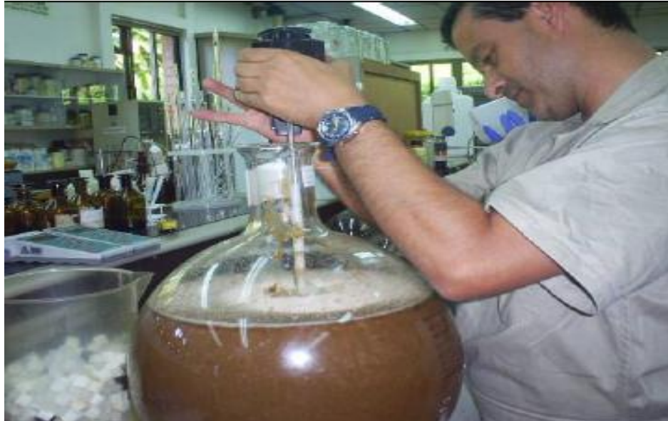
Figura 68 Homogenización del inóculo – sustrato en el laboratorio Fuente: CNICAFE (2009)
