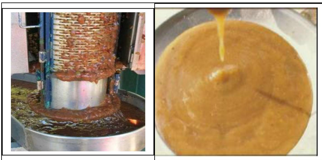
Figura 9 Desmucilaginator y mucílago obtenido del beneficio del fruto. Fuente: Archivo fotográfico CENICAFE.
