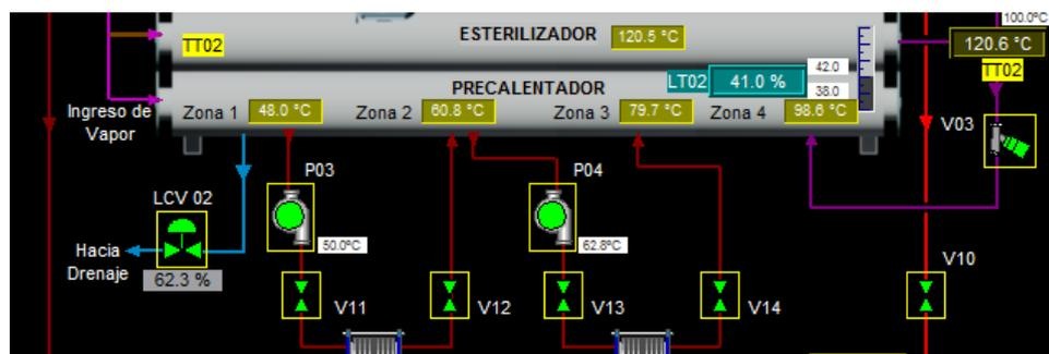
*Figura 39.* Indicador de temperaturas en zonas de tubo de precalentamiento.
