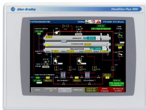
Figura 31: Pantalla de operación (HMI) panel view 1000.
