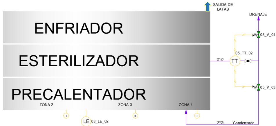
*Figura 11.* Ganancia térmica de condensado del tubo de esterilización.
