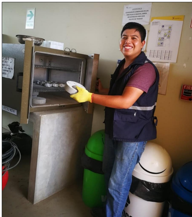
Figura N° 46 Las probetas cilindricas sacadas del horno para el ensayo de permeabilidad.
