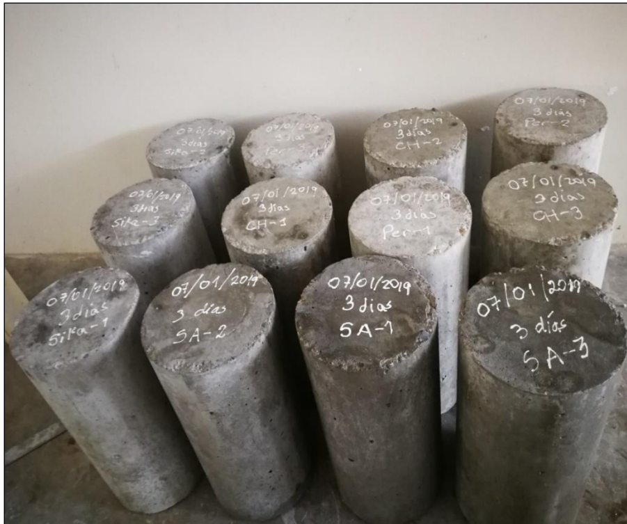
Figura N° 39 Probetas cilindricas apunto de ser sometidas a ensayo de compresion
