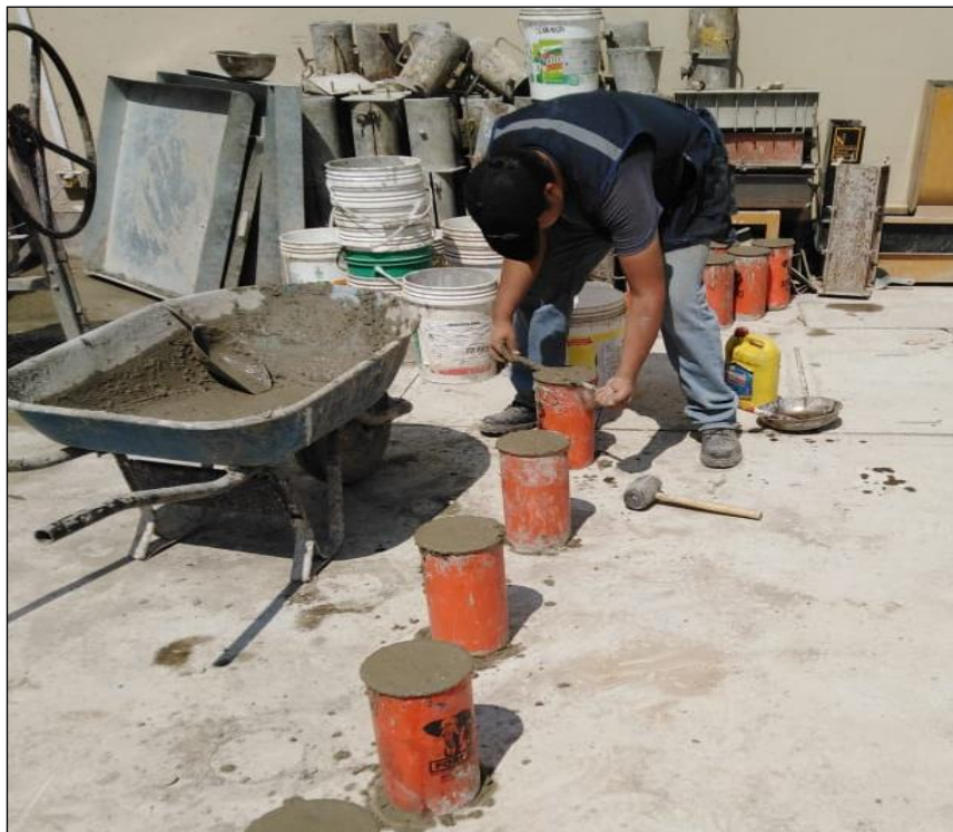
Figura N° 34 Realizando la elaboracion de probetas cilindricas.
