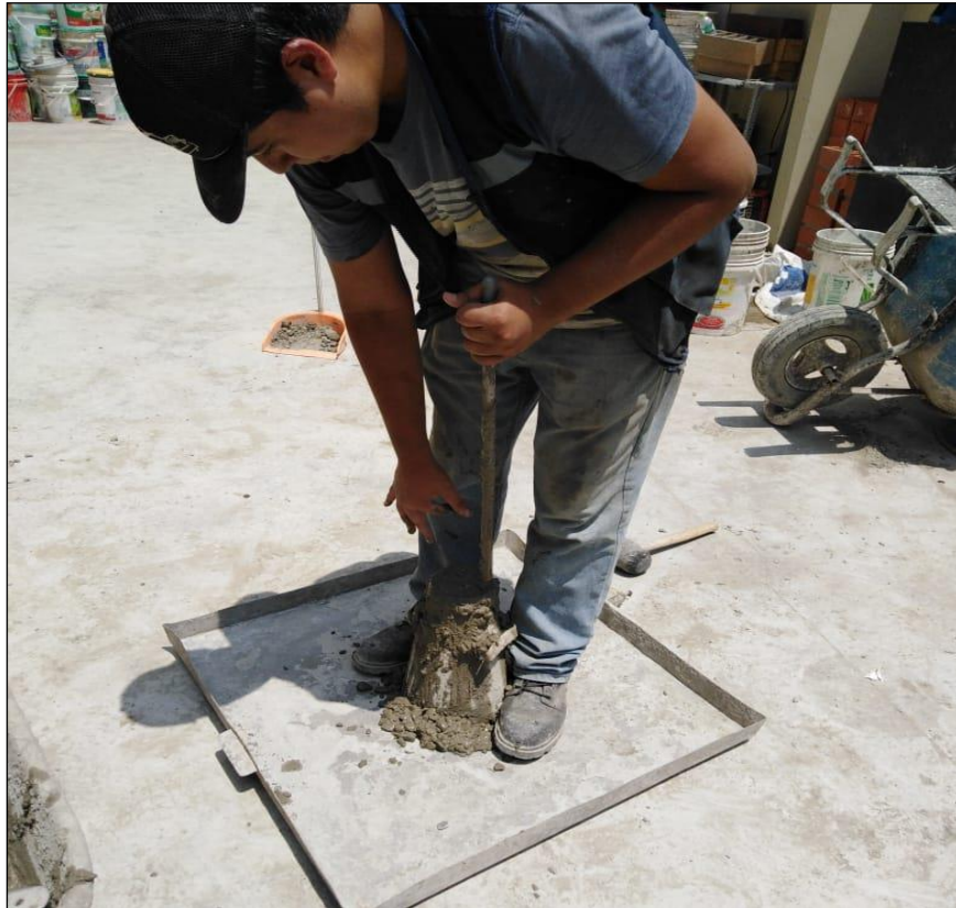
Figura N° 31 Realizando el ensayo del Slump con el cono de Abrams
