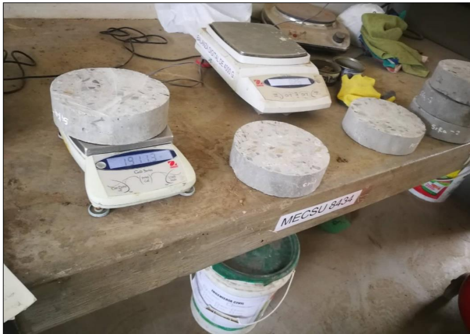
Figura N° 45 Pensando las probetas cilindricas antes de colocar al horno.
