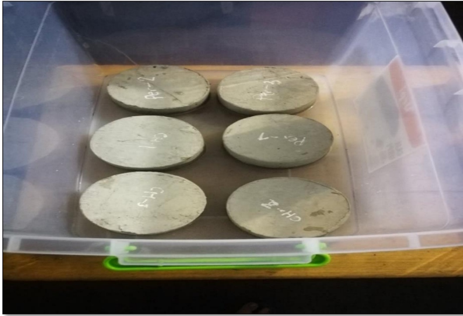
Figura N° 51 Las muestras cilíndricas en el ensayo de permeabilidad capilar
