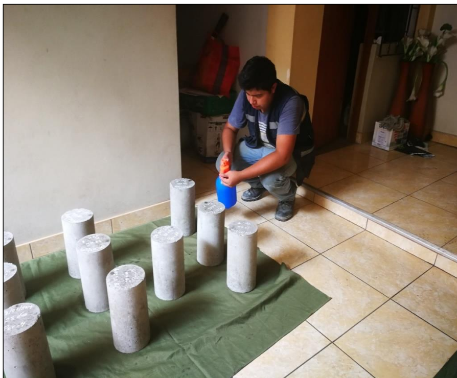
Figura N° 38 Curado de las probetas cilindrias por medio de la aspersion..
