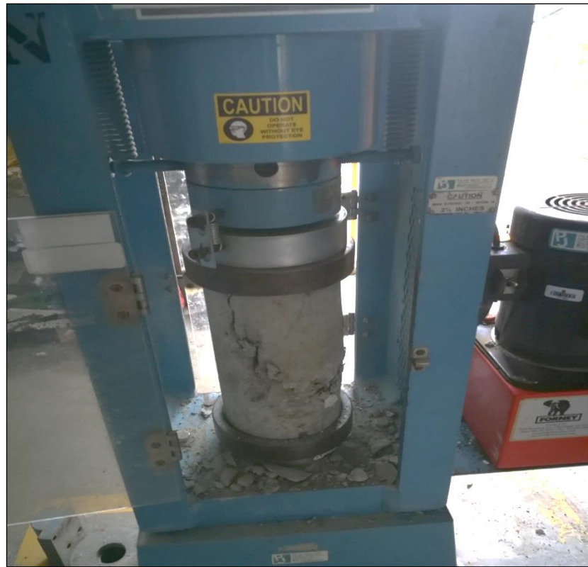
Figura N° 43 Ensayo de compresion a las probetas cilindricas.
