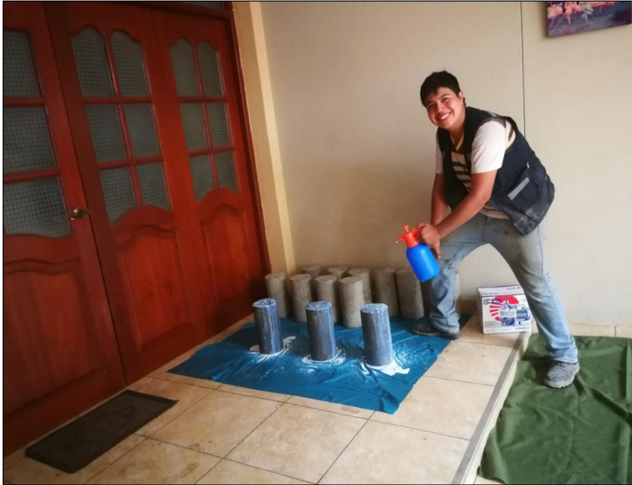
Figura N° 37 Curado de las probetas cilindras por medio de la aspersion.
