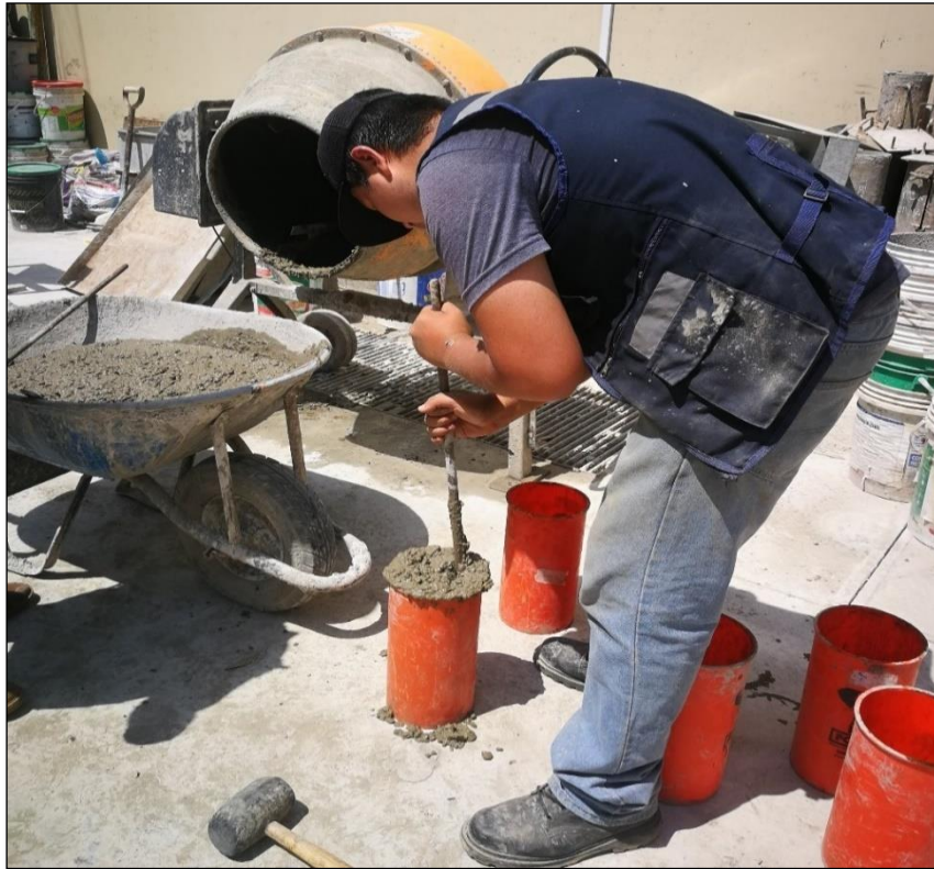
Figura N° 33 Realizando la elaboracion de probetas cilindricas.
