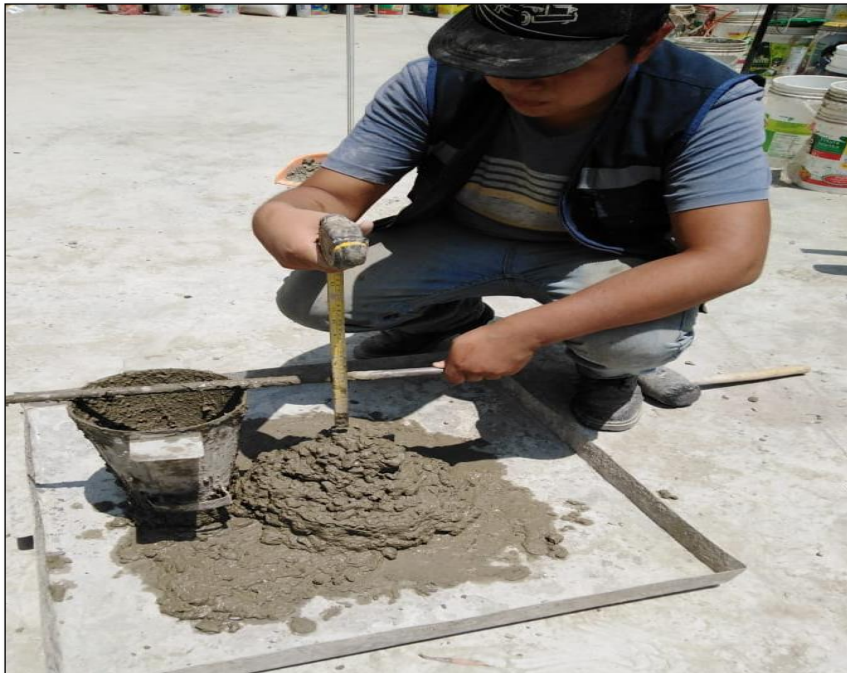
Figura N° 32 Observando que el concreto cumple con el Slump de diseño.
