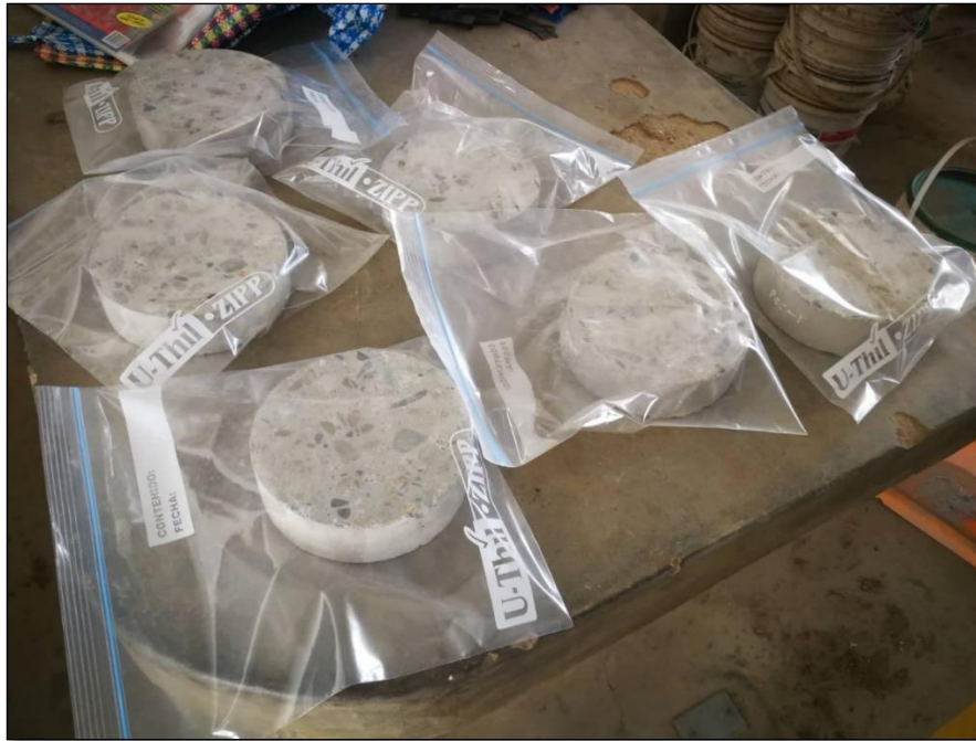
Figura N° 47 Las probetas cilindricas en bolsas selladoras que impide el paso de humedad.
