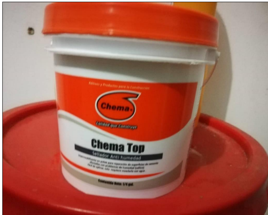
Figura N° 48 El sellador Anti Humedad Chema Top que impedira el paso del agua en las probetas.
