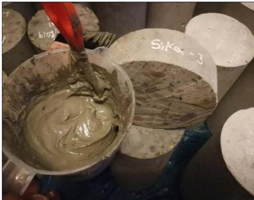
Figura N° 50 Colocando la mezcla del sellador Chema Top en las en las caras laterales y superior
