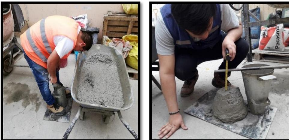
*Figura N° 21 Ensayo de Asentamiento del concreto (Usando Cono de Abrams). Fuente: Propia.*
