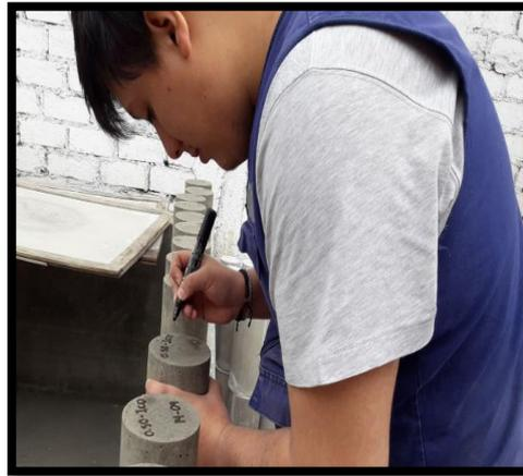
Figura N° 25 Codificación de probetas de concreto. Fuente: Propia.
