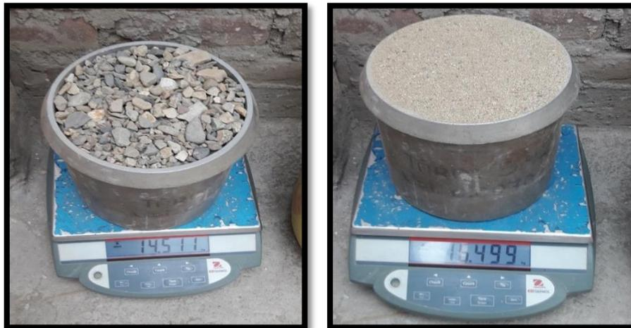
Figura N° 14 Ensayo de Peso Unitario. Fuente: Propia.
