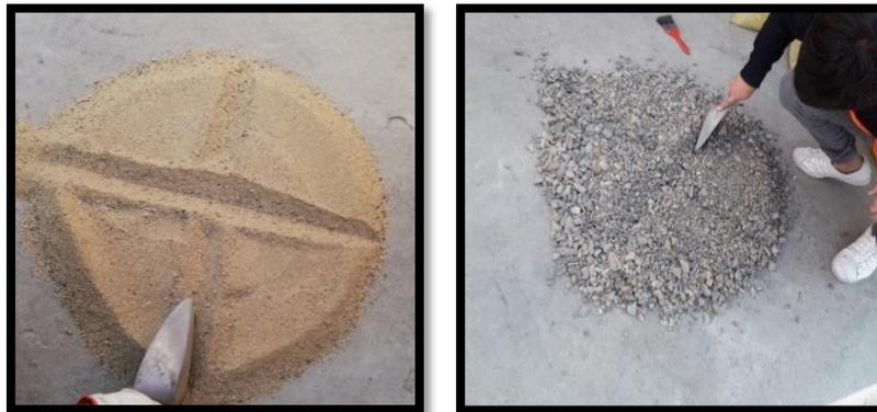
*Figura N° 11 Cuarteo de Agregados para Ensayos. Fuente: Propia.*
