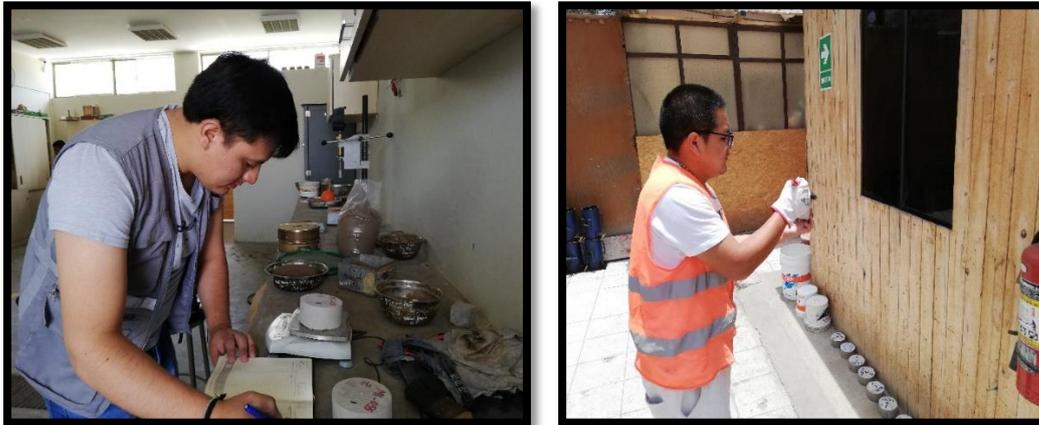
Figura N° 31 Pesaje y colocación de sellante a especímenes de concreto. Fuente: Propia.
