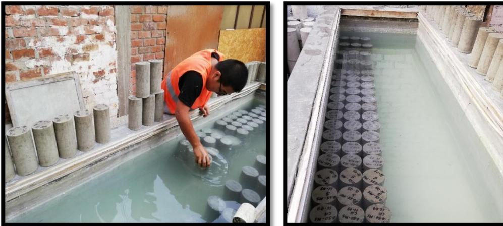
Figura N° 26 Curado de Probetas. Fuente: Propia.
