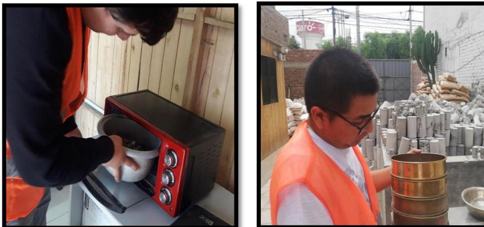
*Figura N° 12 Ensayos de Contenido de Humedad y Granulometría. Fuente: Propia.*
