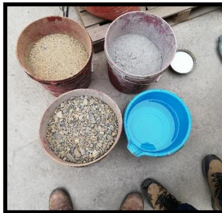
Figura N° 18 Materiales para elaboración de Concreto. Fuente: Propia.
