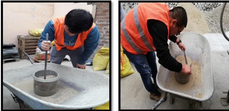
Figura N° 13 Chuzado y enrasado para ensayo de Peso Unitario. Fuente: Propia.
