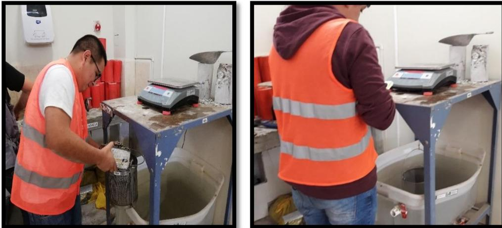
Figura N° 16 Peso Específico y Absorción de Agregado Grueso. Fuente: Propia.
