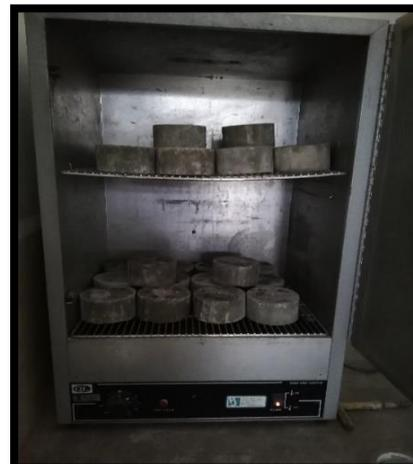
Figura N° 30 Colocación de muestras aserradas de concreto en horno a 50°C. Fuente: Propia.
