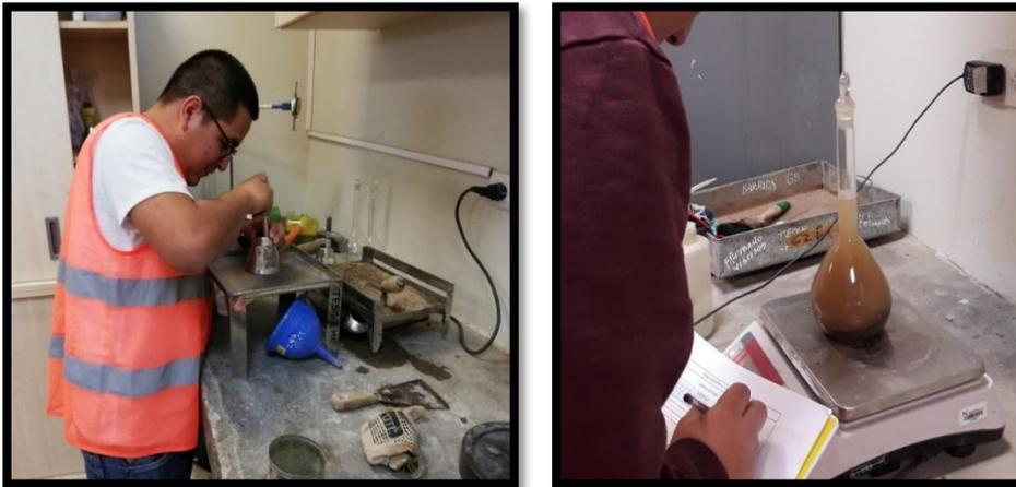
Figura N° 17 Peso Específico y Absorción de Agregado Fino. Fuente: Propia.
