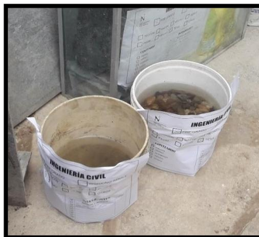
Figura N° 15 Muestra para ensayos de Peso Específico y Absorción. Fuente: Propia.
