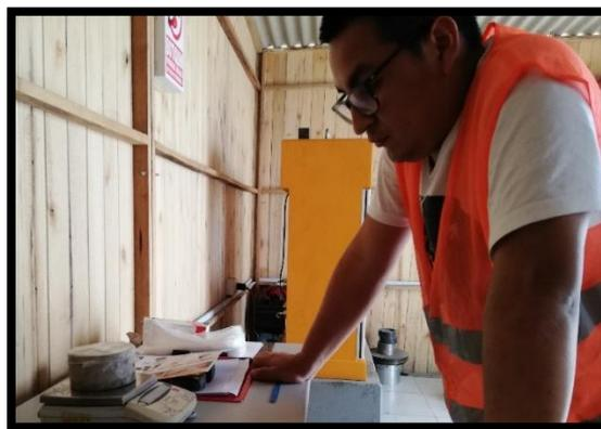
Figura N° 33 Pesaje de especímenes. Fuente: Propia.
