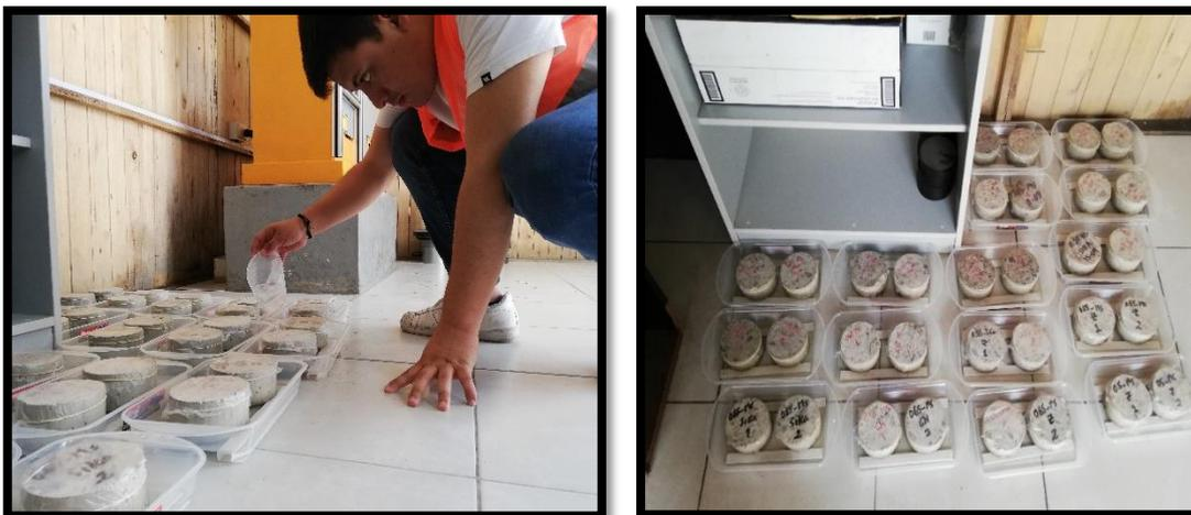
Figura N° 32 Ensayo de Tasa Absorción. Fuente: Propia.
