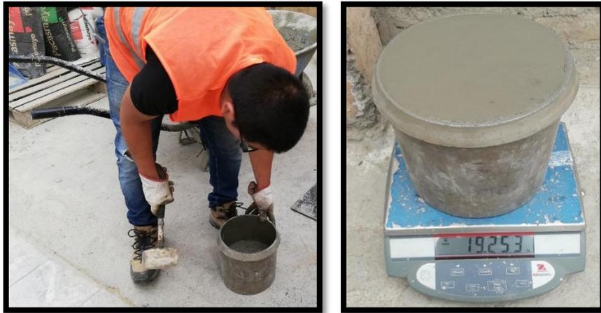
Figura N° 22 Ensayo de Peso Unitario del Concreto. Fuente: Propia.
