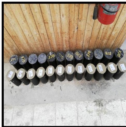
Figura N° 24 Concreto en moldes de probetas de 4" x 8". Fuente: Propia.
