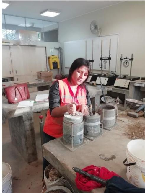
**Ilustración 13:** Ensayo CBR de un suelo
