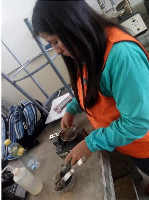
**Ilustración 10:** Ensayo de límite líquido
