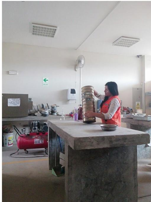
**Ilustración 8:** Ensayo de granulometría por tamizado
