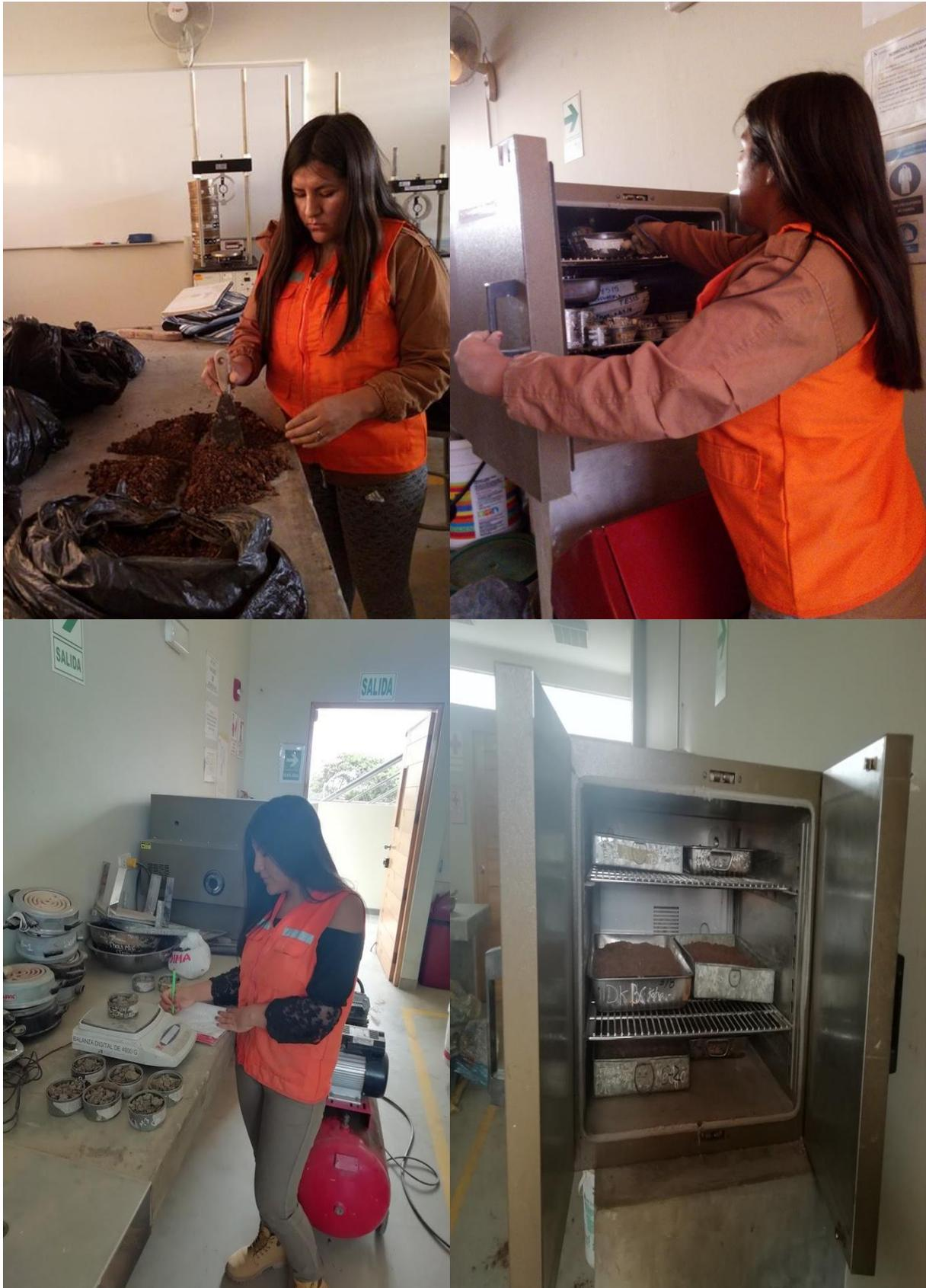
**ANEXO 80: Ensayos Gravedad Específica de las muestras**
