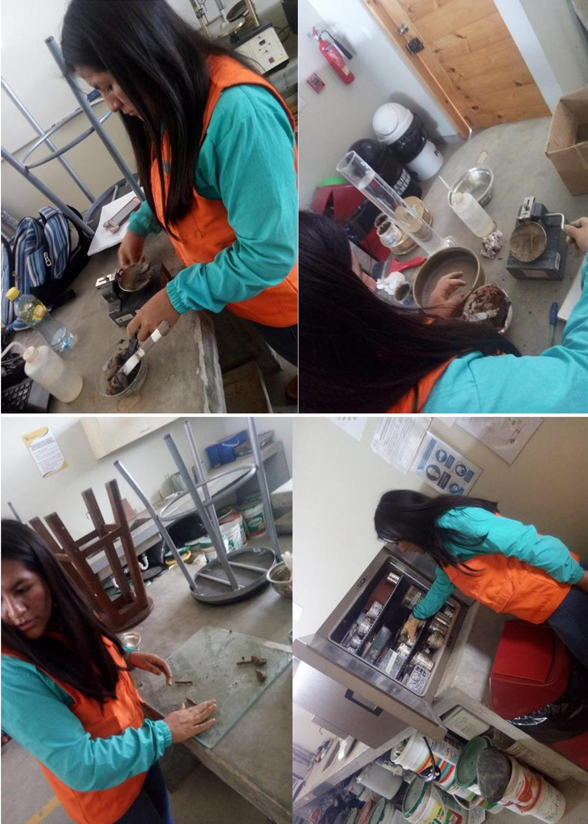
**ANEXO 84: Ensayos Proctor Modificado de los 2 Estratos de la C3**
