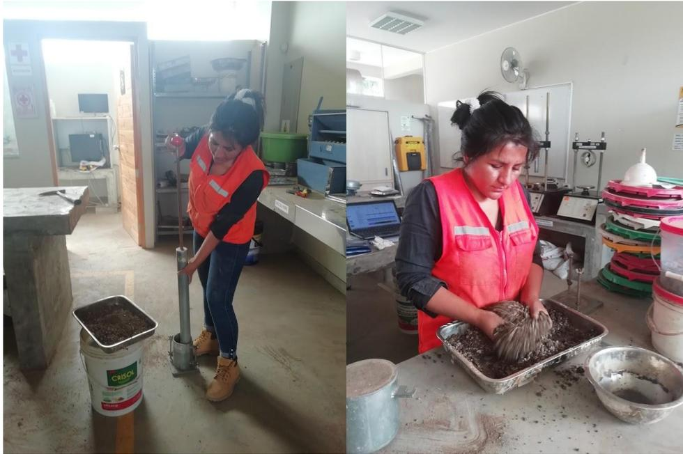
**Ilustración 12:** Ensayo proctor modificado de un suelo
