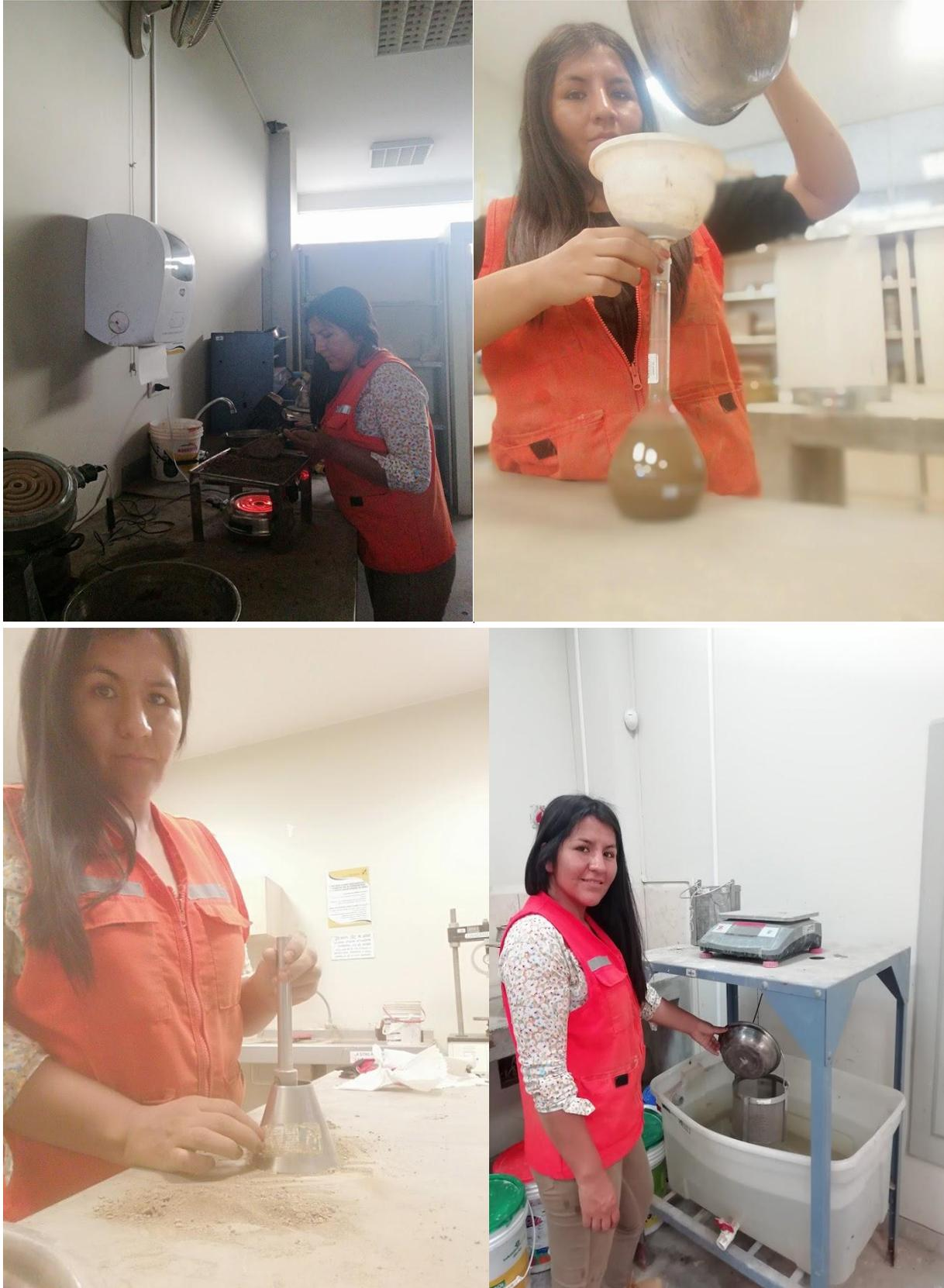
**ANEXO 81: Ensayos Análisis Granulométrico por Tamizado de las muestras**
