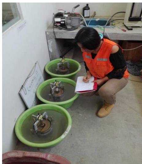
**Ilustración 15:** Midiendo el hinchamiento del suelo para ensayo CBR
