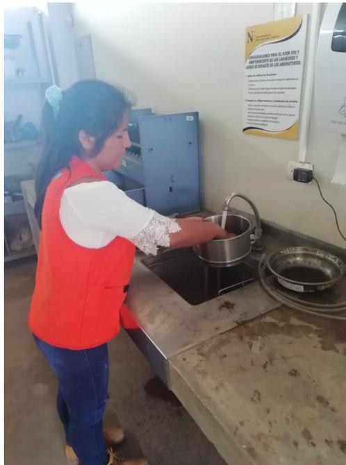
**Ilustración 9:** Ensayo de granulometría por lavado
