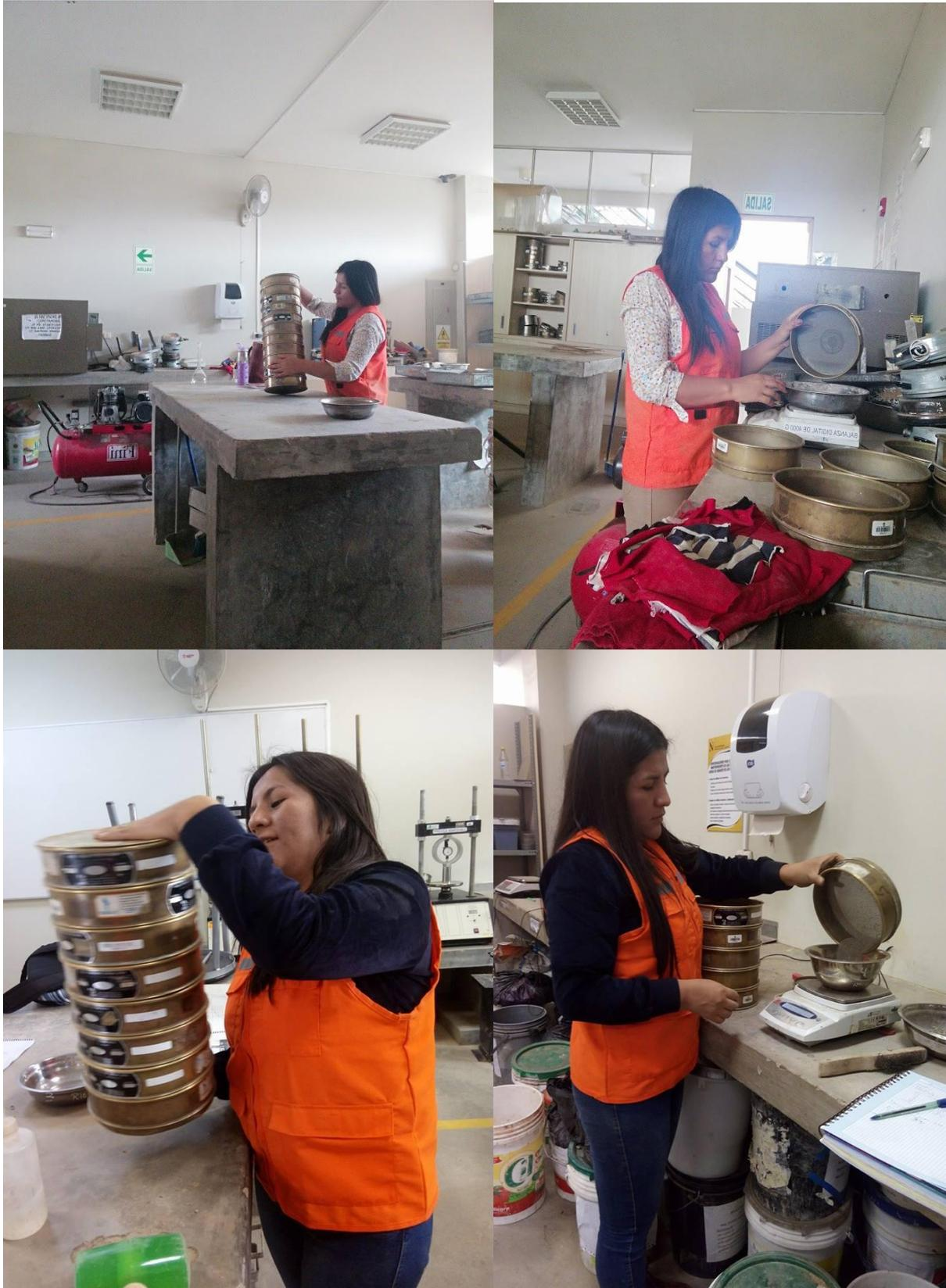
**ANEXO 82: Ensayos Análisis Granulométrico por Lavado de las muestras**
