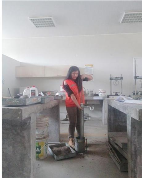
**Ilustración 14:** Compactación del suelo para ensayo CBR
