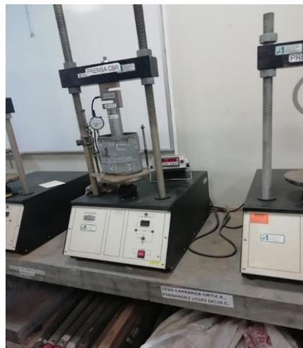
**Ilustración 16:** Especímen en la maquina CBR
