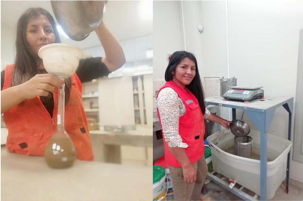
**Ilustración 7:** Ensayo de gravedad específica del suelo
