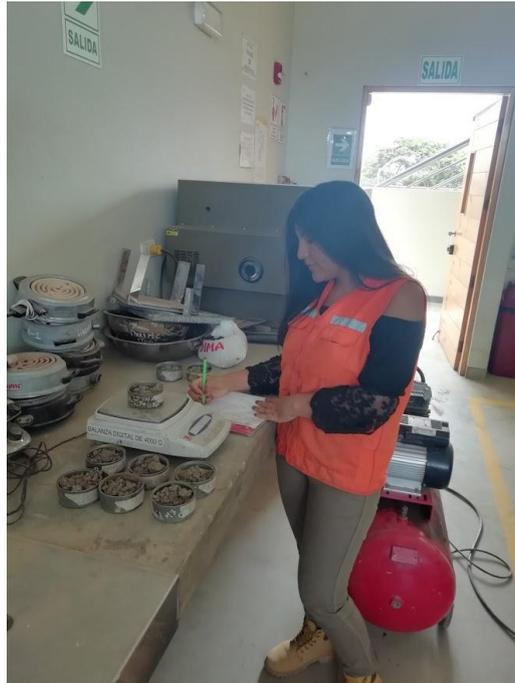
**Ilustración 6:** Muestras del ensayo contenido de humedad
