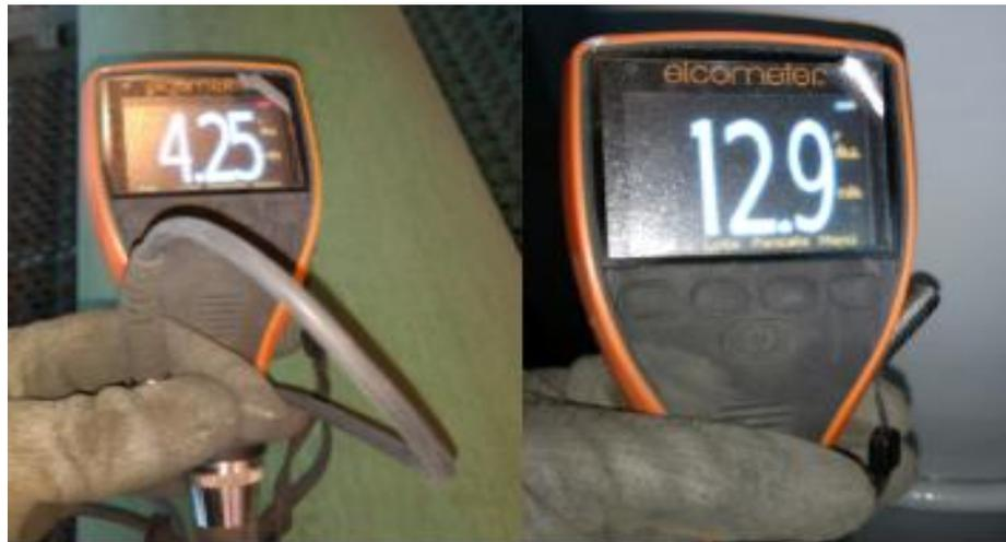
**Imagen 4.** *Equipo Elcometer, medidor de espesor de pintura.*
