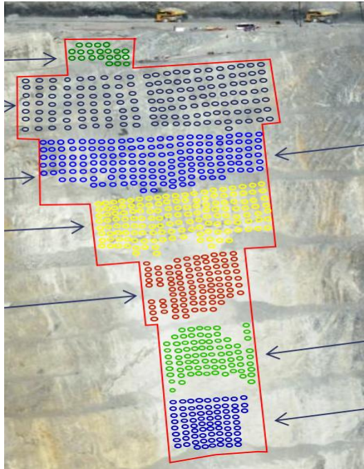
Esquema General De Malla Y Pernos Instalados
