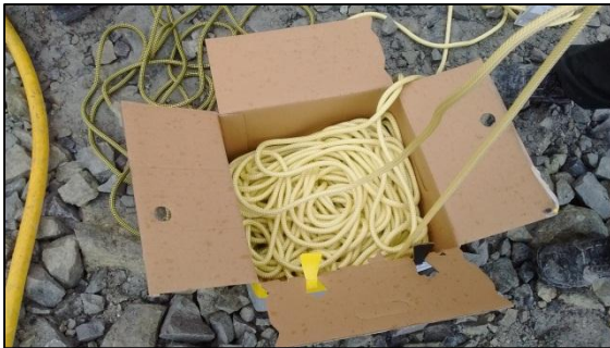
Cuerdas semi estáticas utilizadas como parte del equipo de ascenso y descenso de persona en el talud
