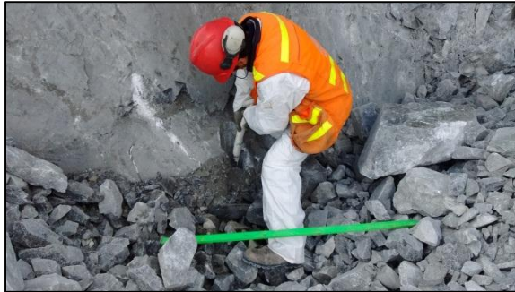
Desactivación por parte del cliente de algunos tiros cortados encontrados
