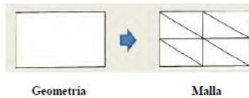
Figura 23. División de la geometría en una malla de elementos finitos
