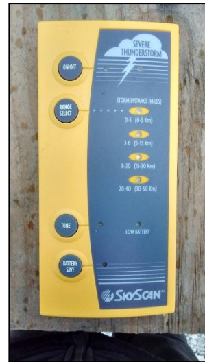
Equipo detector de tormentas, habilitado de modo permanente en el frente de trabajo
