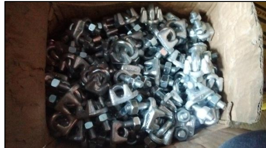
Grapas de 3/8” para el empalme de malla Steel Grid.
