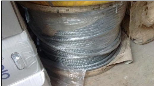
Suministro de cables de acero de 12 y 10 mm
