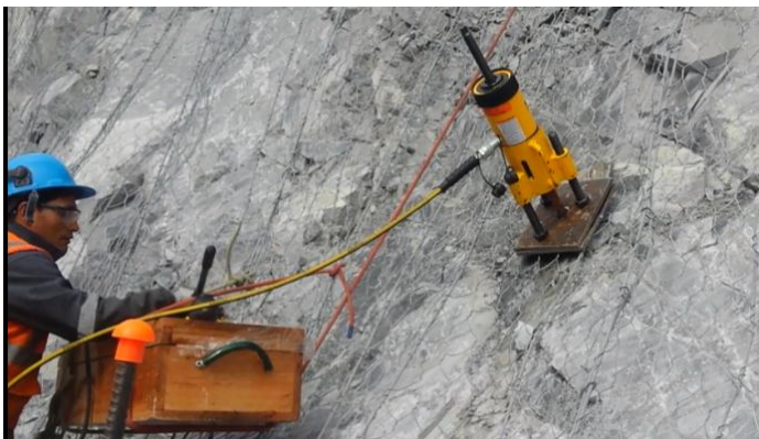
ENSAYOS PULL TEST
