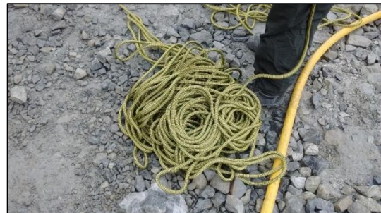
Cuerdas semi estáticas utilizadas como parte del equipo de ascenso y descenso de persona en el talud
