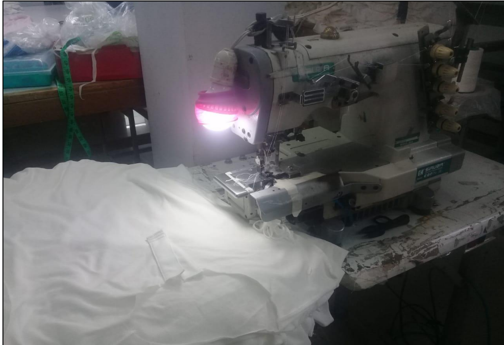
Figura N° 3.12 – Iluminación en maquina Recubridora
