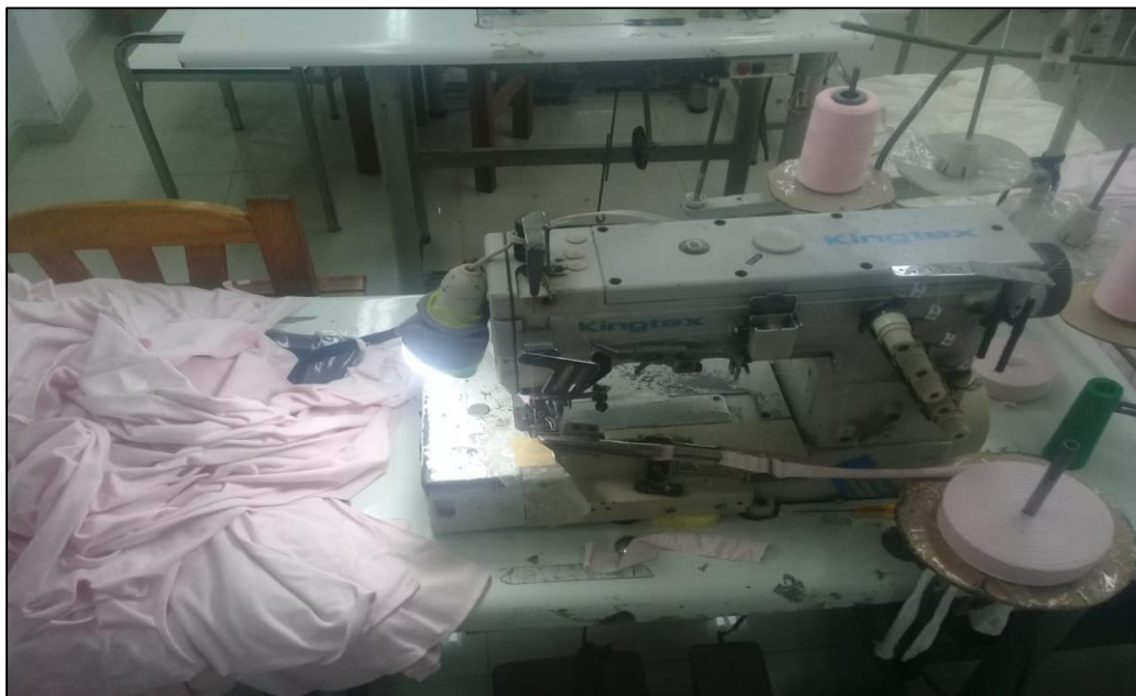
Figura N° 3.13 – Iluminación en maquina Bastera
