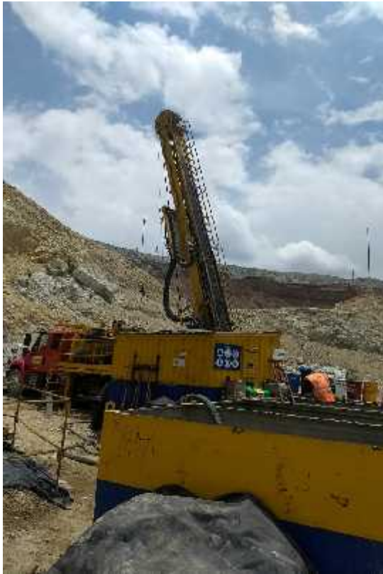
Ilustración 5 Máquina CS3001 perforadora diamantina
