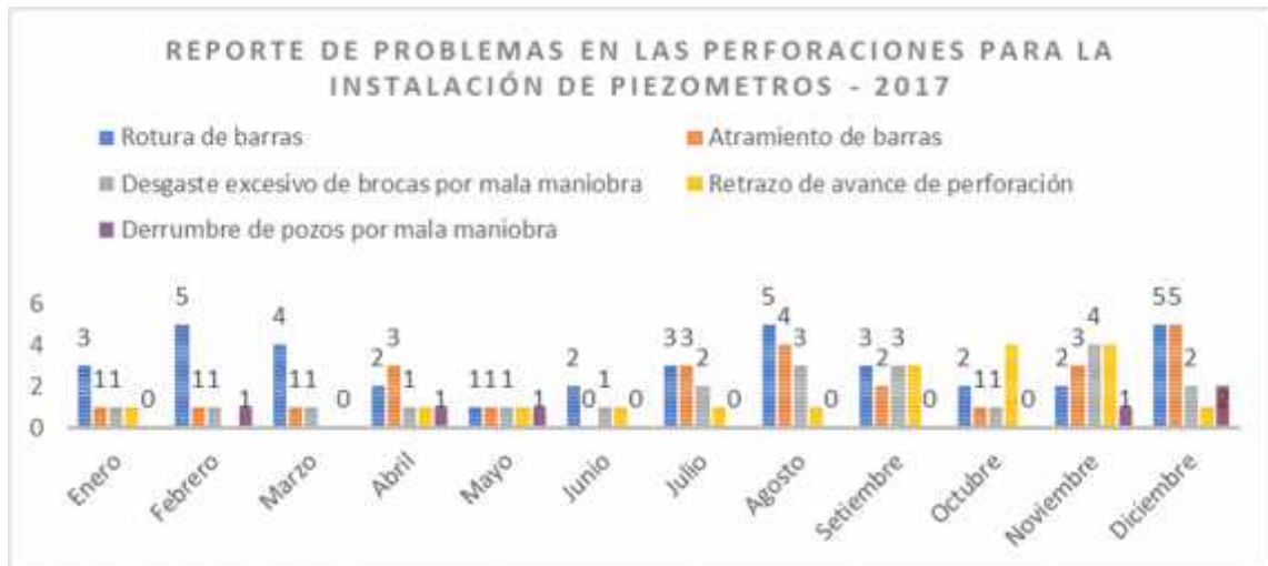
Ilustración 1: Reporte de problemas en las perforaciones para la instalación de piezómetros 2017.
