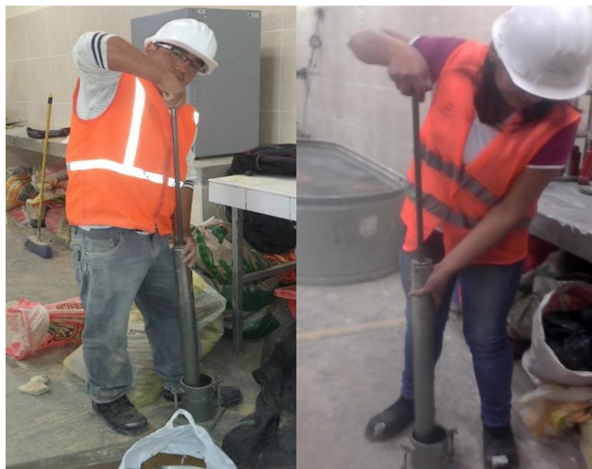
Figura N° 19: Ensayo de compactación Proctor
