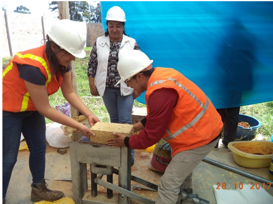
Figura N° 26: Obtención del adobe compactado
