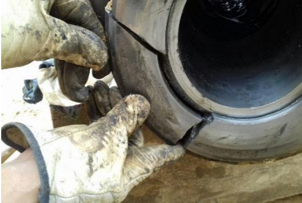
Figura 2: Ruptura de componentes por fatiga
