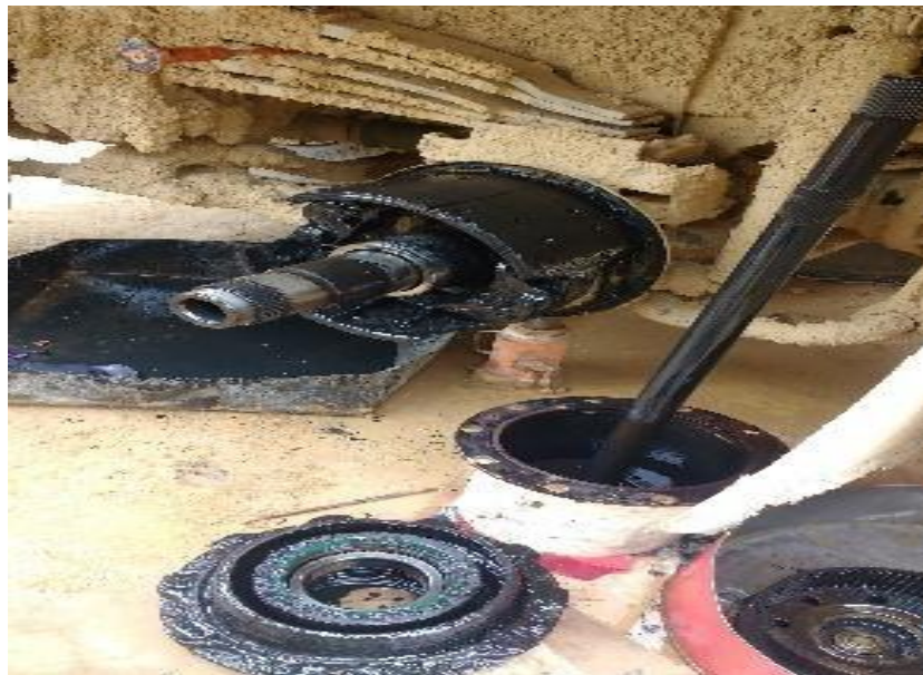
Figura 3: Mala ejecución de mantenimientos preventivos
