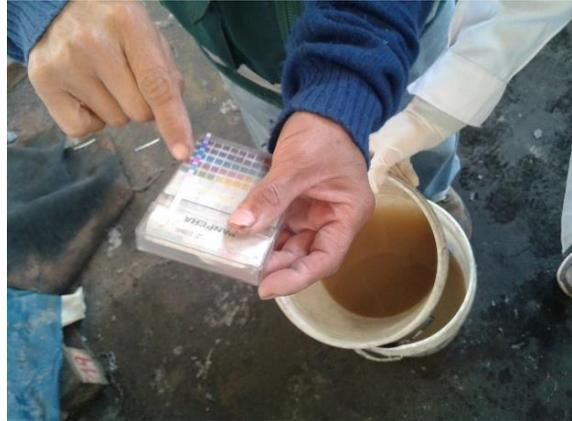
Imagen N° 1: Toma de Muestra en la Curtiembre y medición de pH en campo.
