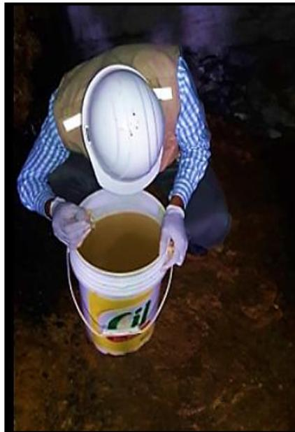
*Figura 8 Ácido nítrico para preservar la muestra.*
