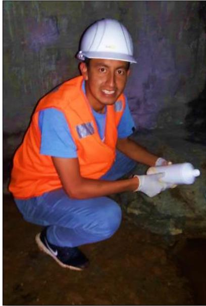
*Figura 5 Recolección de agua ácida para análisis ICP*
