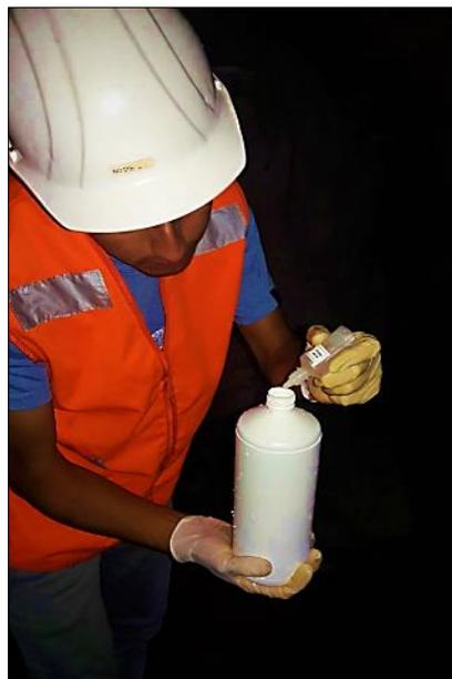
*Figura 6 Preservación de la muestra con ácido nítrico*
