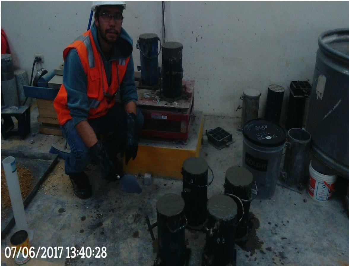
ANEXO n.º 27. Desmolde de probetas.
