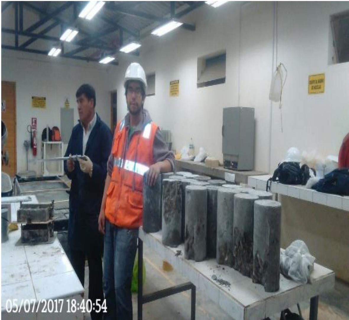
ANEXO n.º 34. Probetas luego de ensayo.
