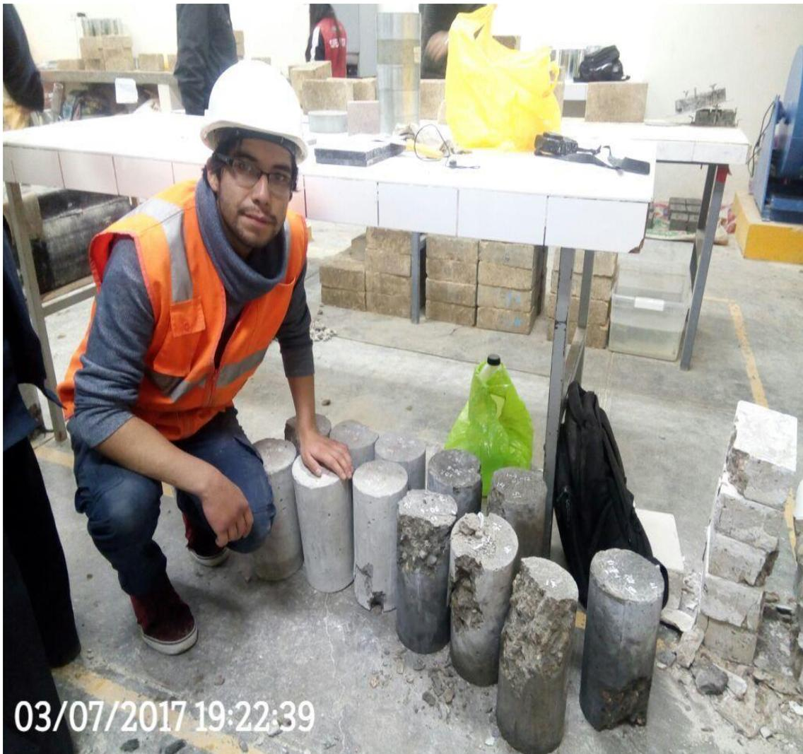
ANEXO n.º 35. Probetas luego de ensayo.
