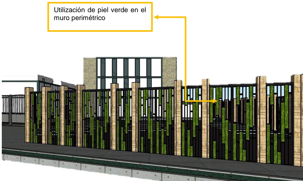
**IMAGEN 20:** 3d de muro perimétrico con aplicación de cerramiento ajardinado.
