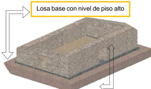
Losa base con nivel de piso alto
