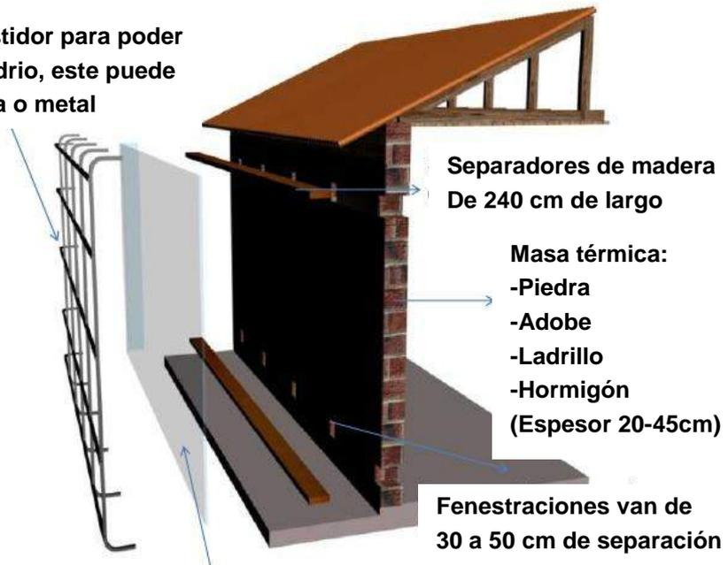
Cristal doble traslucido de 6 x 1 120 de alto y 240 de ancho
