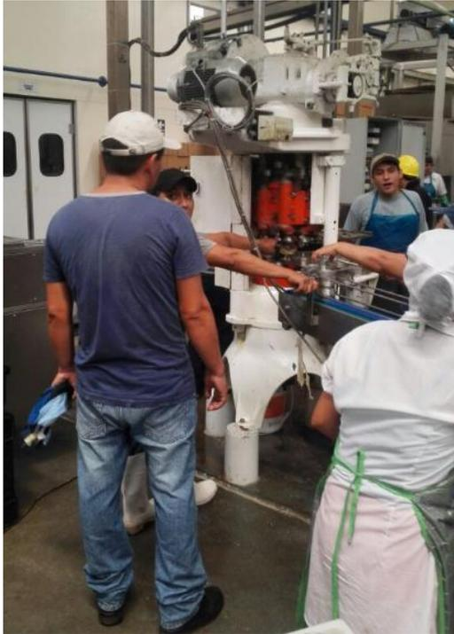
Figura 29: Máquina selladora. Fuente: Elaboración propia
