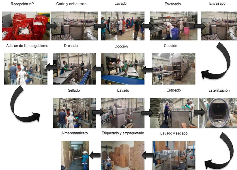
*Figura 11:* Diagrama pictórico de la línea enlatado-crudo de la empresa INVERSIONES QUIAZA S.A.C. Fuente: Elaboración propia
