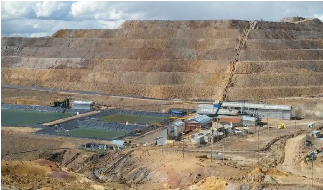
Figura 9. Pad Lixiviación y Planta de procesos de recuperación de oro y plata.
