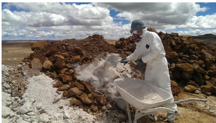
Figura 3. Dosificación de cal en la descarga de mineral en el pad Fuente: López, 2018.
