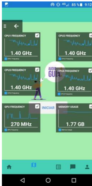
Figura 18. Primer análisis de eficiencia de la aplicación nativa mediante la herramienta Trepn Profiler
