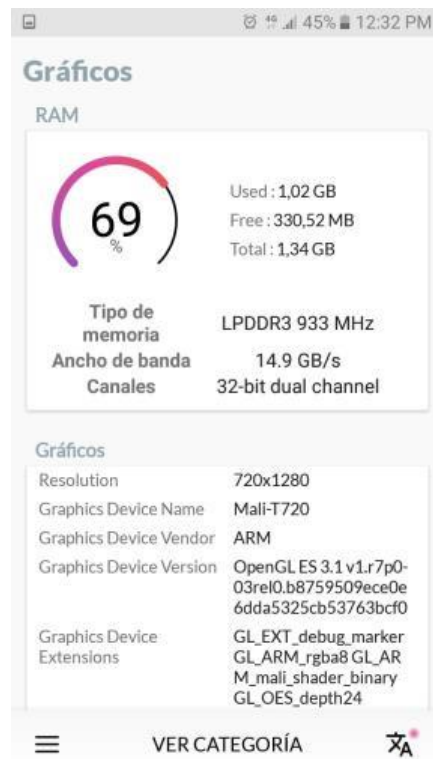
Figura 38. Tercer análisis de eficiencia memoria RAM de la aplicación nativa mediante la herramienta Trepp Profiler
