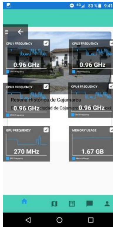
Figura 36. Tercer análisis de eficiencia de la aplicación nativa mediante la herramienta Trepro Profiler
