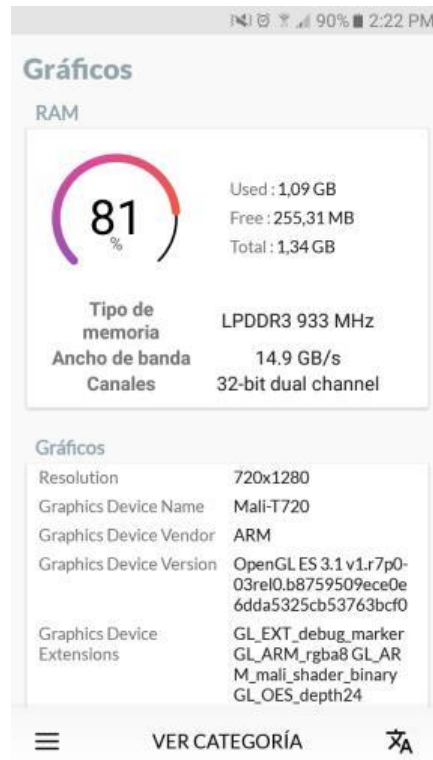
Figura 21. Primer análisis de eficiencia de la memoria RAM de la aplicación nativa mediante la herramienta Device Info
