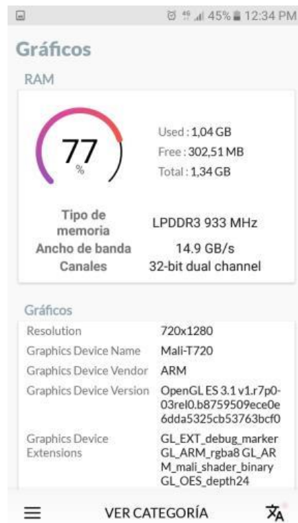
Figura 64. Tercer análisis de eficiencia de memoria RAM de la aplicación híbrida mediante la herramienta Device Info
