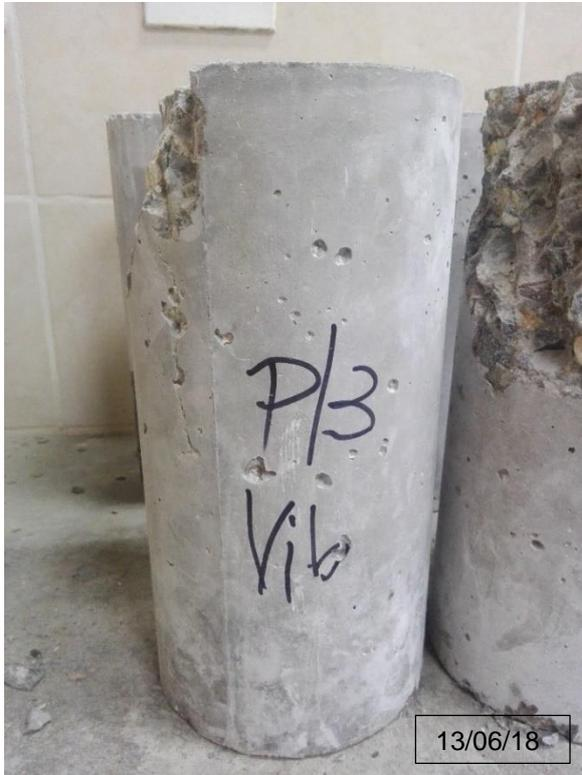
*Fotografía 4: Fractura presentada en la probeta N° 17 vibrada por Vibrador tipo aguja a los 28 días.*
