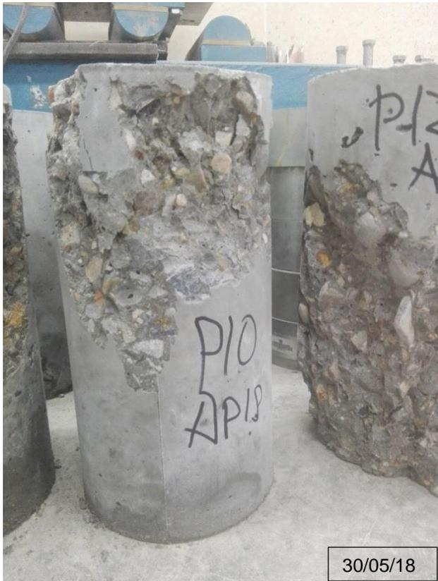
*Fotografía 2: Fractura presentada en la probeta N° 13 vibrada por Apisonado a los 28 días.*
