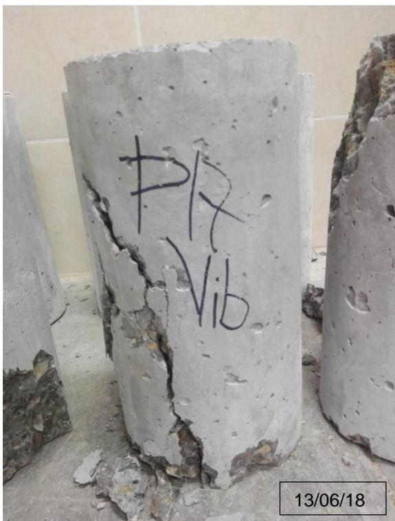
*Fotografía 5: Fractura presentada en la probeta N° 08 vibrada por Mesa vibratoria a los 14 días.*
