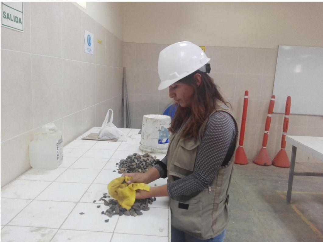
*Fotografía 12: Peso específico del agregado fino.*
