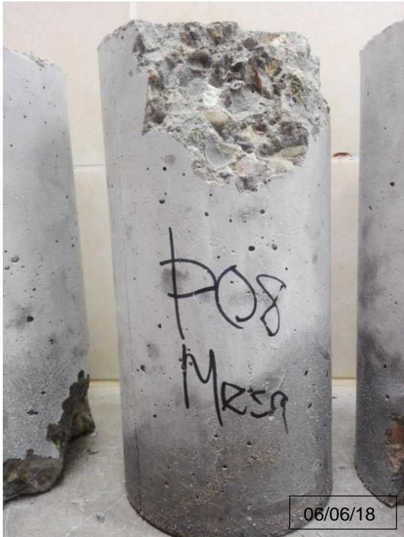
*Fotografía 6: Fractura presentada en la probeta N° 16 vibrada por Mesa vibratoria a los 28 días.*
