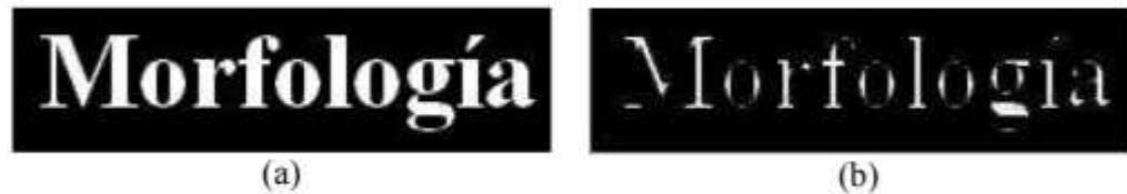
**Figura 27:** Erosión de una imagen binaria; (a) Imagen Original; (b) Imagen Erosionada.
