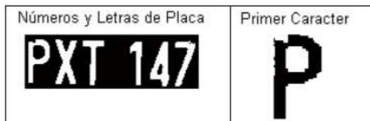
*Figura 31:* Extracción del primer carácter de la placa.
