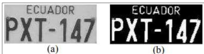
**Figura 30:** Segmentación por umbralización de la placa de un automóvil (a) imagen original; (b) Segmentación con umbral de 128.
