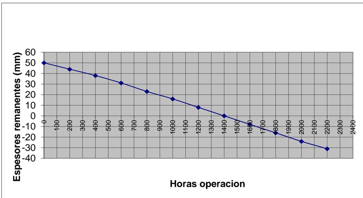
Figura 34. Curva de desgaste de disco de succión metálico.
