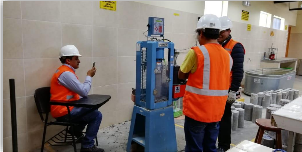
Ensayo de Resistencia a la compresión.
