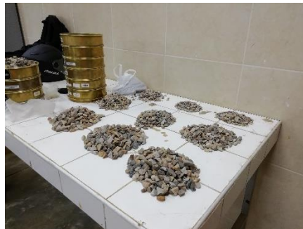
Figura 2.5. Tamizando de agregado grueso.
