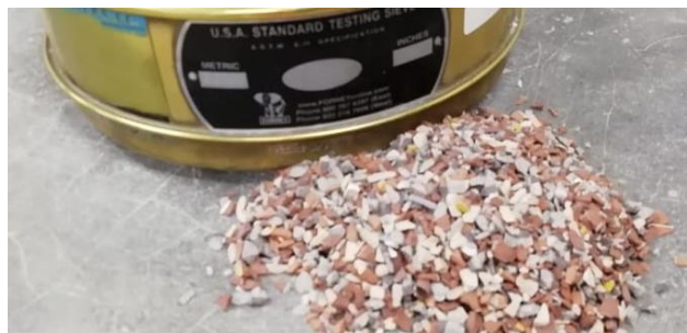
Figura 2.3. Tamizado de cerámico triturado
