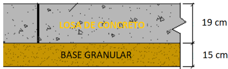
Figura 18: Estructura del Pavimento Rígido, Método AASHTO.
