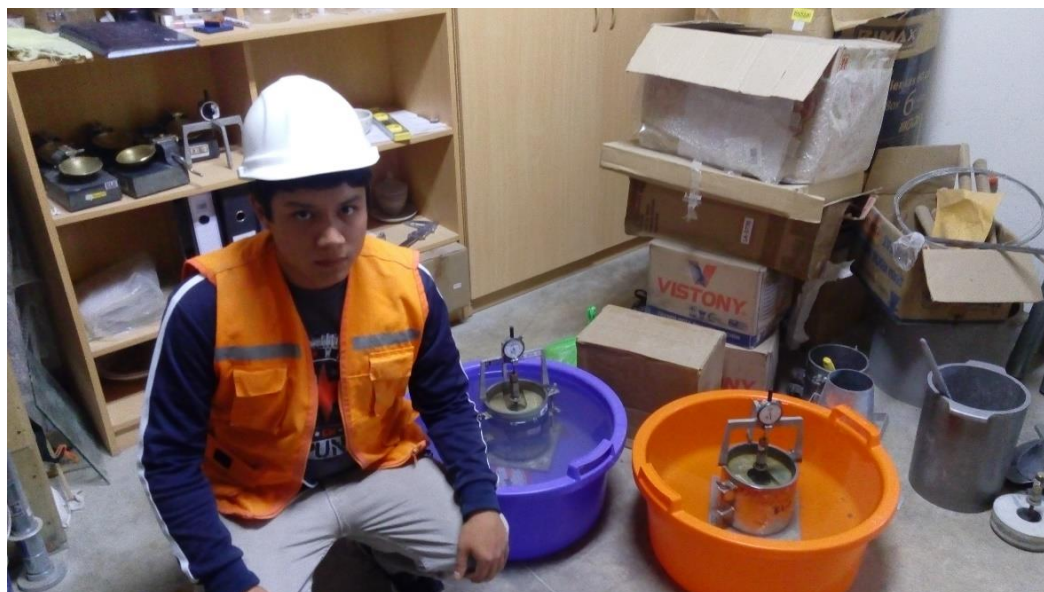
Figura 29: Sumersión de moldes CBR para determinar hinchamiento.
