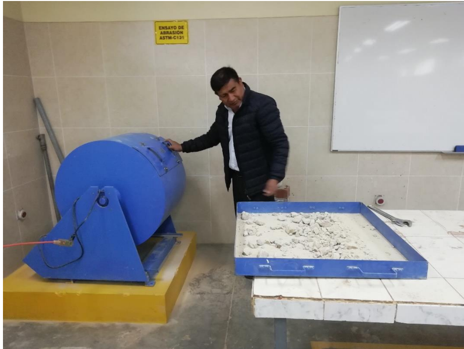
Fotografía N° 11: Sacando la muestra del ensayo de abrasión para su posterior tamizaje
