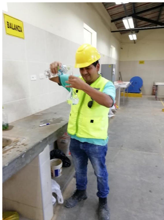
Fotografía N° 12: Midiendo la cantidad de agua en la fiola para el ensayo de vacíos.
