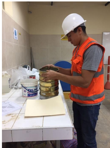
Figura 5. Ensayo de granulometría.
