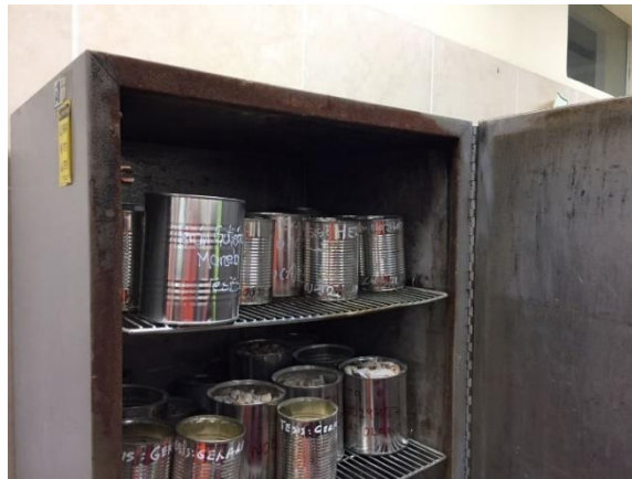
Figura 4. Muestra en el horno para contenido de humedad.
