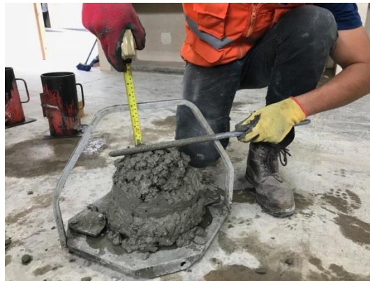
Figura 29. Prueba del slump.
