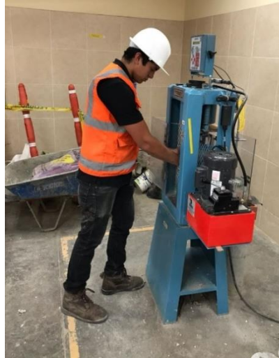
Figura 15. Colocación de los especímenes en la prensa hidráulica.
