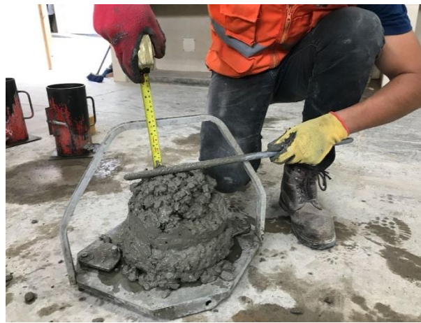
Figura 14. Asentamiento del concreto en estado fresco.
