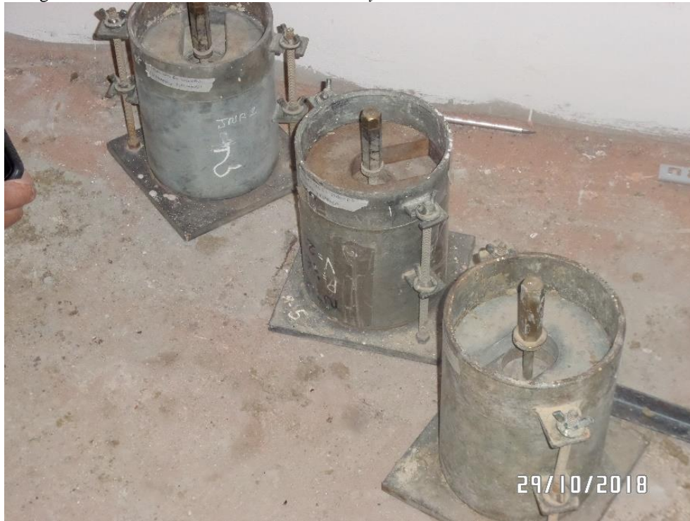
Fotografía 11: Moldes con las muestras del ensayo "CBR"
