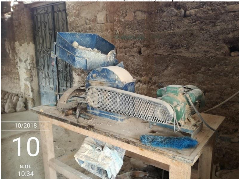
Fotografía 8: Chancado de material para realizar los ensayos de proctor y CBR
