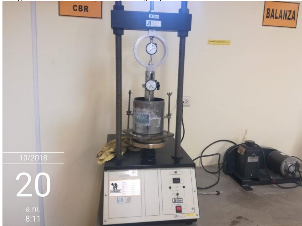
Fotografía 15: Realización del ensayo "carga – penetración"
