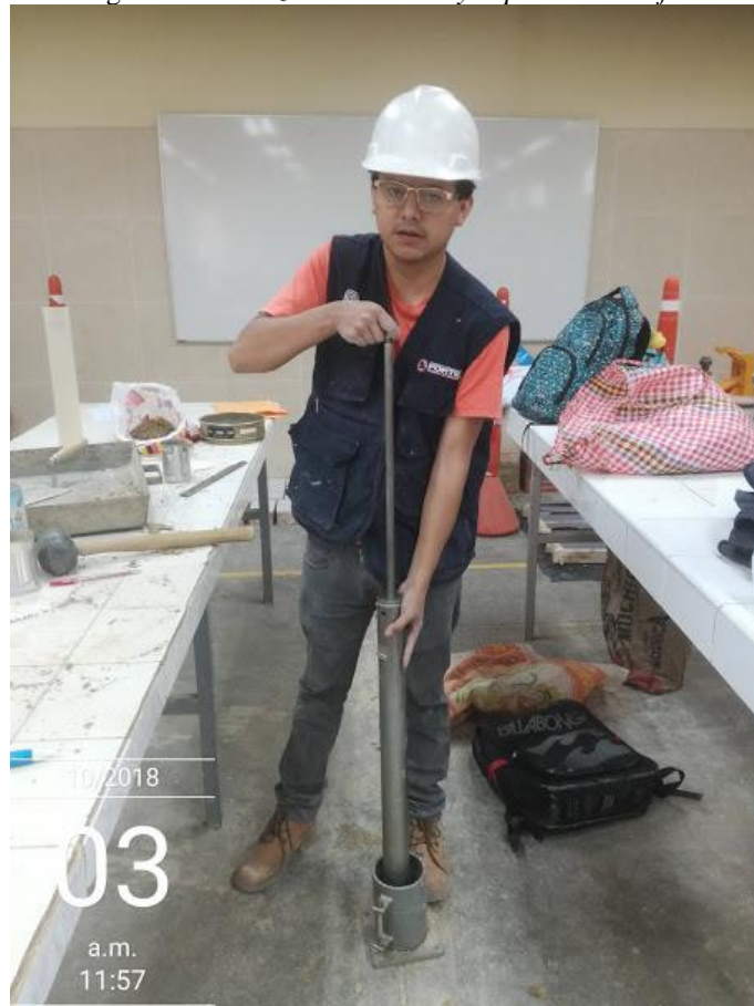
Fotografía 9: Realización del ensayo "proctor modificado"
