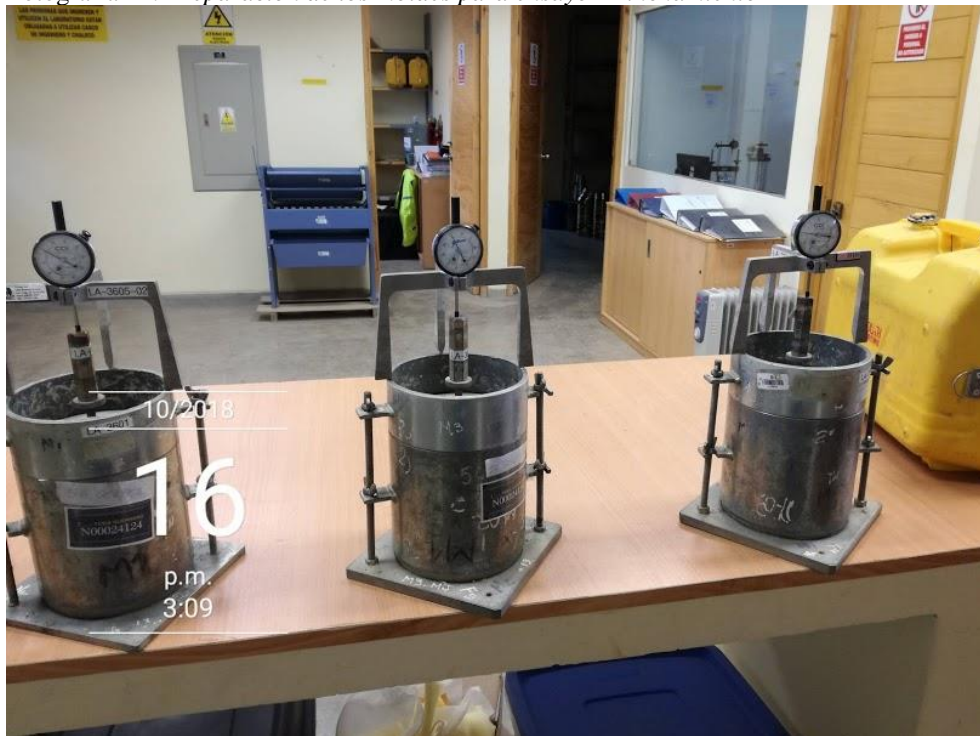
Fotografía 12: Preparación de los moldes para ensayo "Hinchamiento"
