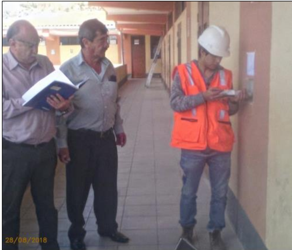
Figura 16. Realizando los ensayos de esclerometría en el módulo 01 de la C6 del tercer piso, con el ingeniero Javier Colina Bernal y el Ing. Juan Villanueva.
