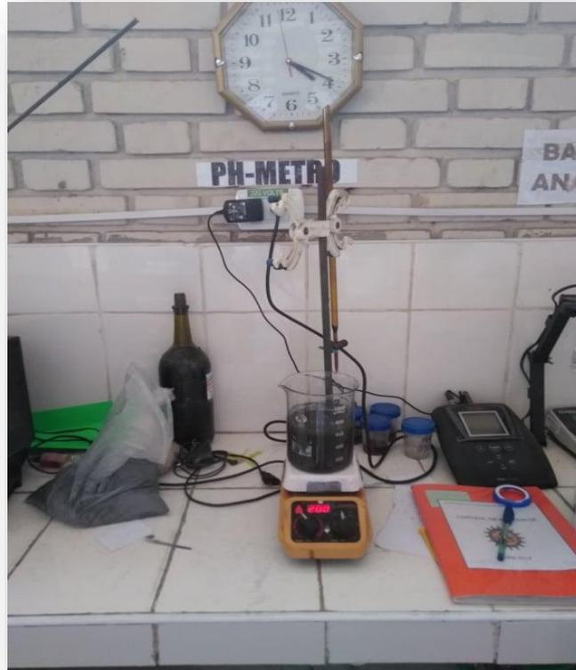
*Figura 10. Agitador termomagnético*
