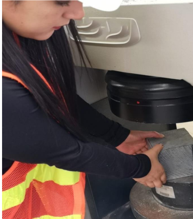
Figura A.6. Ensayo de resistencia a la compresión del mortero
