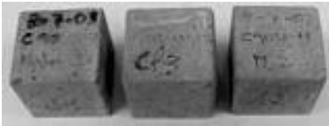
Figura A.4. Probetas de mortero cúbico.
