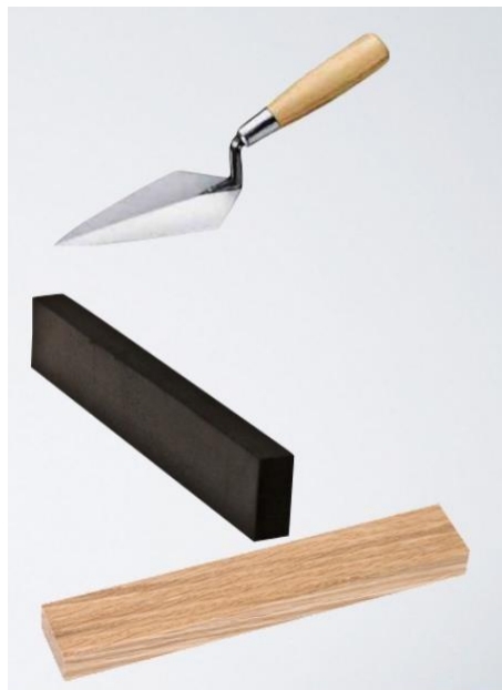
Figura A.2. Equipo para enmolado y compactado
