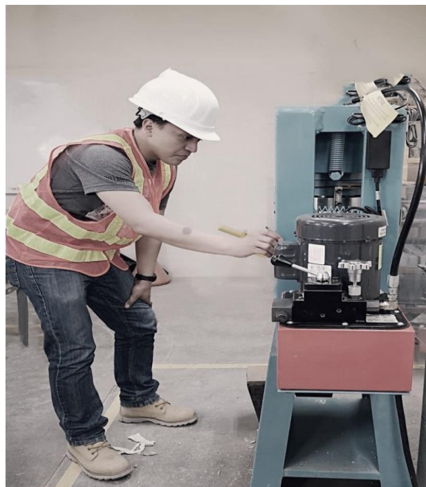
Figura A.5. Equipo prensa de compresión
