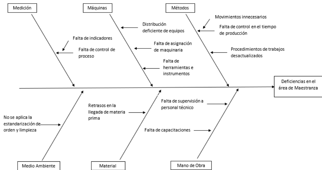
Figura 6. Diagrama Ishikawa del proceso de maestranza de la empresa IPSYCOM Ingenieros S.R.L. Fuente: elaboración propia.
