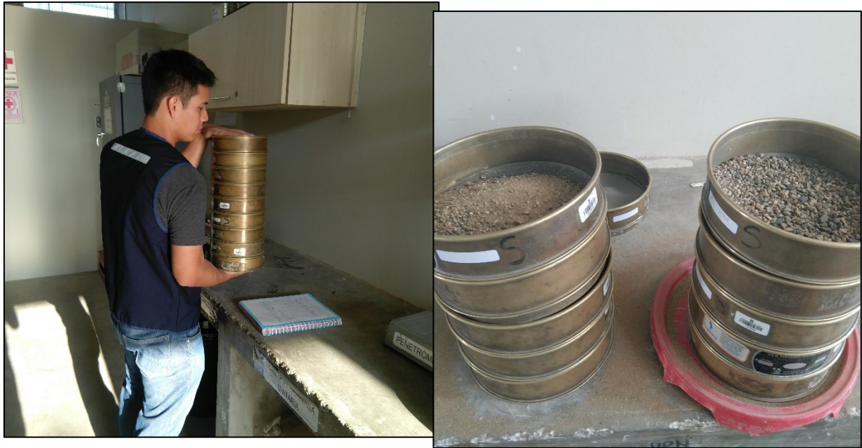
Figura 30. Determinación de la granulometría de la arena de Ottawa y mármol. Laboratorio de concreto – UPN
