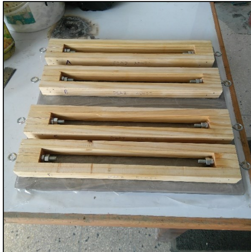
Figura 38. Moldes para el ensayo de reactividad. Laboratorio de concreto reciclado – UNT
