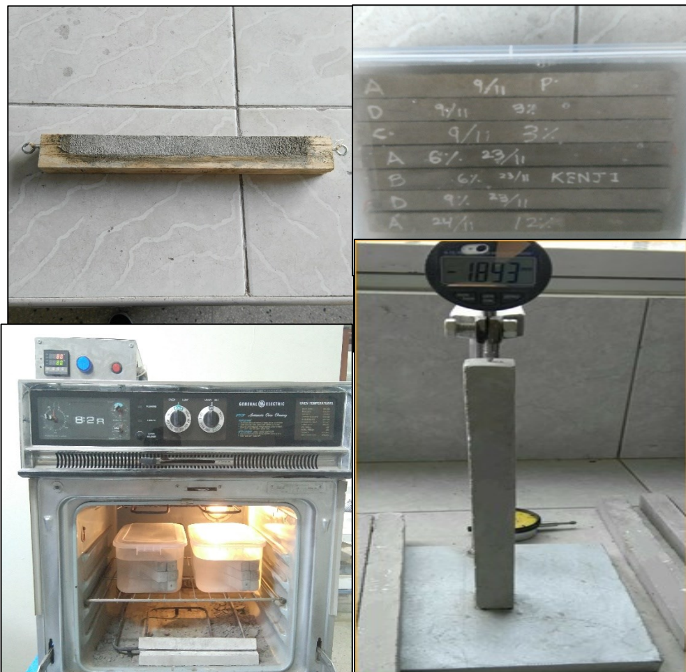
Figura 39. Ensayo de reactividad. Laboratorio de concreto reciclado – UNT
