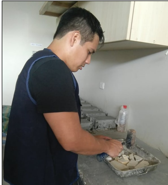
Figura 28. Trituración del mármol. Laboratorio de concreto - UPN
