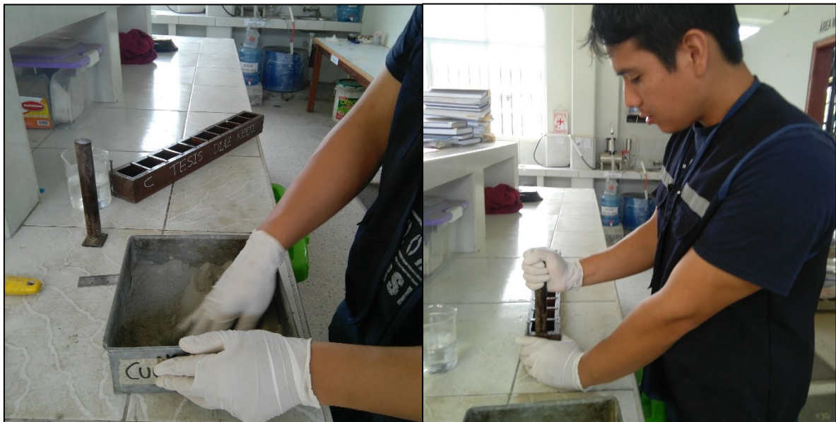
Figura 35. Conformación de probetas de mortero. Laboratorio de concreto reciclado – UNT
