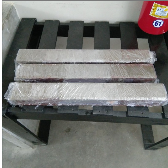
Figura 36. Probetas de mortero. Laboratorio de concreto reciclado – UNT
