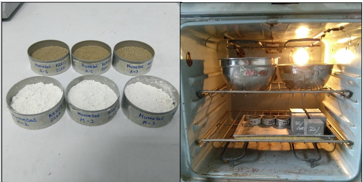
Figura 31. Determinación del contenido de humedad de la arena de Ottawa y mármol. Laboratorio de concreto reciclado – UNT
