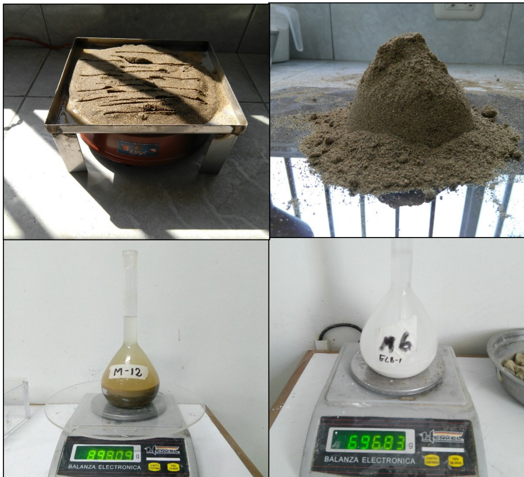
Figura 33. Determinación del peso específico y absorción de la arena de Ottawa y mármol. Laboratorio de concreto reciclado – UNT
