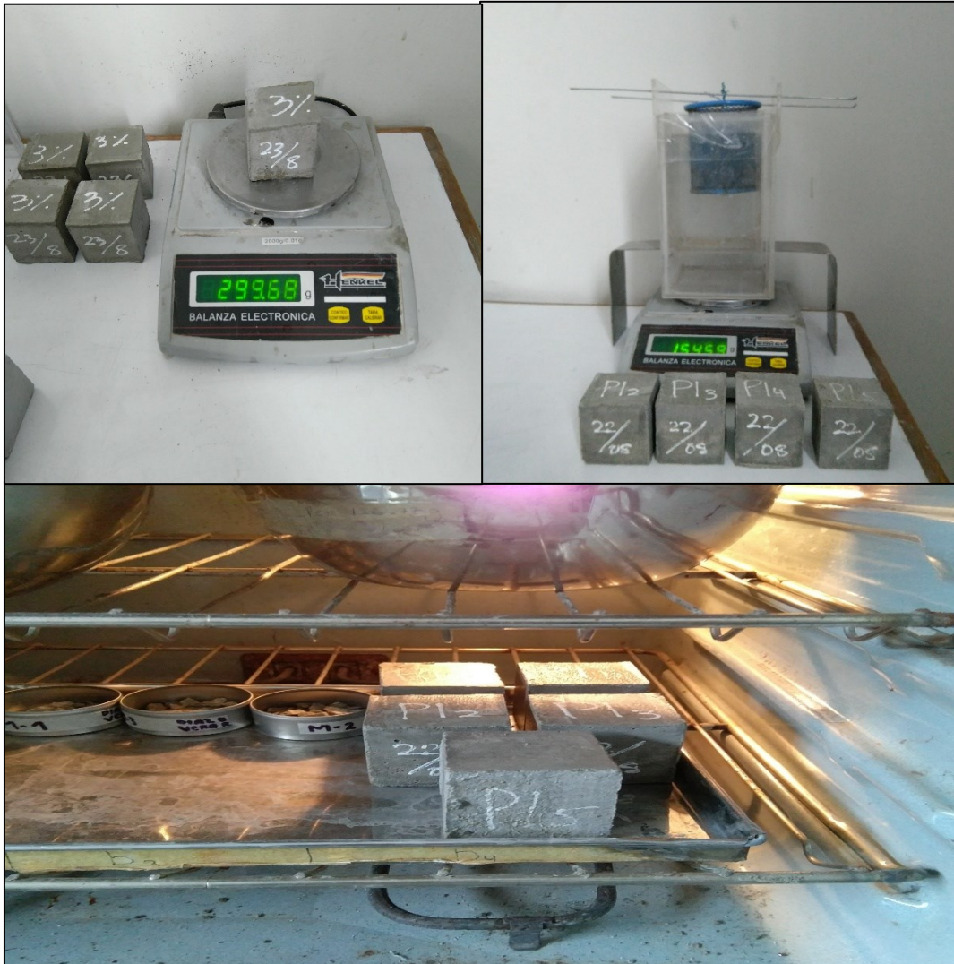
Figura 40. Ensayo de densidad de probetas de mortero. Laboratorio de concreto reciclado – UNT
