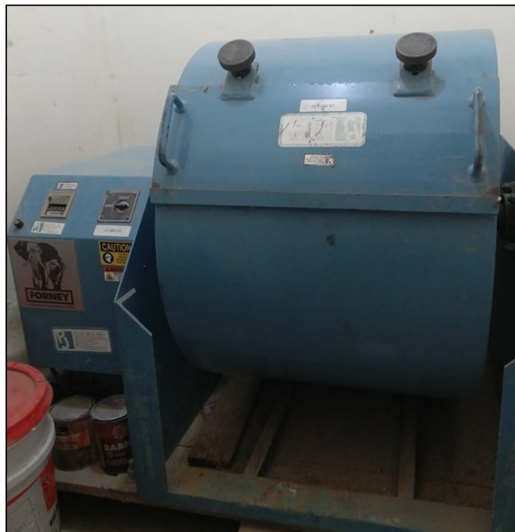
Figura 29. Chancado del mármol en la máquina los Ángeles. Laboratorio de concreto - UPN
