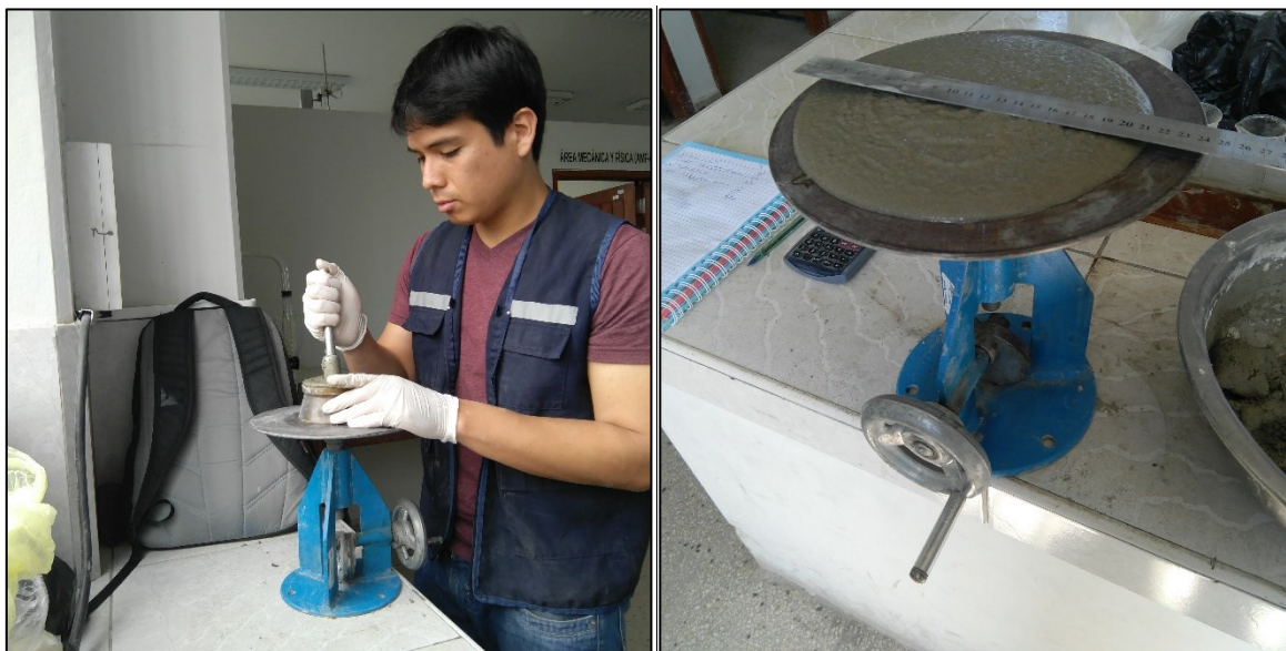
Figura 37. Ensayo de fluidez. Laboratorio de concreto reciclado – UNT
