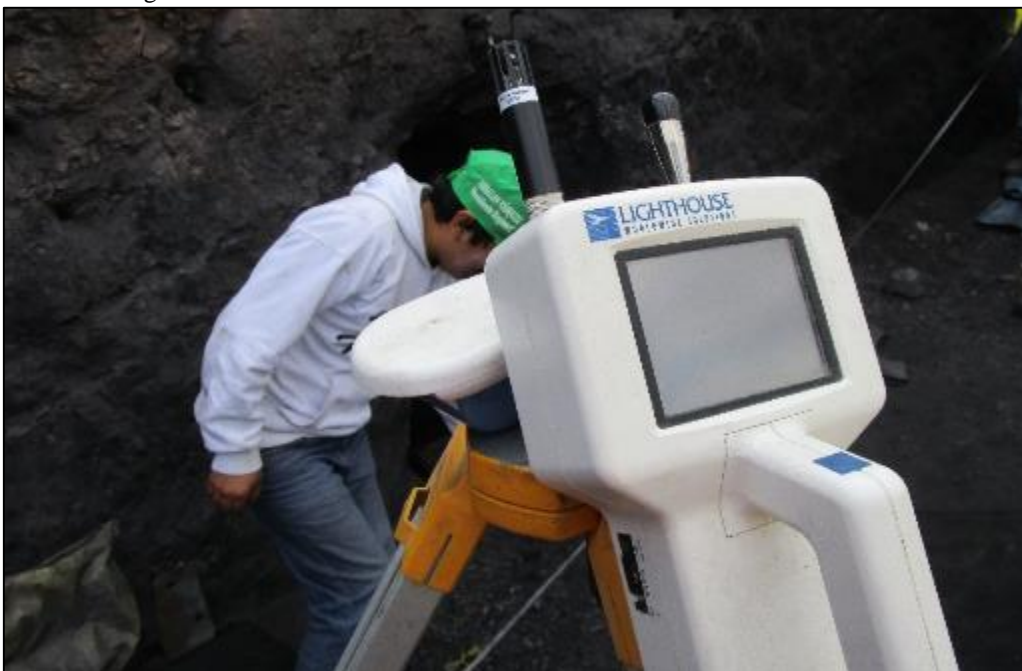
Figura 20. Medidor de gas en socavón.
