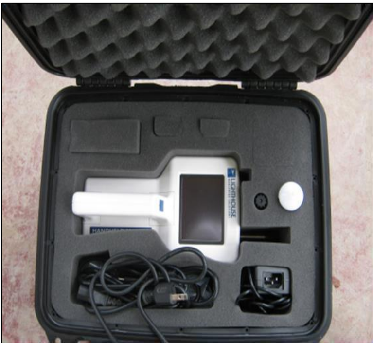
Figura 18. Medidor de Gases modelo S200 para Monóxido de carbono (CO) Dióxido de azufre(SO 2 ) y dióxido de nitrógeno(NO 2 ).
