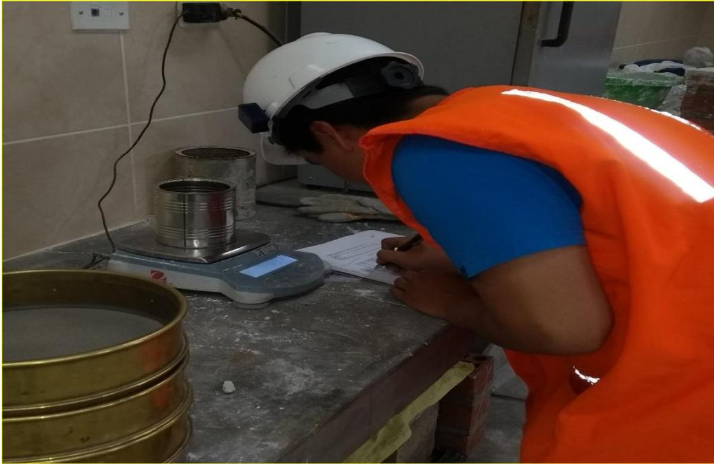
**Figura N° 11:** Tesista realizando el ensayo de límite líquido
