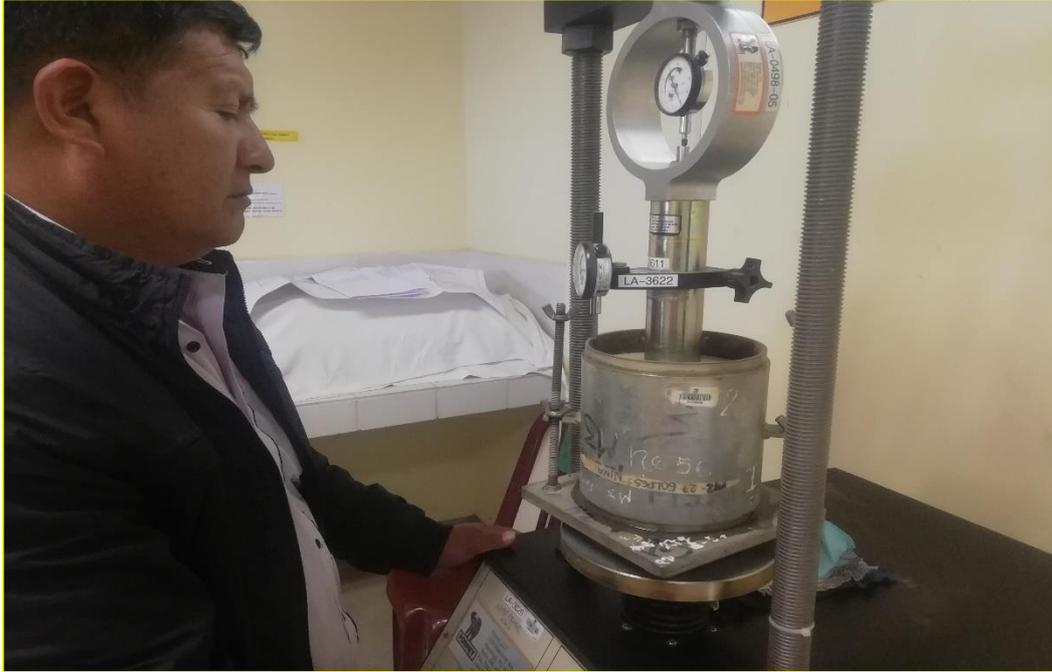
**Figura N° 23:** se observa la muestra después de realizar el ensayo de penetración
