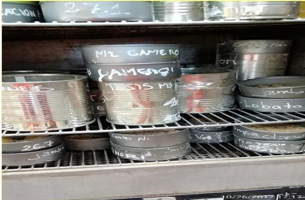
**Figura N° 8:** Determinación del peso seco del material húmedo
