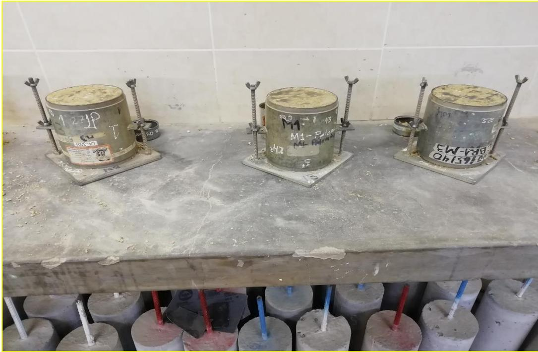
**Figura N° 19:** Se observa el peso de la muestra de ensayo de CBR con asfalto RC-250
