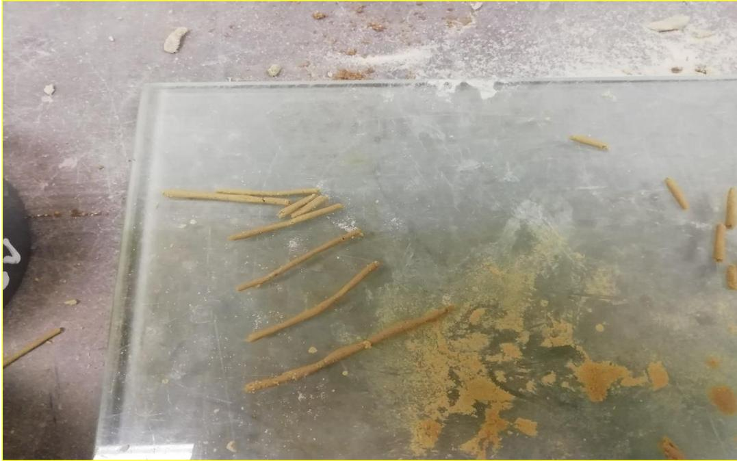
**Figura N° 13:** Peso de muestras de límite líquido y plástico
