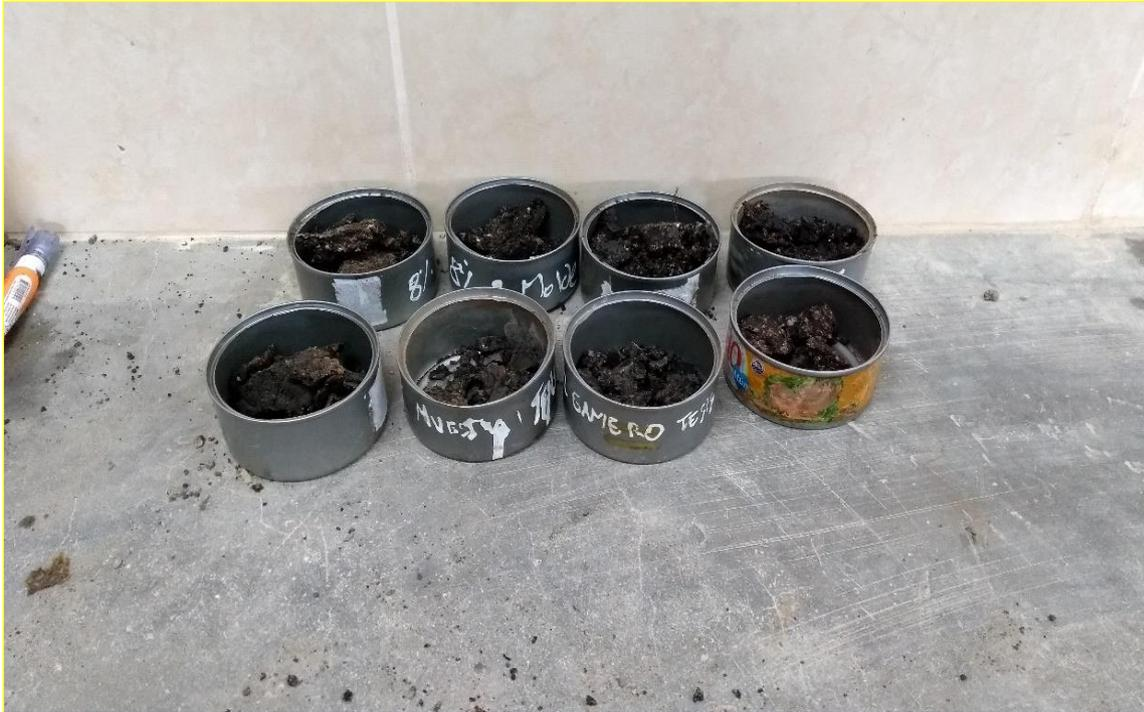
**Figura N° 20:** se observa las muestras sumergidas por 96 horas para ensayo de hinchamiento
