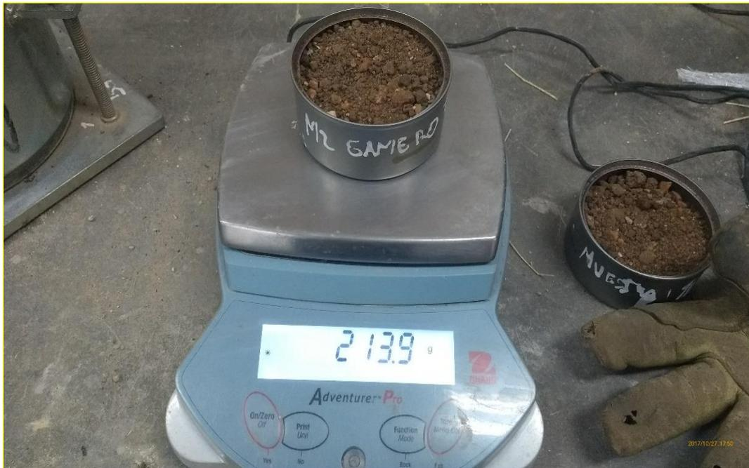
**Figura N° 9:** Tesista realizando la granulometría
