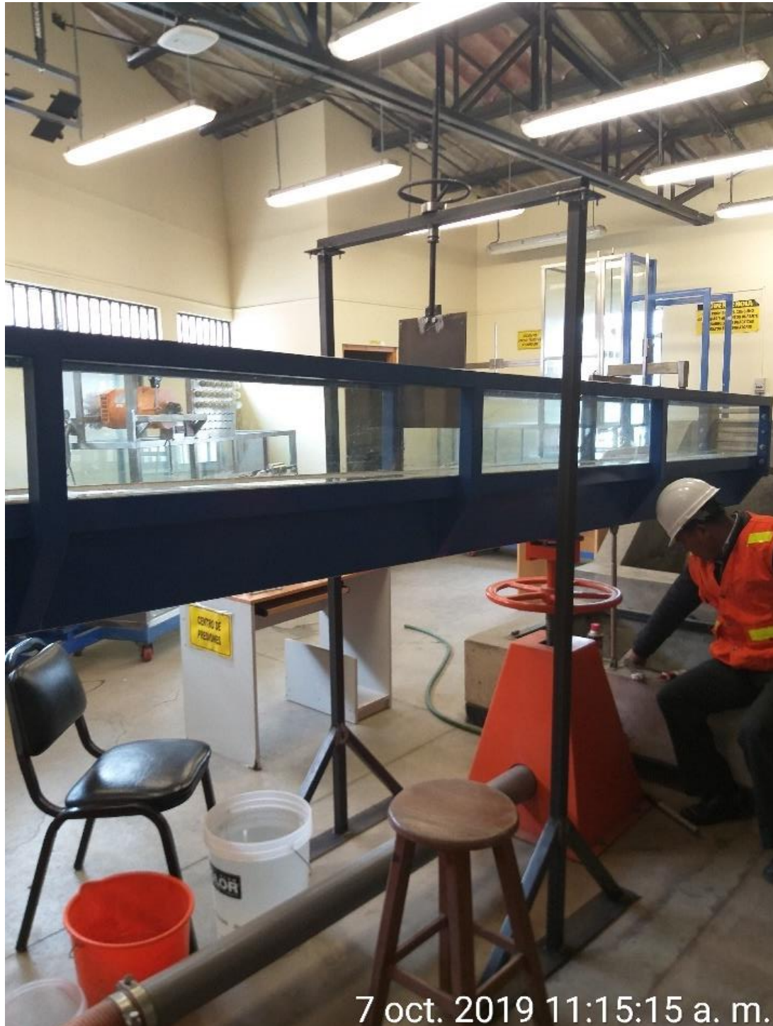
Foto N°.1: Instalación de compuerta plana rectangular deslizante.
