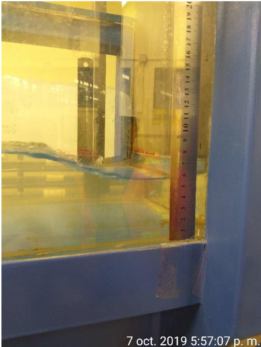
Foto N°.4: Toma de datos del Y2 (tirante que pasa por debajo de la compuerta).
