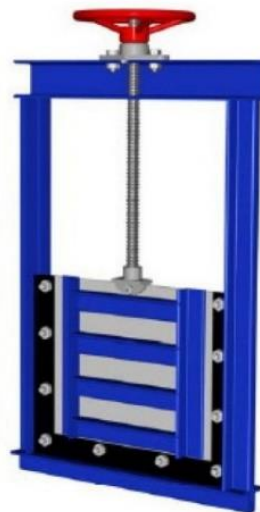
Figura N° 4: Compuerta plana rectangular deslizante
