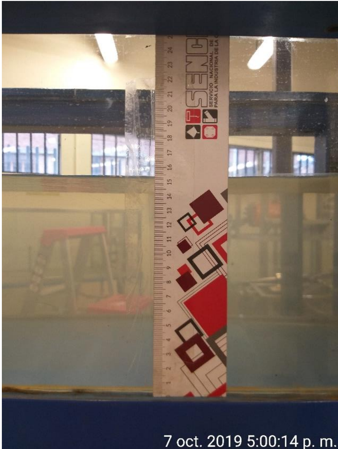
Foto N°.3: Toma de datos tirante aguas arriba.
