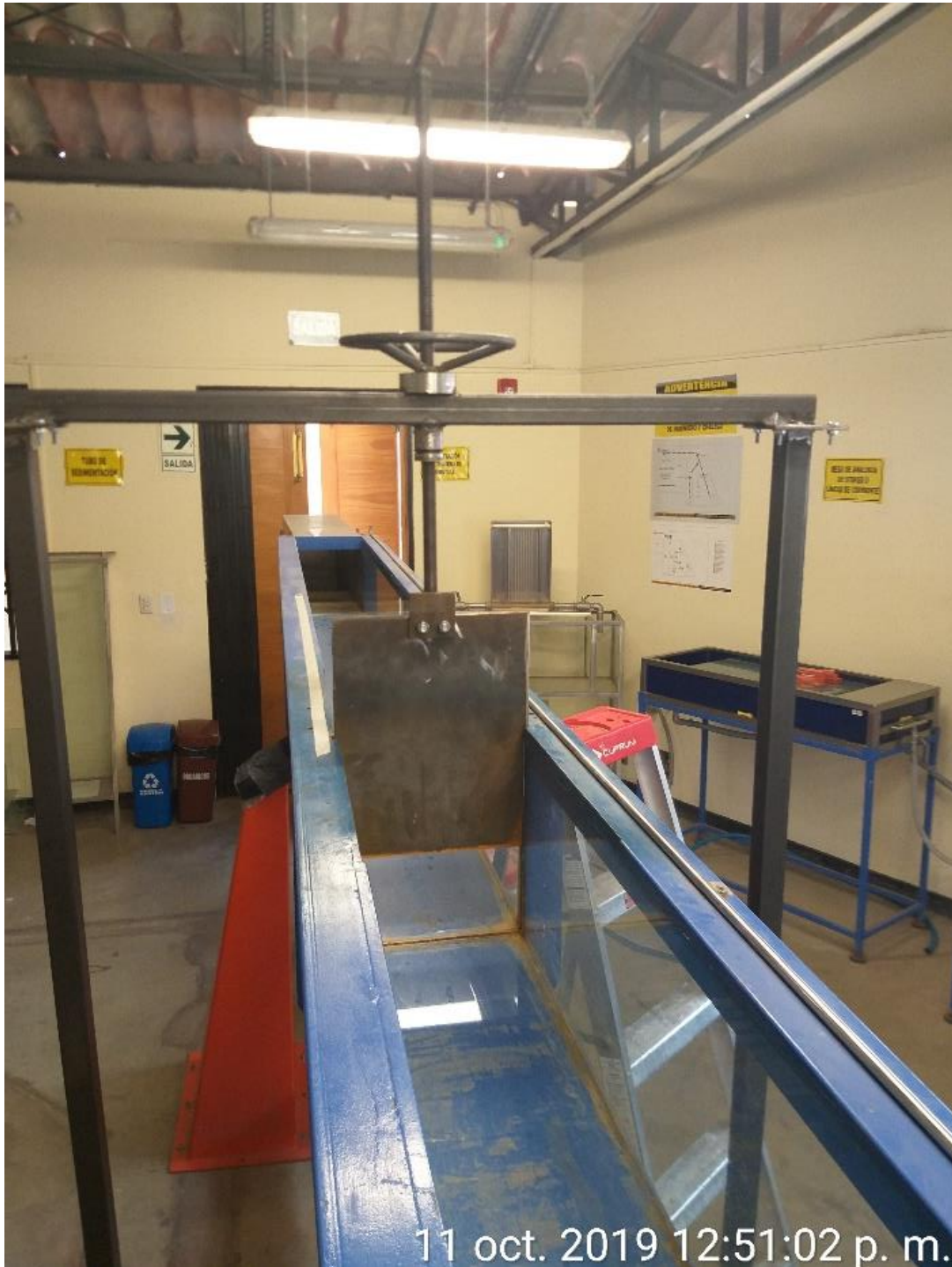
Foto N°.8: Compuerta hidráulica
