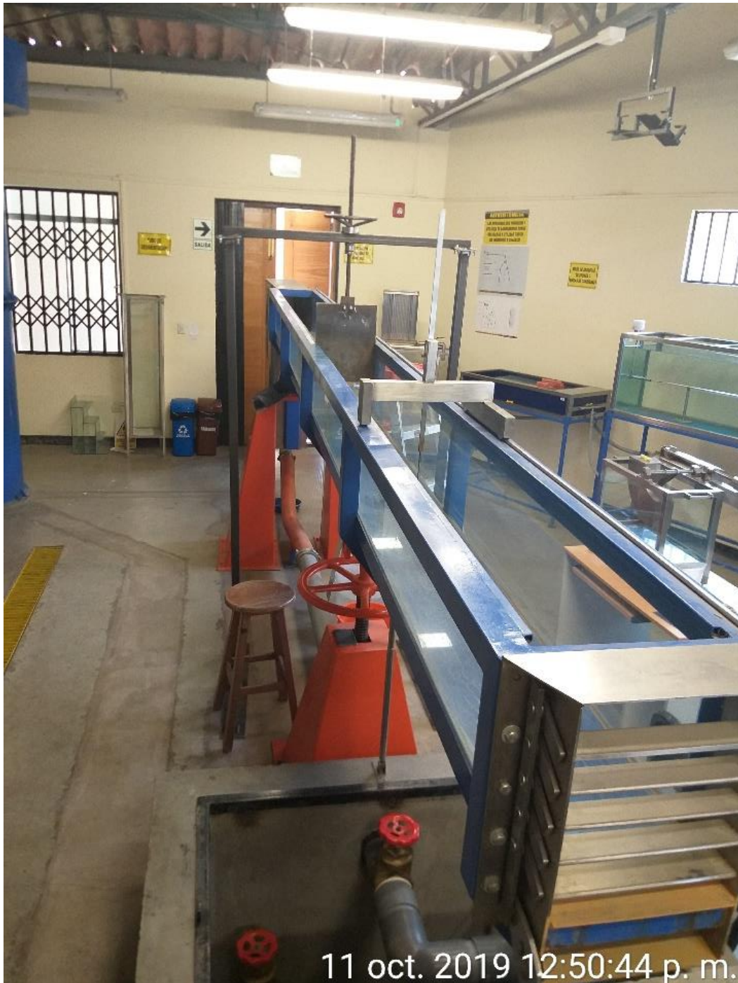
Foto N°.9: Vista general de todo el canal de pendiente variable.
