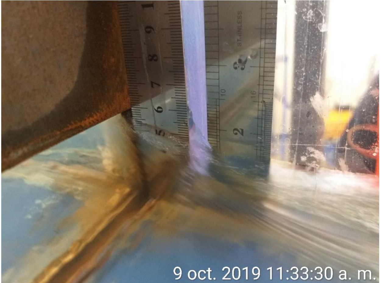
Foto N°. 7: Toma de datos de la altura de la compuerta.
