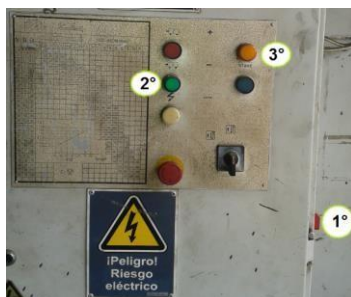
FIGURA 2: TABLERO DE MANDO DE LA PLEGADORA
