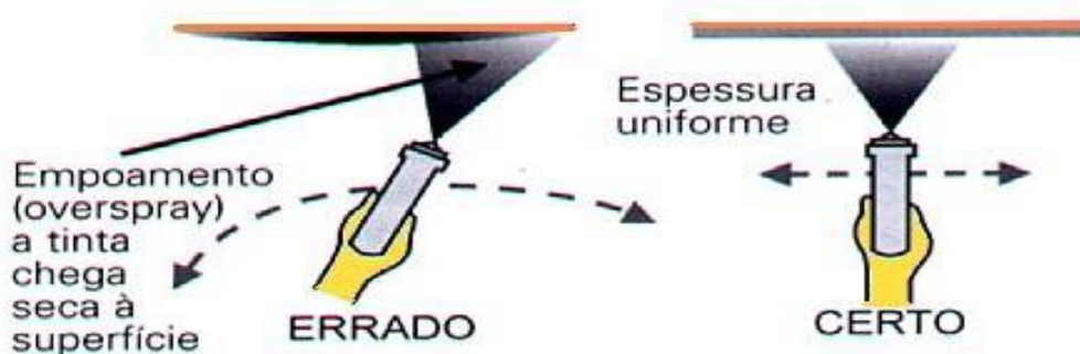
FIGURA 2: MODO DE APLICACIÓN DE PINTURA.
