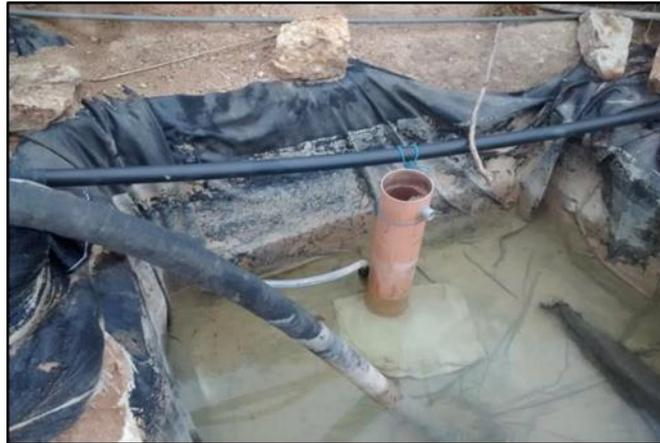
*Figura 12: Columna de Adsorción de Carbón y poza Barren*
