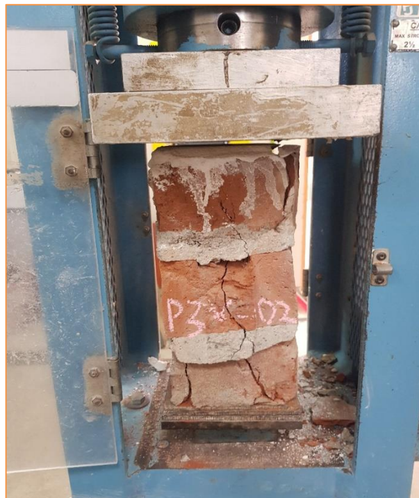
Figura 44. Pila de albañilería fallando ante carga axial.
