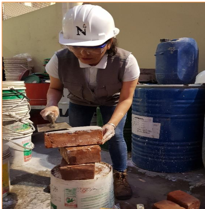
Figura 31. Refrentado o capping de las unidades de albañilería.
