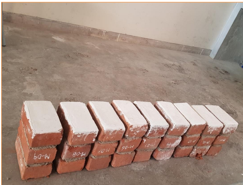
Figura 32. Pilas de albañilería refrentadas con yeso.
