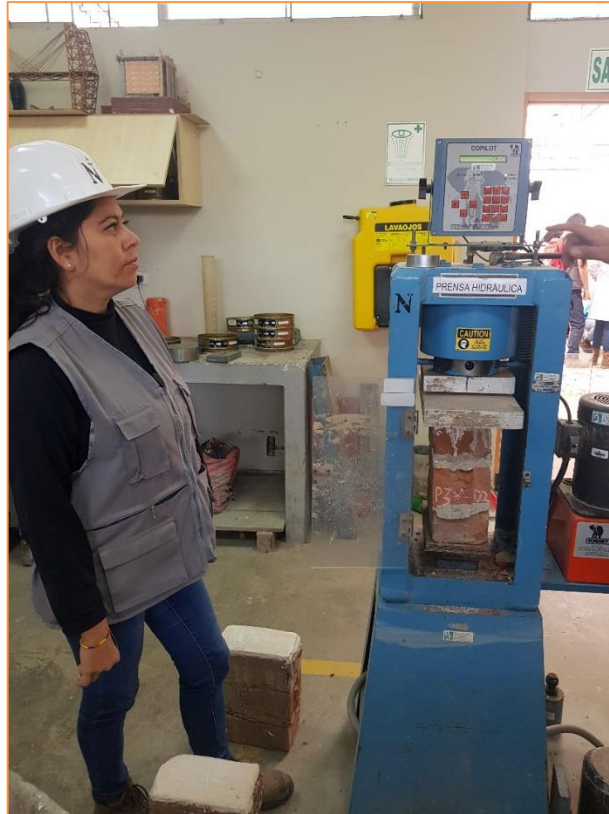
Figura 45. Ensayo de compresión de pilas de albañilería.
