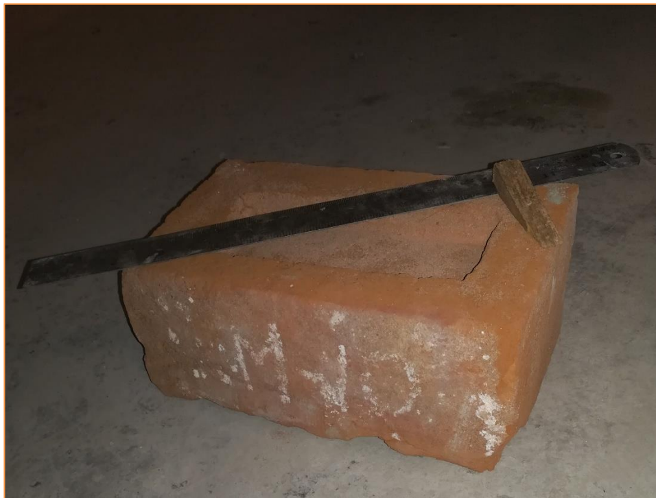
Figura 34. Ensayo de alabeo.
