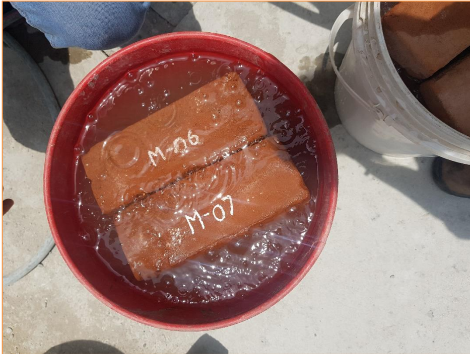
Figura 37. Ensayo de absorción – muestras 06 y 07 de la ladrillera.
