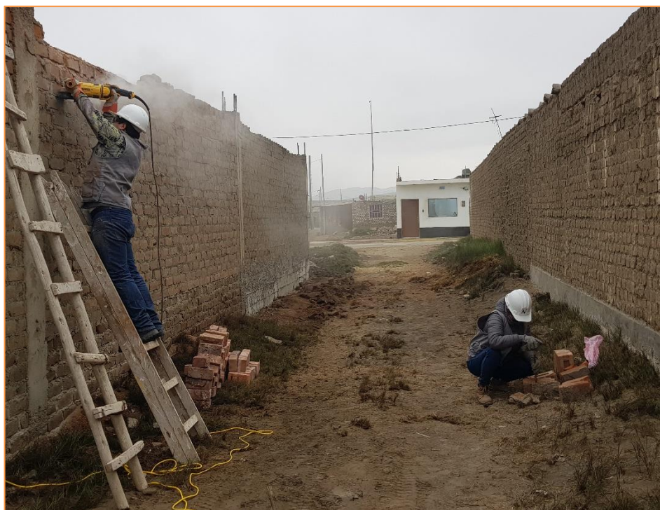
Figura 27. Corte de pilas en la Vivienda N° 03 y perfilado de las unidades extraídas.
